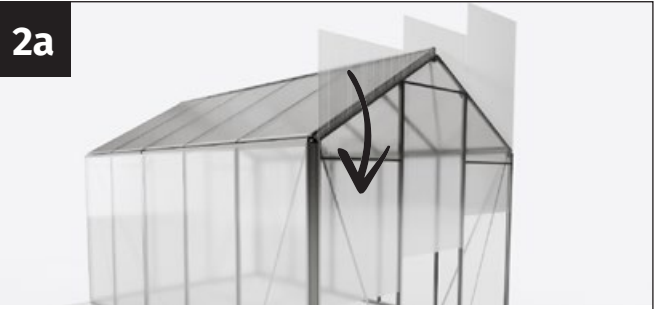
2a Sett inn dobbeltveggplater ovenfra i "U"-formen på sidehjørneprofilene og bakveggstagene. Det kan være nødvendig å løse vindavstivningen på innsiden for å justere drivhuset nøyaktig i lodd.
