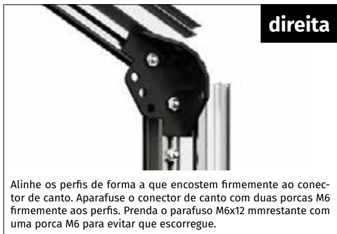
Insira dois parafusos M6x12 mm no canal de aparafusamento do perfil do canto lateral e um parafuso no canal de aparafusamento do perfil do canto do telhado.
