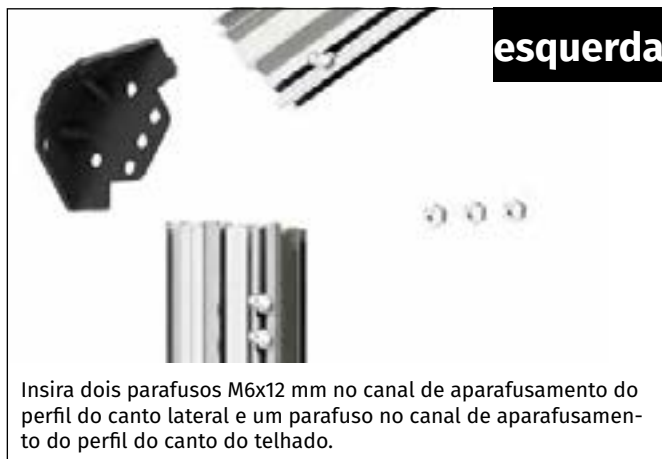
Alinhe os perfis de forma a que encostem firmemente ao conector de canto. Aparafuse o conector de canto com duas porcas M6 firmemente aos perfis. Prenda o parafuso M6x12 mm restante com uma porca M6 para evitar que escorregue.
