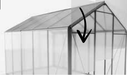
För in skivorna från ovan i det gjutna "U:et" i sidornas hörnprofiler och bakväggens stag. Det kan vara nödvändigt att lossa vindstödet igen på insidan för att rikta in växthuset exakt i lod.
