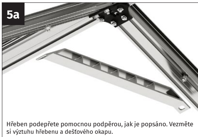
Povolte matice M6 z obou šroubů M6×12 mm, které byly dodatečně vloženy do spojovacího profilu.
