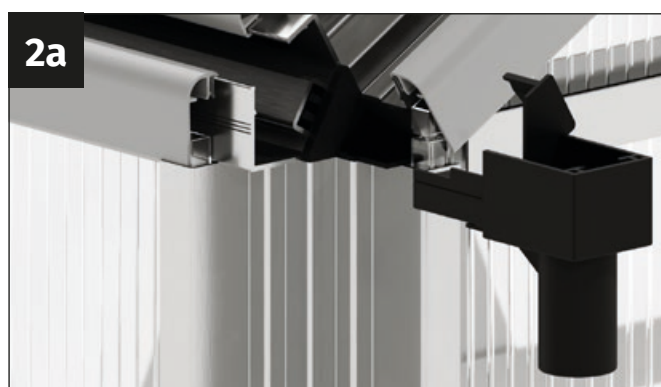
Brug de resterende afløbsdæksel, venstre og højre til de åbne ender af tagrenderne.
