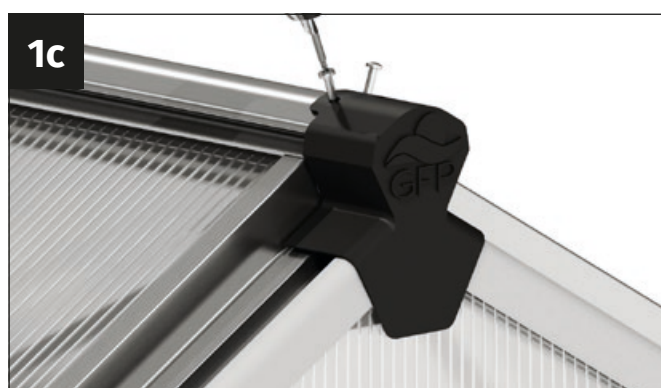
Skrue rygningdsdækslet fast på rygningdsprofilen med to 3,9x13 mm skruer. Vi anbefaler forboring!
