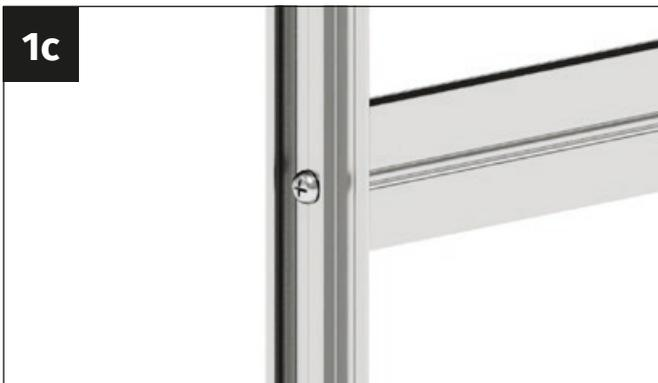
Atornilla firmemente el perfil lateral de la puerta al montante de la puerta con el tornillo autorroscante de 4,2x22 mm.
