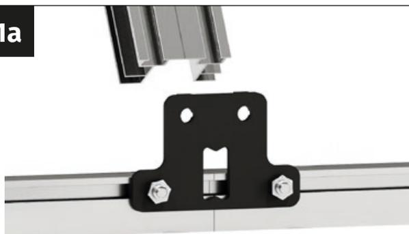
Toma el perfil de acoplamiento del panel lateral, así como dos tornillos M6x12 mm y dos tuercas M6.
