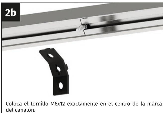
Coloca el tornillo M6x12 exactamente en el centro de la marca del canalón.
