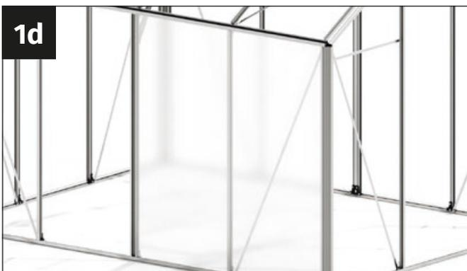
Instala la placa de la siguiente sección de la pared lateral.
