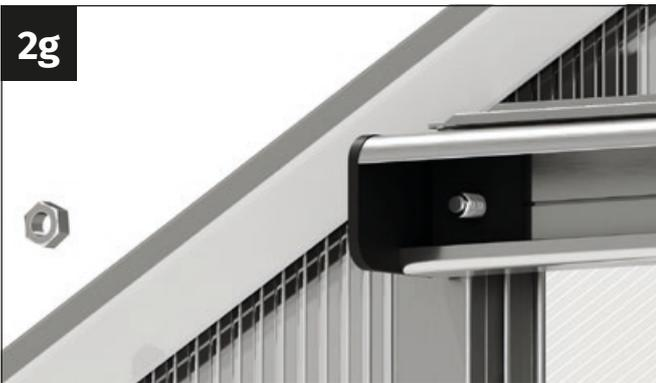
Introduce el tornillo M6x12 mm por detrás a través del orificio de la guía de la puerta y de la protección de la guía de la puerta.
