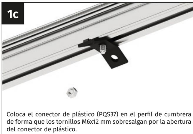
Coloca el conector de plástico (PQS37) en el perfil de cumbreira de forma que los tornillos M6x12 mm sobresalgan por la abertura del conector de plástico.
