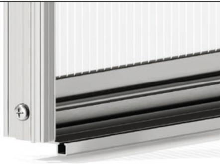
Atornilla firmemente el perfil de la puerta lateral al perfil del piso inferior con el tornillo autorroscante de 4,2 x 22 mm.
