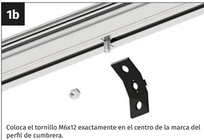
Coloca el tornillo M6x12 exactamente en el centro de la marca del perfil de cumbreira.
