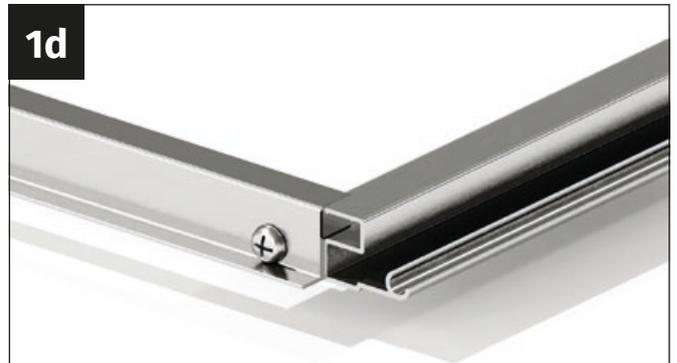
Atornilla las dos piezas con el tornillo autorroscante de 4,2x22 mm.
