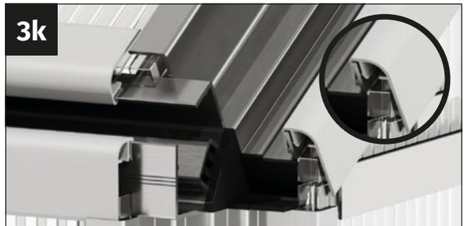
Coge dos clips de plástico y córtalos a la longitud del perfil de techo angular. Coloca los clips en el perfil de techo angular. Asegúrate de que estén bien sujetas en toda su longitud.
