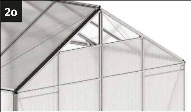
Inserta las placas del hastial en las dos secciones exteriores de la pared trasera.
