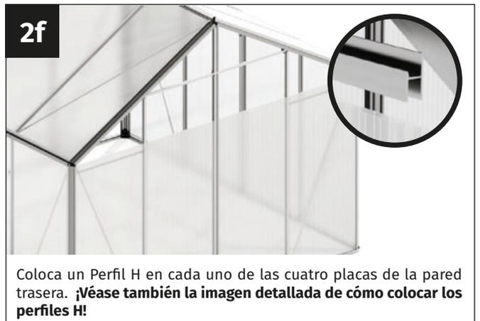
Coloca un Perfil H en cada uno de las cuatro placas de la pared trasera. **¡Véase también la imagen detallada de cómo colocar los perfiles H!**
