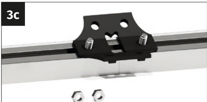
Junte los dos canalones de lluvia. Coloque el conector de plástico (PQS33) en los vierteaguas de forma que los dos tornillos M6x12 mm sobresalgan por las aberturas del conector de plástico.
