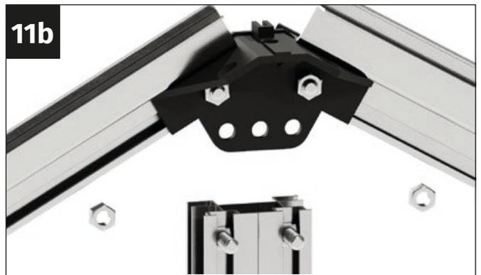
Introduce un tornillo M6x12 mm en cada uno de los dos canales para tornillos del soporte del frontón.
