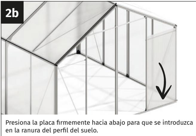
Presiona la placa firmemente hacia abajo para que se introduzca en la ranura del perfil del suelo.
