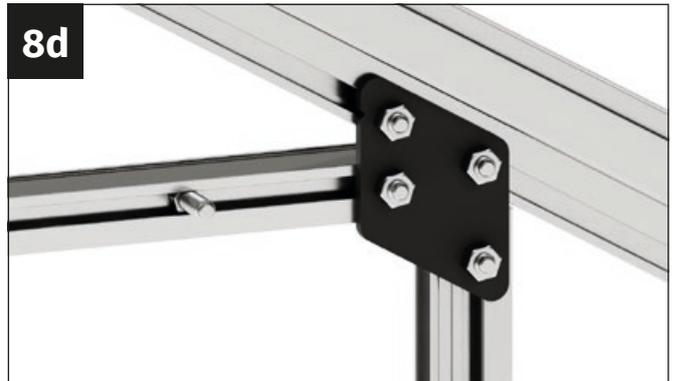
Fija los refuerzos transversales al conector de plástico con una tuerca M6.
