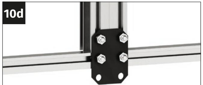
Alinee el soporte del frontón exactamente en el centro de los Refuerzos transversales y atornille firmemente el nudo conector al soporte del frontón y a los Refuerzos transversales.
