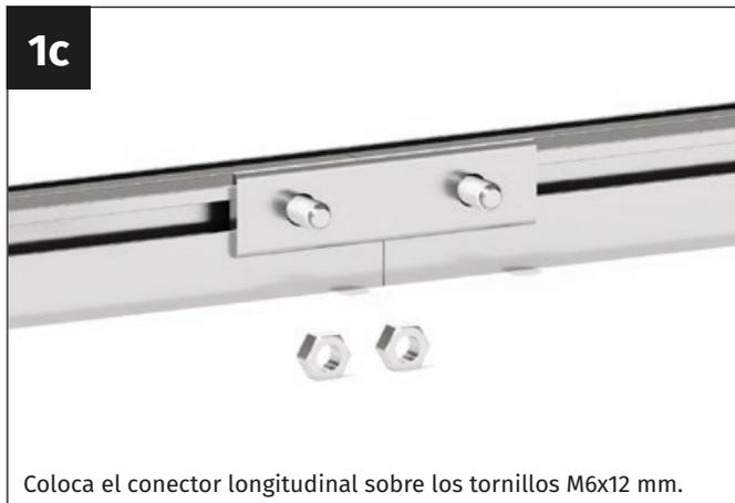
Coloca el conector longitudinal sobre los tornillos M6x12 mm.
