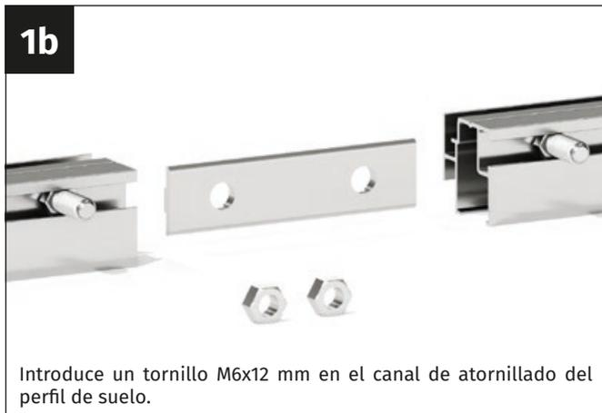
Introduce un tornillo M6x12 mm en el canal de atornillado del perfil de suelo.
