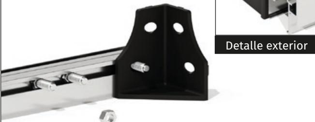
Coloque el nudo de suelo de forma que sobresalga un tornillo M6x12 por el orificio previsto. Asegúrate de que la parte exterior del perfil coincida con la esquina del conector.
