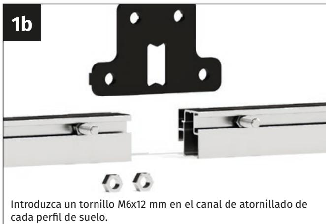
Introduzca un tornillo M6x12 mm en el canal de atornillado de cada perfil de suelo.
