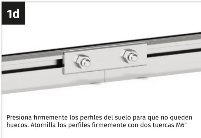
Presiona firmemente los perfiles del suelo para que no queden huecos. Atornilla los perfiles firmemente con dos tuercas M6"
