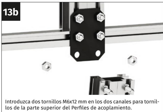
Introduzca dos tornillos M6x12 mm en los dos canales para tornillos de la parte superior del Perfiles de acoplamiento.
