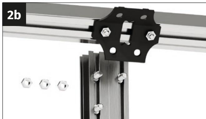
Introduce dos tornillos M6x12 mm en el canal de atornillado izquierdo y un tornillo en el canal de atornillado derecho del perfil de acoplamiento.
