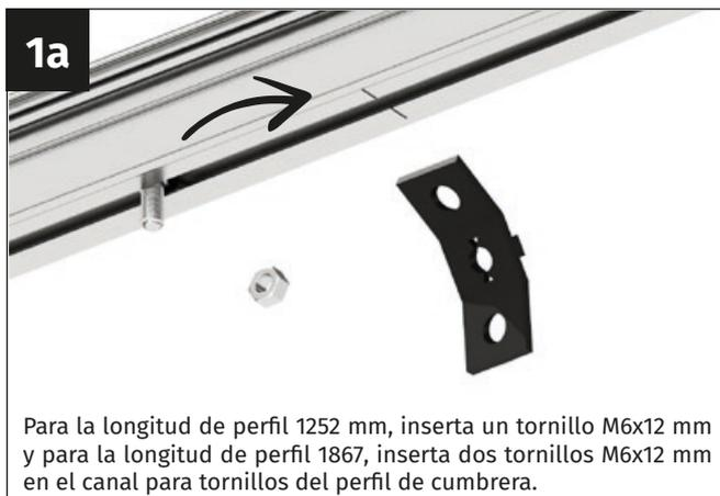
Para la longitud de perfil 1252 mm, inserta un tornillo M6x12 mm y para la longitud de perfil 1867, inserta dos tornillos M6x12 mm en el canal para tornillos del perfil de cumbreira.
