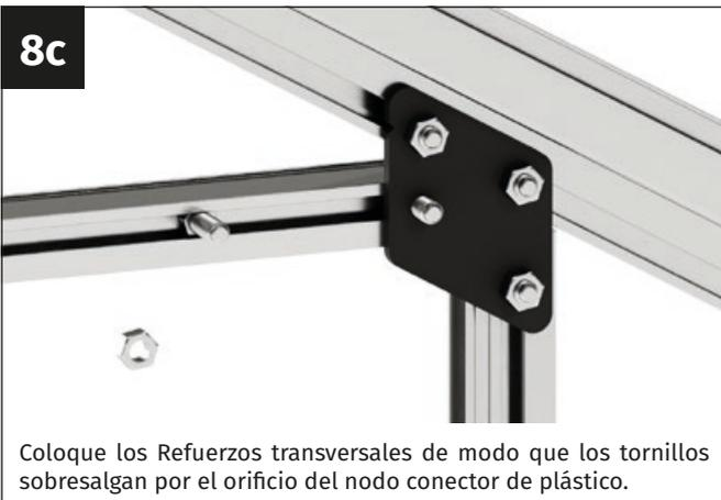
Coloque los Refuerzos transversales de modo que los tornillos sobresalgan por el orificio del nodo conector de plástico.
