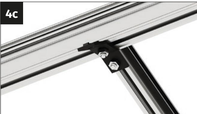
Atornilla firmemente el puntal al conector de plástico con una tuerca M6.
