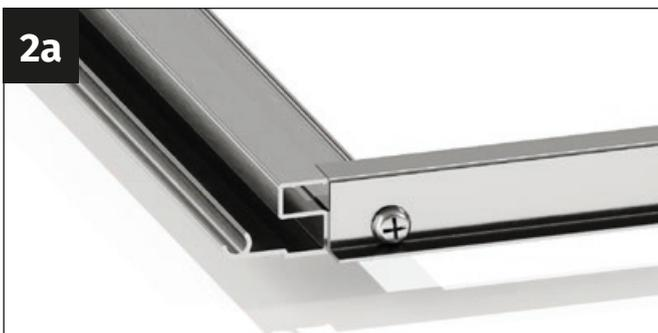
Fija el segundo perfil lateral de la ventana al segundo lado del perfil de la bisagra y atorníllalo con un tornillo autorroscante de 4,2x22 mm.
