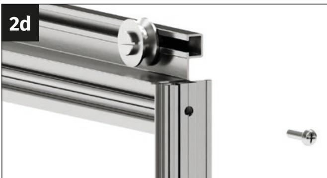
Coloca el perfil de rodillo de la puerta en el perfil lateral de la puerta de forma que el orificio perforado superior quede exactamente encima del cono de tornillo del perfil de rodillo de la puerta.
