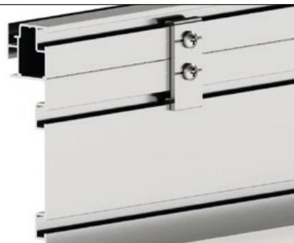
Conecta el gancho de cimentación atornillando los tornillos autrotoroscantes de 4,8x13 mm. El perfil de suelo con la longitud 1867 también está atornillado en el centro.
