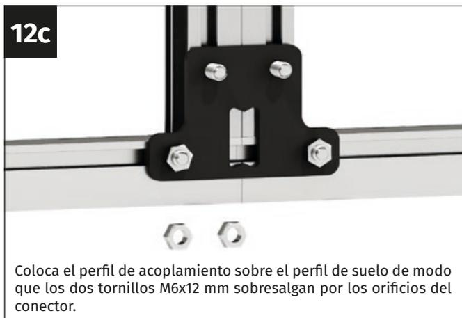
Coloca el perfil de acoplamiento sobre el perfil de suelo de modo que los dos tornillos M6x12 mm sobresalgan por los orificios del conector.
