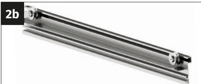
Inserta la tuerca en el canal del tornillo del perfil del rodillo de la puerta. Inserta el perno axial en el rodillo de la puerta. **Recomendamos colocar el rodillo de la puerta a unos 30 mm del extremo del perfil del rodillo de la puerta y no apretarlo en exceso (debe poder girar).** Repite el proceso en el segundo lado del perfil del rodillo de la puerta.
