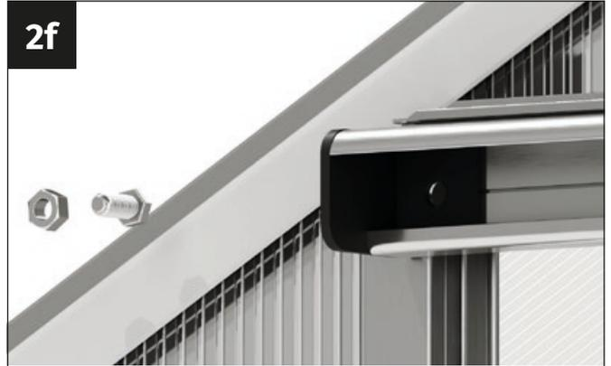
Fija la protección de la guía de la puerta al perfil del guía de la puerta.
