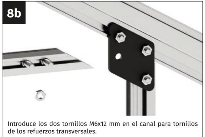
Introduce los dos tornillos M6x12 mm en el canal para tornillos de los refuerzos transversales.
