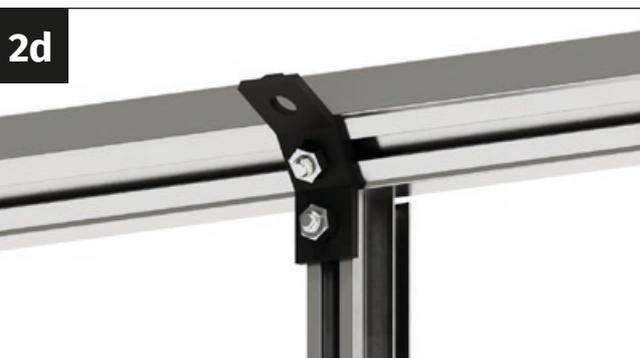
Atornilla firmemente el puntal al conector de plástico con una tuerca M6.
