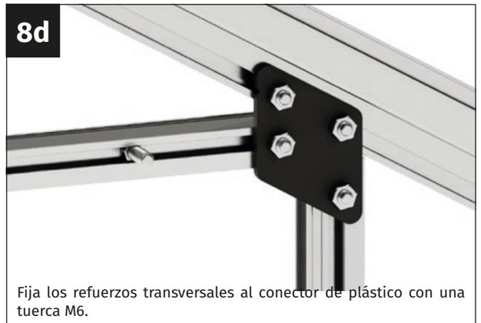
Fija los refuerzos transversales al conector de plástico con una tuerca M6.
