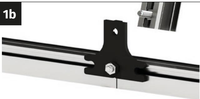
Introduce el tornillo M6x12 mm de la parte inferior en el canal para tornillos del puntal.
