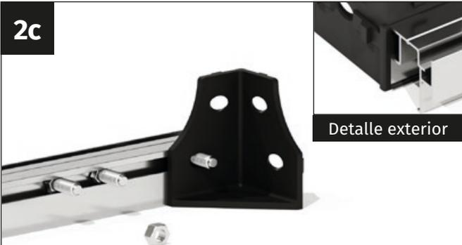
Coloque el nudo de suelo de forma que sobresalga un tornillo M6x12 por el orificio previsto. Asegúrate de que la parte exterior del perfil coincida con la esquina del conector.
