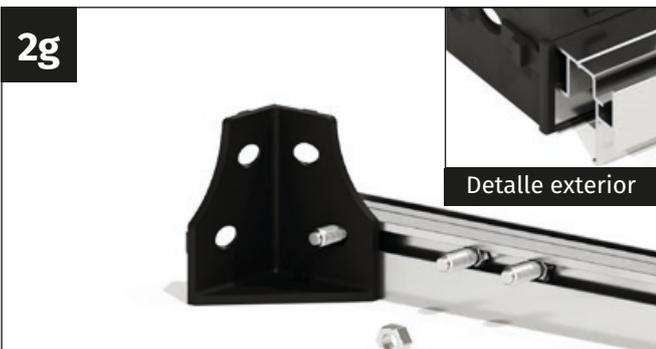
Coloca el nudo de suelo de forma que sobresalga un tornillo M6x12 por el orificio previsto. Asegúrate de que la parte exterior del perfil coincida con la esquina del conector.
