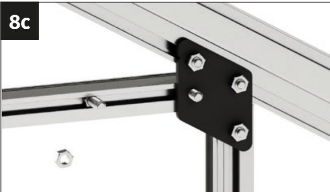
Introduce los dos tornillos M6x12 mm en el canal para tornillos de los refuerzos transversales.
