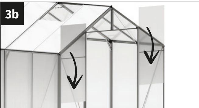
Toma las dos placas de la pared frontal y deslízalos desde arriba en las ranuras del perfil lateral angular y del perfil de la entrada de la puerta
