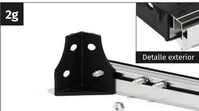
Coloca el nudo de suelo de forma que sobresalga un tornillo M6x12 por el orificio previsto. Asegúrate de que la parte exterior del perfil coincida con la esquina del conector.
