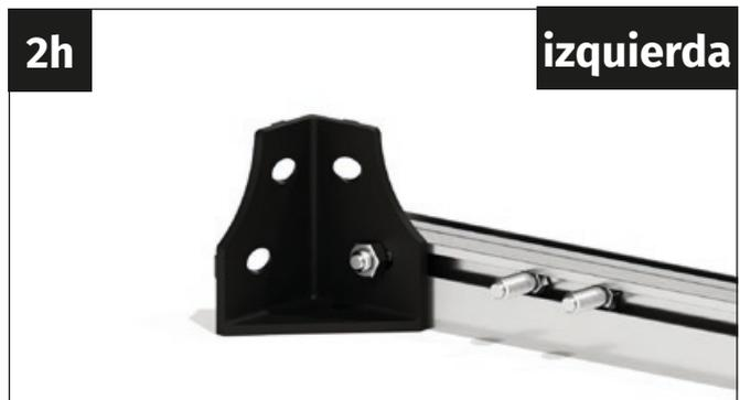
Atornilla firmemente el conector de suelo al perfil de suelo con una tuerca M6.
