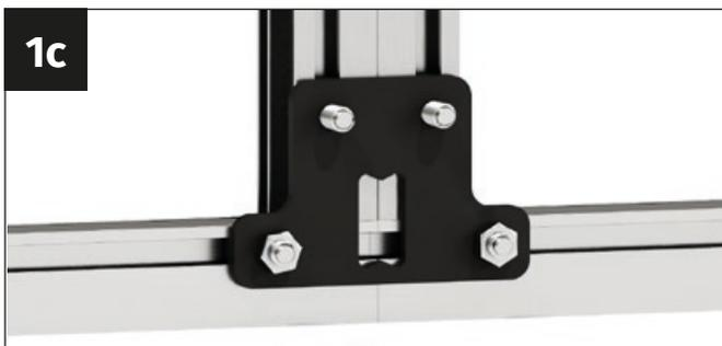
Coloca el perfil de acoplamiento sobre el perfil de suelo de modo que los dos tornillos M6x12 mm sobresalgan por los orificios del conector.
