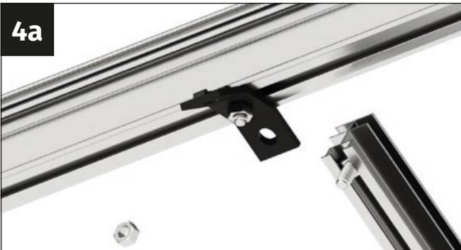
Coge un tornillo M6x12 mm y una tuerca M6. Introduce el tornillo M6x12 mm de la parte superior en el canal para tornillos del puntal de techo.
