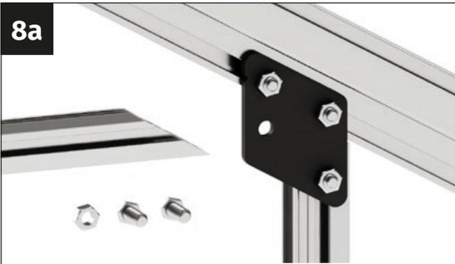
Coge los refuerzos transversales, dos tornillos M6x12 mm y dos tuercas M6.
