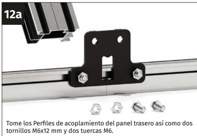
Tome los Perfiles de acoplamiento del panel trasero así como dos tornillos M6x12 mm y dos tuercas M6.
