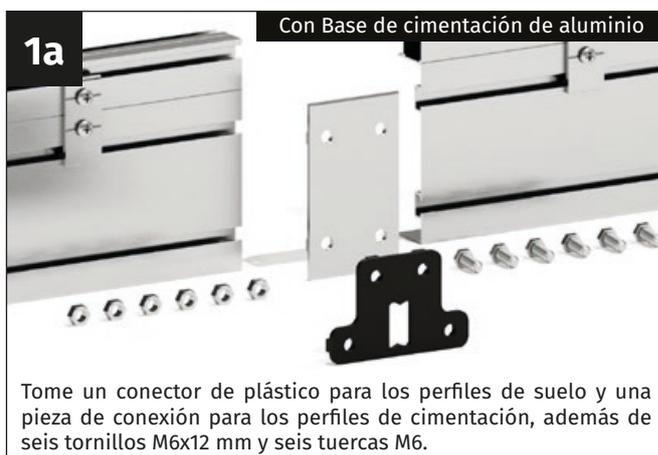
Tome un conector de plástico para los perfiles de suelo y una pieza de conexión para los perfiles de cimentación, además de seis tornillos M6x12 mm y seis tuercas M6.
