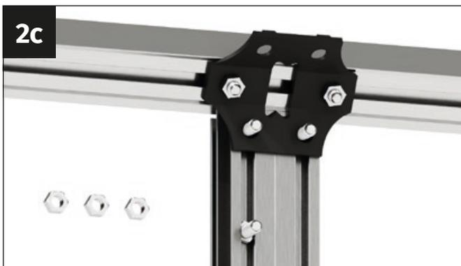
Inserta el perfil de acoplamiento de modo que los dos tornillos M6x12 mm sobresalgan por los orificios del conector.
