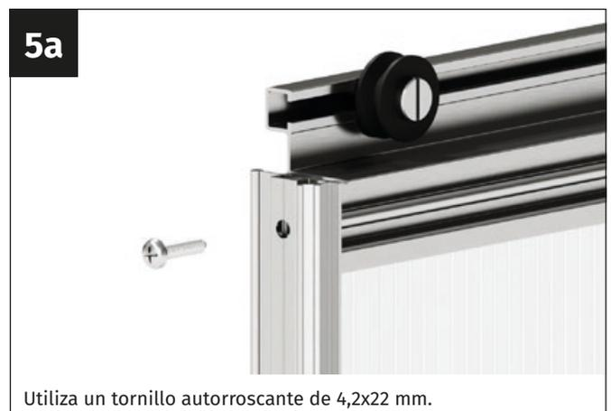
Utiliza un tornillo autorroscante de 4,2x22 mm.
