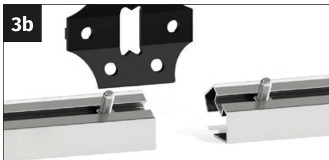
Introduzca un tornillo M6x12 mm en el canal para tornillos de cada pieza del vierteaguas.
