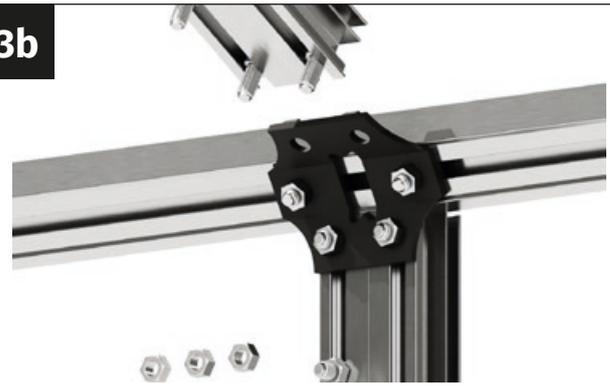
Introduce dos tornillos M6x12 mm en el canal de atornillado izquierdo y un tornillo en el canal de atornillado derecho del perfil de acoplamiento.
