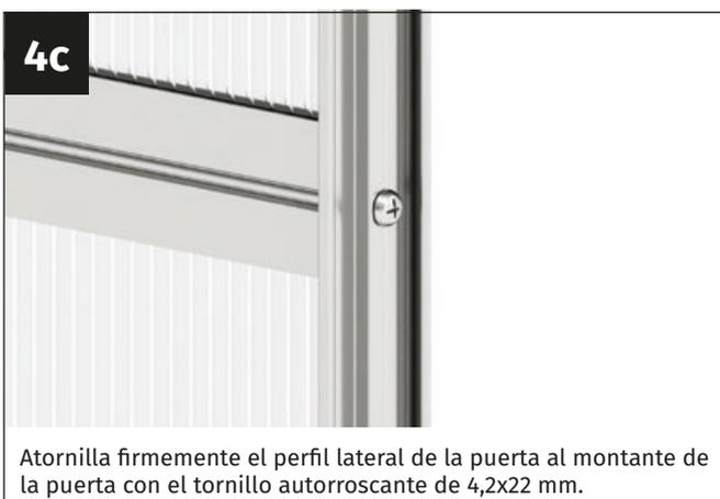
Atornilla firmemente el perfil lateral de la puerta al montante de la puerta con el tornillo autorroscante de 4,2x22 mm.
