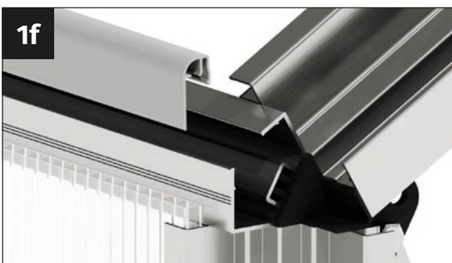
Engancha la placa en el perfil vertical del canalón.
