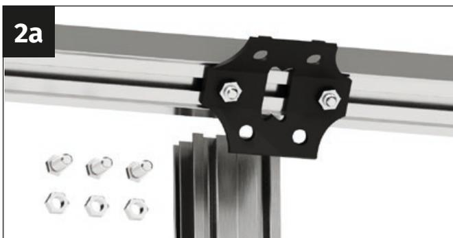
**ATENCIÓN:** Necesitarás tres tornillos M6x12 mm y tres tuercas M6 en la parte superior del perfil de acoplamiento.
