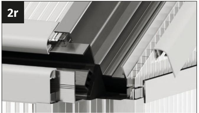
Coge dos clips de plástico y córtalos a la longitud del perfil de techo angular.
