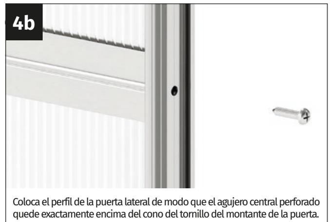
Coloca el perfil de la puerta lateral de modo que el agujero central perforado quede exactamente encima del cono del tornillo del montante de la puerta.
