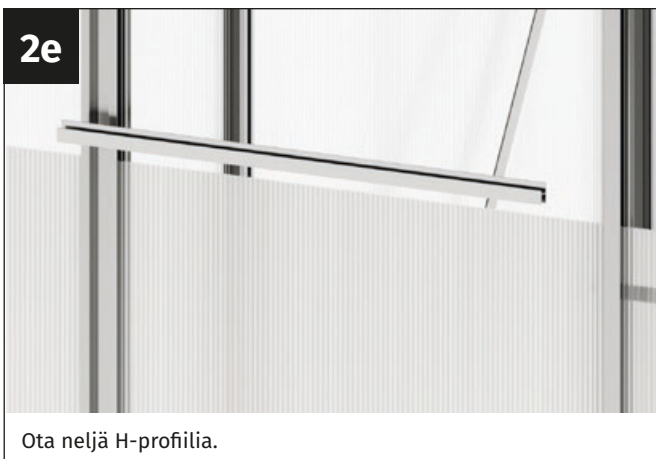
Aseta kaksi keskipaneelia ylhäältäpäin sivukulmaprofilien ja takaseinän tukijalkojen U-muotoisiin kohtiin. Paina neljää monilevypaneelia tiukasti alaspäin niin, että paneelit painuvat lattiaprofilin uraan.
