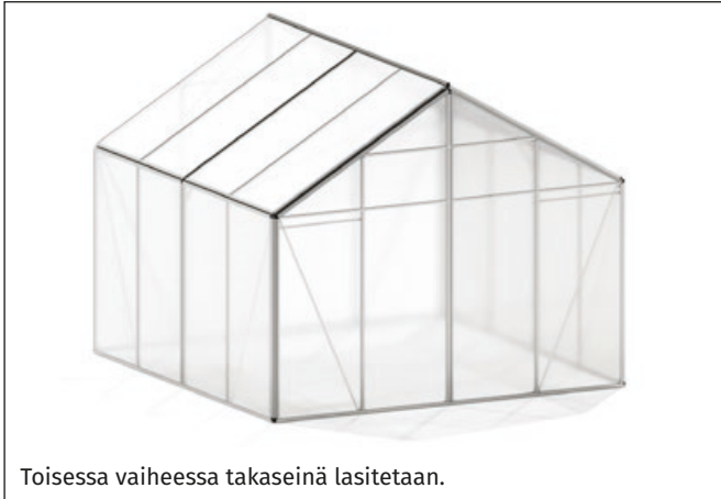
Työnnä ylhäältä päin olevat monilevyt sivukulmaprofilien ja takaseinän jousien U-kirjaimiin. Tuulijousitusta voi olla tarpeen löysätä uudelleen sisäpuoleltak asvihuoneen kohdistamiseksi täsmälleen kohtisuoraan.
