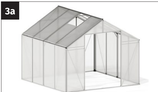
I tredje trinn glaseres frontveggen.
