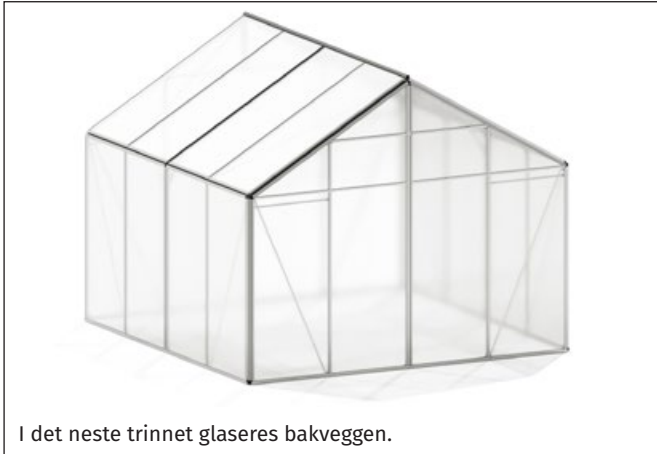
Sett inn dobbeltveggplater ovenfra i "U"-en på sidehjørneprofilene og bakveggstagene. Det kan være nødvendig å løsne vindstivningen på innsiden for å justere drivhuset nøyaktig i lodd.
