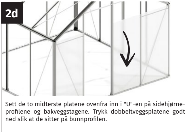
Press dobbeltveggplaten godt ned slik at platen skyves inn i bunnprofilen.
