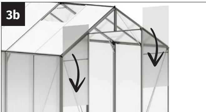
Bruk to dobbeltveggsplater på frontveggen og skyv dem inn i sidehjørneprofilen og dørinngangsprofilen ovenfra
