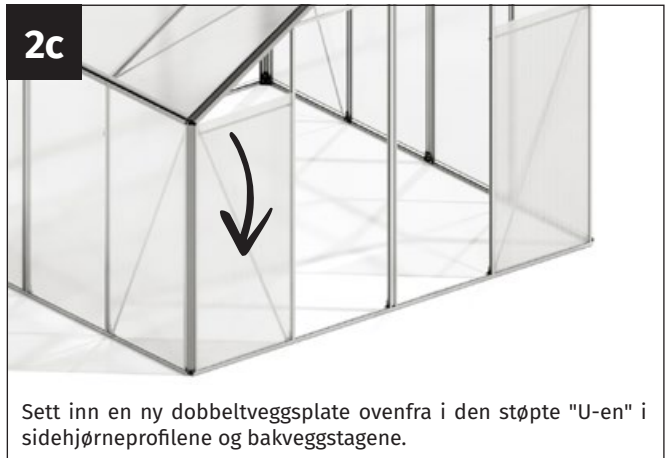
Press dobbeltveggplaten godt ned slik at platen skyves inn i bunnprofilen.
