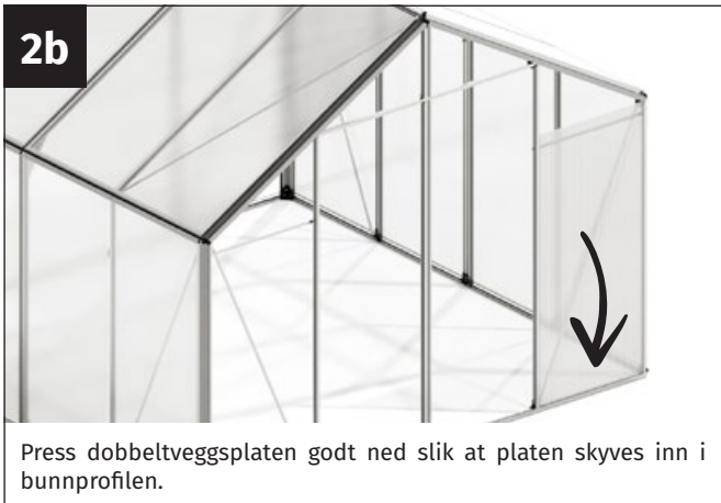
I det neste trinnet glaseres bakveggen.
