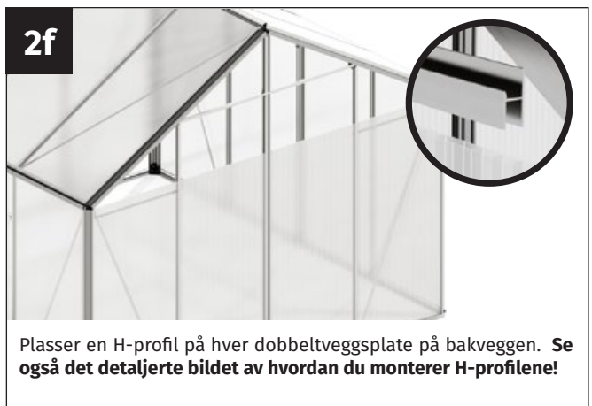
Detalj: Dobbeltveggplate i bunnprofilen
