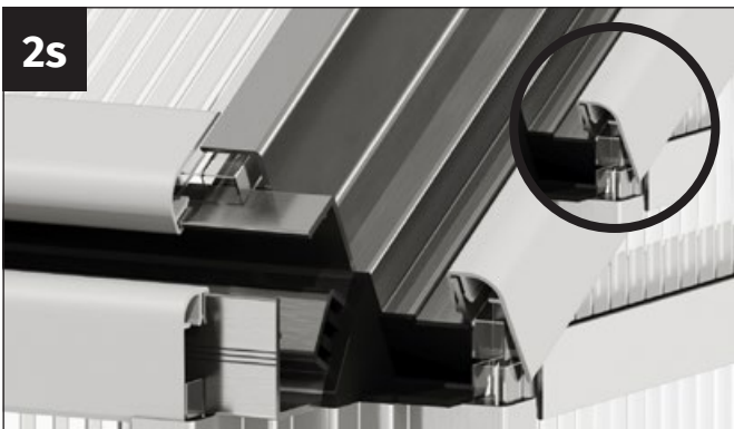
Monter klipsene på takhjørneprofilen. Kontroller at de er klipset godt fast i hele lengden.
