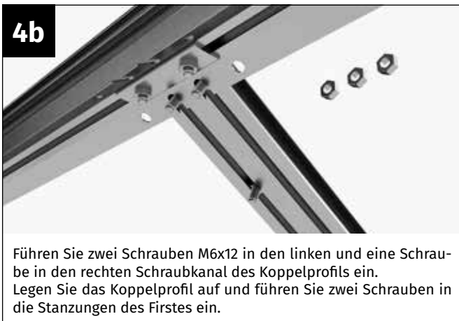
Verschrauben Sie das Koppelprofil mit zwei Muttern M6 fest mit der Regenrinne. Sichern Sie die übrige Schraube des linken Schraubkanals mit einer Mutter M6 vor dem Verrutschen.
