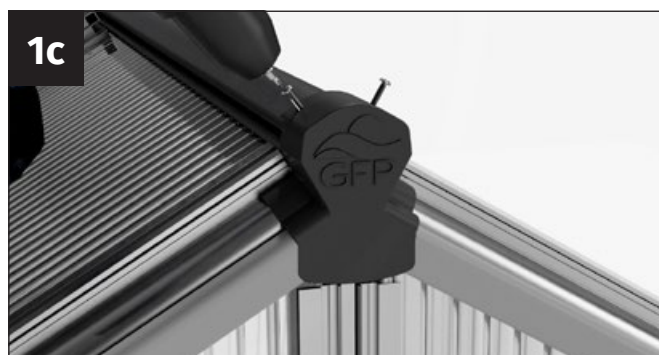
1c Skru rygningdsdækslet fast på rygningdsprofilen med to 3,9x13 mm skruer. 3,9 x 13 mm med rygprofilen.
