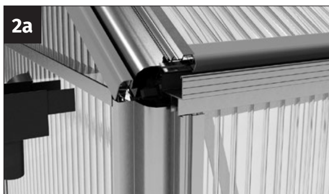
2a Tag et regnvandsafløb til venstre og højre på bagsiden af drivhuset.
