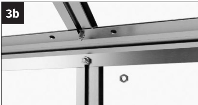
Introduce el tornillo M6x12 en el canal de atornillado del puntal del techo. Colócalo sobre el canalón. Coloca el tornillo M6x12 en la ranura del canalón.
