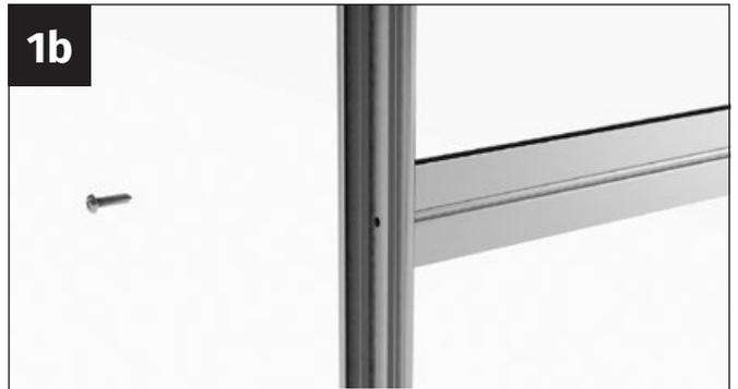
Coloca el montante de la puerta en el lateral del perfil de la puerta de forma que el orificio central perforado quede exactamente encima del cono del tornillo del montante de la puerta.
