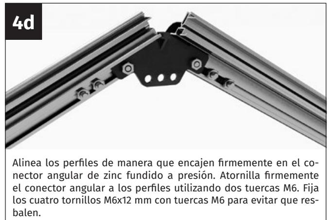
Alinea los perfiles de manera que encajen firmemente en el conector angular de zinc fundido a presión. Atornilla firmemente el conector angular a los perfiles utilizando dos tuercas M6. Fija los cuatro tornillos M6x12 mm con tuercas M6 para evitar que resbalen.
