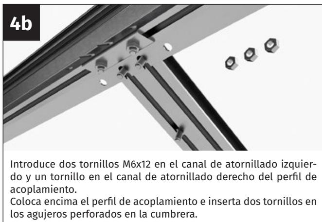
Introduce dos tornillos M6x12 en el canal de atornillado izquierdo y un tornillo en el canal de atornillado derecho del perfil de acoplamiento. Coloca encima el perfil de acoplamiento e inserta dos tornillos en los agujeros perforados en la cumbrera.
