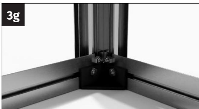
Alinea el conector de suelo de modo que quede exactamente en la esquina de los perfiles de suelo. Atornilla firmemente el conector de suelo a los perfiles de suelo con dos tuercas M6.
