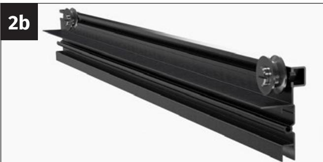
Inserta la tuerca en el canal del tornillo del perfil del rodillo de la puerta. Inserta el perno axial en el rodillo de la puerta. Atornilla el perno axial a la tuerca. Recomendamos colocar el rodillo de la puerta a unos 30 mm del extremo del perfil del rodillo de la puerta.
