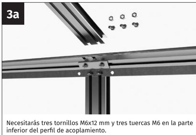
Necesitarás tres tornillos M6x12 mm y tres tuercas M6 en la parte inferior del perfil de acoplamiento.
