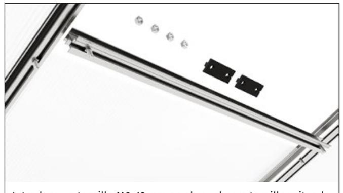
Introduce un tornillo M6x12 mm en el canal para tornillos situado a cada lado del perfil de tope. Inserta un tornillo romboidal en cada canal de atornillado del puntal de techo.
