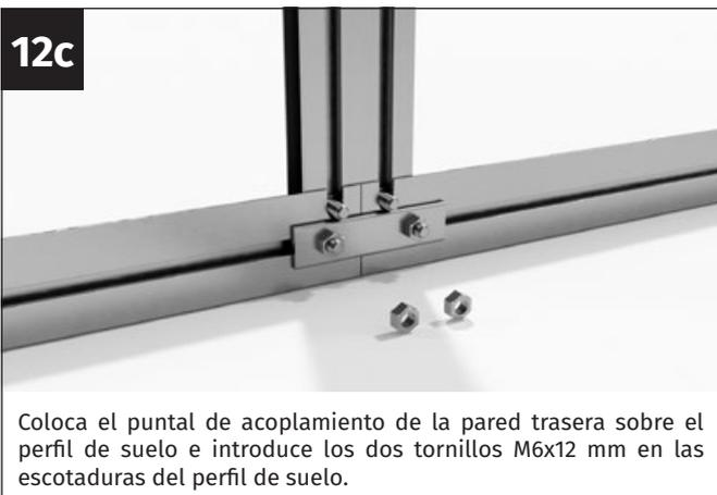
Coloca el puntal de acoplamiento de la pared trasera sobre el perfil de suelo e introduce los dos tornillos M6x12 mm en las escotaduras del perfil de suelo.
