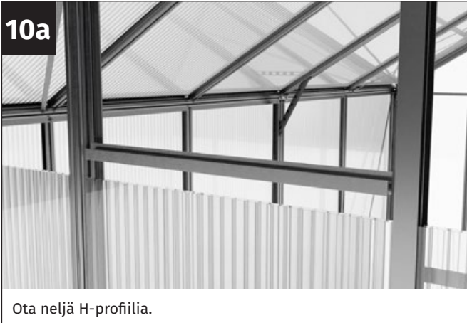
Aseta H-profiili kuhunkin takaseinän neljään verkkopaneeliin. Katso myös edellä oleva yksityiskohtainen kuvaus H-profilien liittämisestä!
