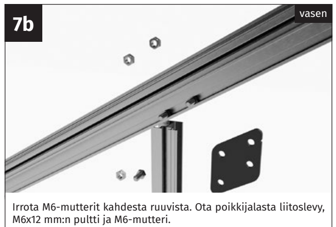
Ruuvaa koolauslevy tiukasti kiinni katon kulmaprofiiliin ja oven sisäänkäynnin profiiliin M6-muttereilla.
