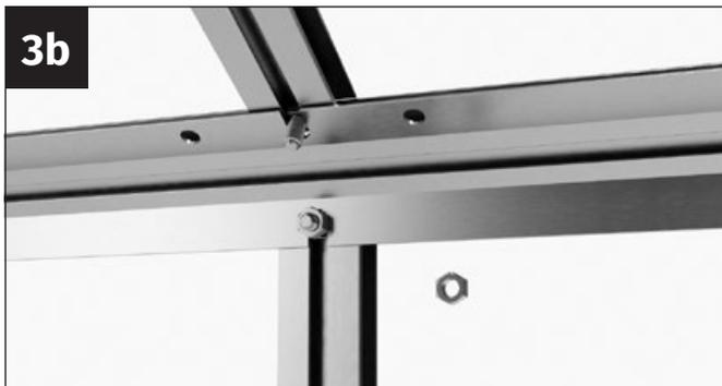
Introduisez la vis M6x12 dans le canal de vissage de l'entretoise de toit. Placez l'entretoise de toit sur la gouttière. Positionnez la vis M6x12 dans le trou de la gouttière.
