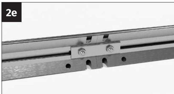
Appuyez les éléments de la gouttière l'un contre l'autre de manière à ce qu'il n'y ait plus d'espace. Vissez fermement les profilés avec les deux écrous M6.
