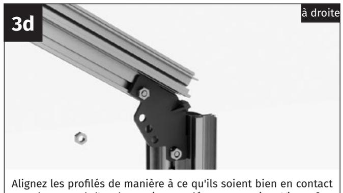
Alignez les profilés de manière à ce qu'ils soient bien en contact avec le raccord d'angle en zinc moulé sous pression. Vissez fermement le connecteur d'angle sur les profilés à l'aide de deux écrous M6.
