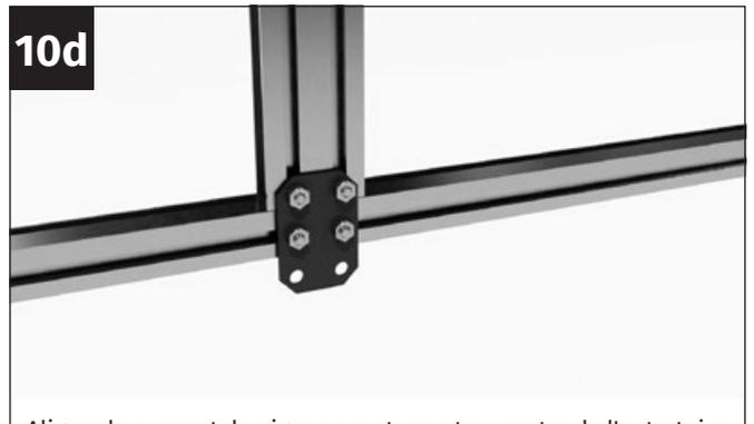
Aligner le support de pignon exactement au centre de l'entretoise et visser fermement le connecteur de fixation au support de pignon et à l'entretoise à l'aide des écrous M6.
