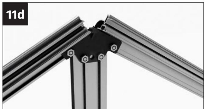
Vissez fermement le support de pignon avec des écrous M6 sur le raccord d'angle en zinc moulé sous pression.
