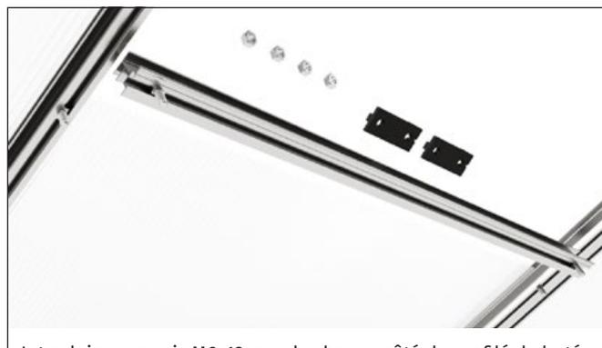
Introduisez une vis M6x12 mm de chaque côté du profilé de butée dans le canal de vissage. Insérez une vis en losange dans chaque canal de vissage de l'entretoise de toit.
