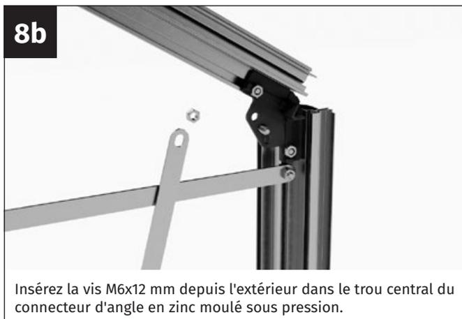
Insérez la vis M6x12 mm depuis l'extérieur dans le trou central du connecteur d'angle en zinc moulé sous pression.
