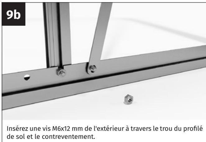
Insérez une vis M6x12 mm de l'extérieur à travers le trou du profilé de sol et le contreventement.
