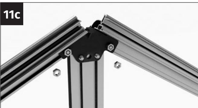
Positionnez le support de pignon de manière à ce que les deux vis dépassent des deux trous extérieurs du connecteur d'angle en zinc moulé sous pression.
