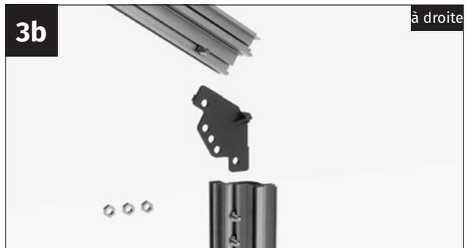
Insérez deux vis M6x12 mm dans le canal de vissage du profilé d'angle latéral et une vis dans le canal de vissage du profilé d'angle de toit.
