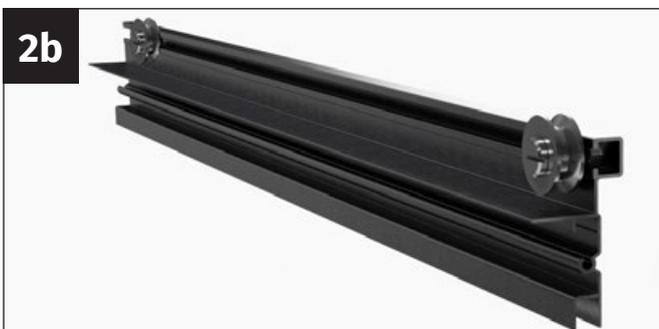
Introduisez l'écrou dans le canal de vissage du rail de porte. Insérez le boulon d'axe dans le rail de porte. Vissez le boulon d'essieu avec l'écrou. Nous recommandons de positionner chaque galet de porte à environ 30 mm de l'extrémité du profilé de guidage de porte.
