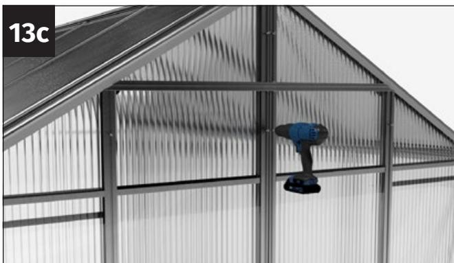
Vissez fermement les baguettes avec des vis 3,9x13 mm sur les entretoises de la paroi arrière.
