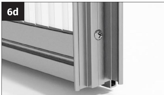
Vissez fermement le profilé de porte latérale au profilé de sol inférieur à l'aide de la vis autotaraudeuse de 4,2 x 22 mm.
