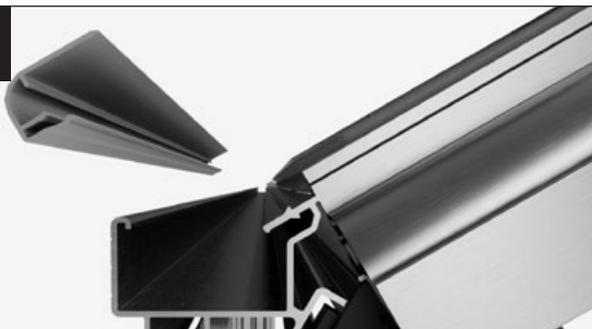
Pour finir, les panneaux de toit sont encore fermés par un clip sur la face inférieure. Coupez le clip à l'aide d'une scie à dents fines de manière à ce qu'il trouve sa place entre les baguettes de serrage en aluminium.
