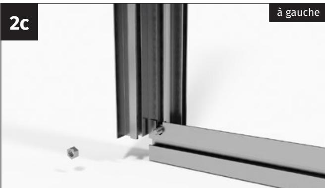
Placez le coin latéral sur le profilé de sol et insérez la vis dans le trou du profilé de sol.
