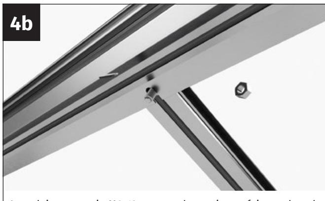
Introduisez une vis M6x12 mm sur la partie supérieure dans le canal de vissage de l'entretoise de toit.
