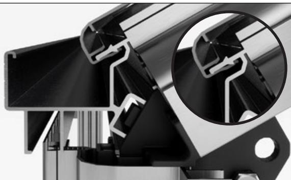
Appuyez fermement le clip de vitrage sur la gouttière. Veillez à ce que celui-ci soit clipsé dans la gouttière sur toute sa longueur.
