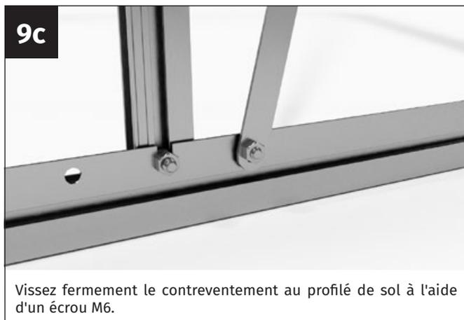
Vissez fermement le contreventement au profilé de sol à l'aide d'un écrou M6.
