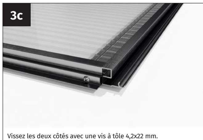
Vissez les deux côtés avec une vis à tôle 4,2x22 mm.
