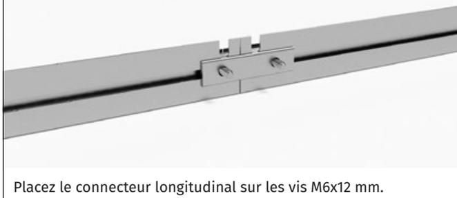
Placez le connecteur longitudinal sur les vis M6x12 mm.
