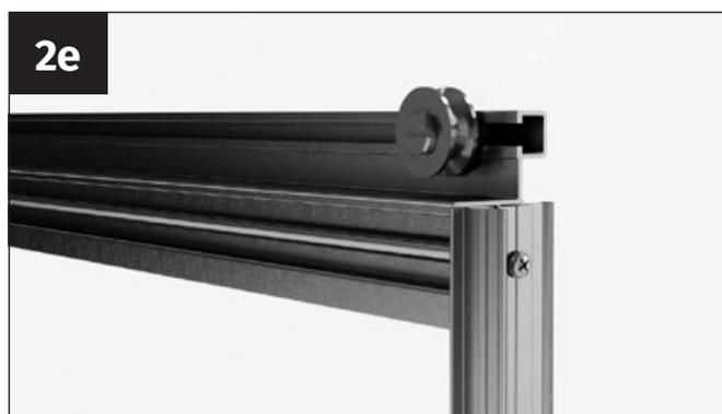
Vissez fermement le rail de guidage de la porte au profilé de sol inférieur à l'aide de la vis à tôle de 4,2 x 22 mm.
