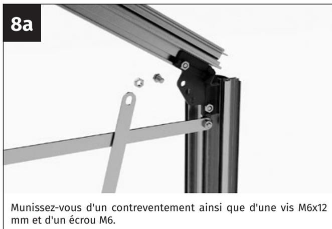
Munissez-vous d'un contreventement ainsi que d'une vis M6x12 mm et d'un écrou M6.
