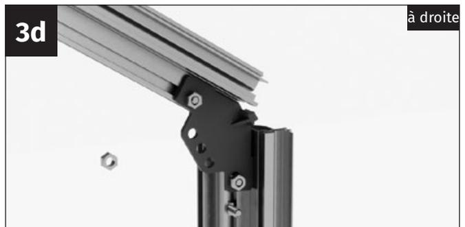
Alignez les profilés de manière à ce qu'ils soient bien en contact avec le raccord d'angle en zinc moulé sous pression. Vissez fermement le connecteur d'angle sur les profilés à l'aide de deux écrous M6.
