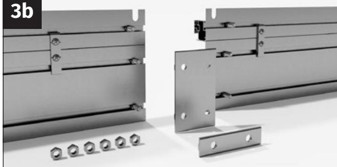
Introduisez une vis M6x12 mm à gauche et à droite dans le profilé de sol de la serre et une vis dans chacun des canaux de vissage du profilé de fondation.
