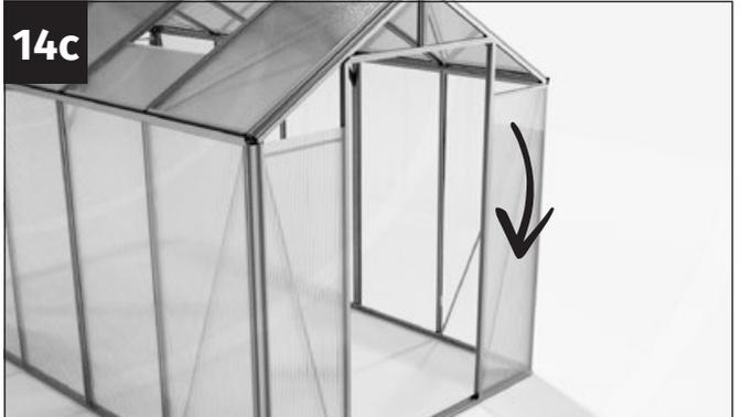
Prenez un panneau double paroi de la paroi avant et insérez-le par le haut dans la rainure du deuxième profilé d'angle latéral.
