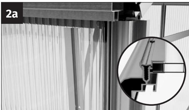
Pour le profilé d'angle latéral, prenez une baguette de serrage asymétrique et des chasse-tôle 3,9x13 mm.
