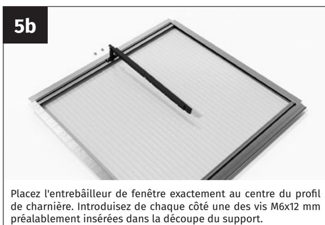
Placez l'entrebâilleur de fenêtre exactement au centre du profil de charnière. Introduisez de chaque côté une des vis M6x12 mm préalablement insérées dans la découpe du support.
