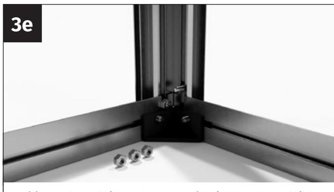
Positionner le profilé de sol de la paroi latérale sur le profilé d'angle latéral. Orientez la vis M6x12 mm de manière à ce qu'elle passe par le trou du connecteur d'angle pour profilé de sol.
