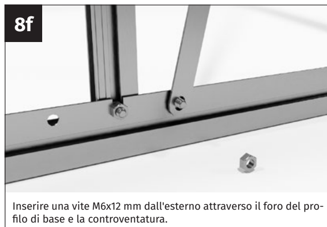
Avvitare la controventatura al connettore angolare in zinco pressofuso con un dado M6.
