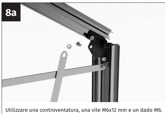
Inserire la vite M6x12 mm dall'esterno attraverso il foro centrale del connettore angolare in zinco pressofuso.
