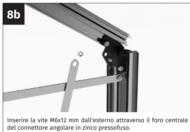
Utilizzare una controventatura, una vite M6x12 mm e un dado M6.
