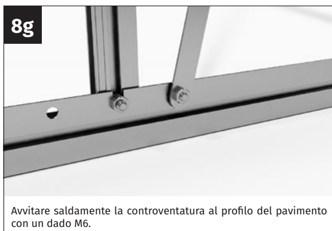
Posizionare la parte inferiore della controventatura sul foro previsto nel profilo del pavimento.
