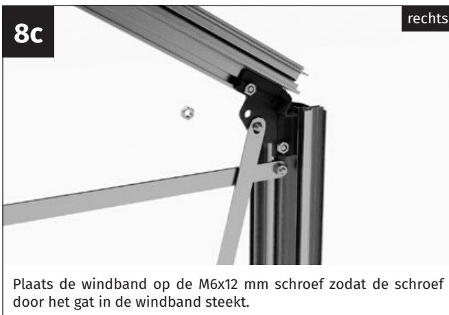
Neem een windband, een M6x12 mm schroef en een M6 moer.
