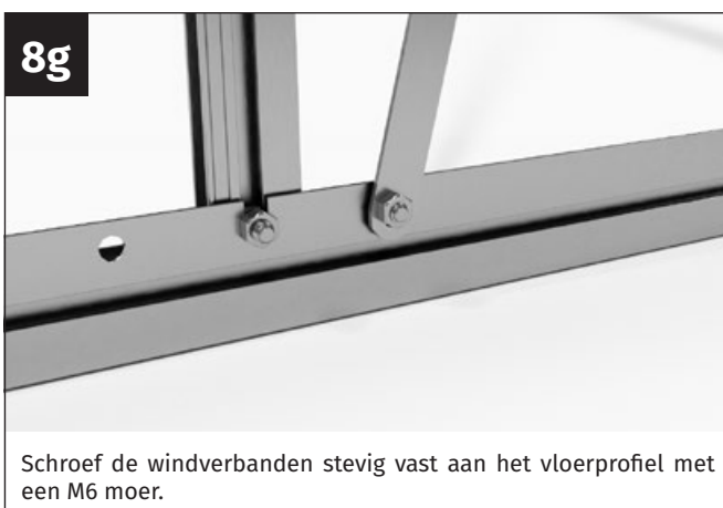
Plaats de onderkant van de windband op het daarvoor bestemde gat in het bodemprofiel.
