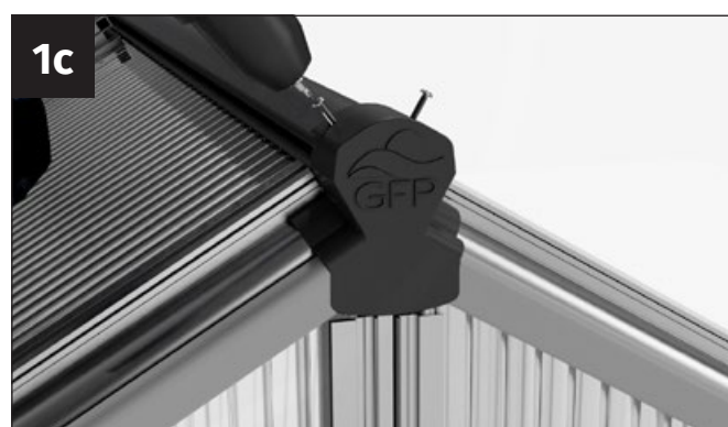
Skru mønedekselet sammen med to skruer 3,9 x 13 mm til møneprofilen.
