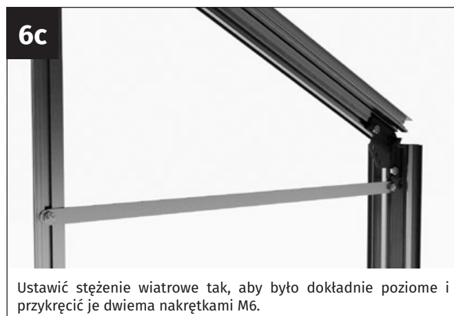
Umieścić stężenie wiatrowe na dwóch śrubach M6x12 mm tak, aby wystawały przez otwory w stężeniu wiatrowym.
