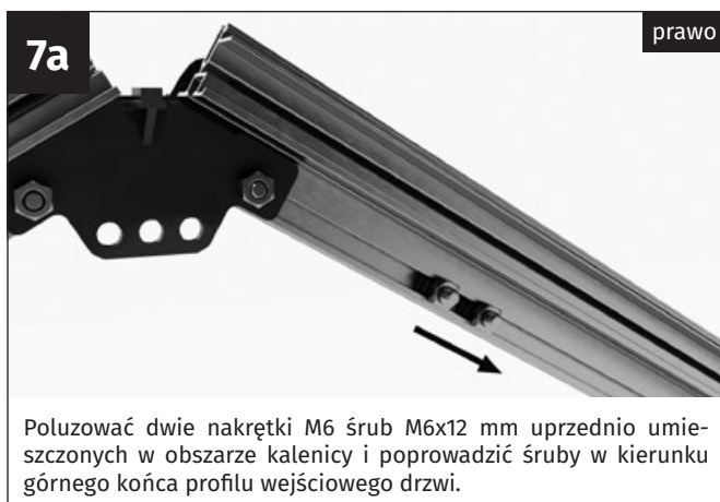
Umieścić stężenie wiatrowe na dwóch śrubach M6x12 mm tak, aby wystawały przez otwory w stężeniu wiatrowym.
