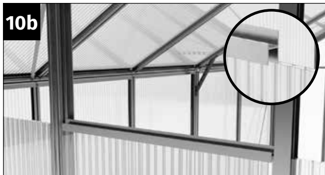
10b Coloque um perfil em H em cada uma das quatro placas com nervuras da parede traseira. Veja também os detalhes acima sobre a colocação dos perfis em H!
