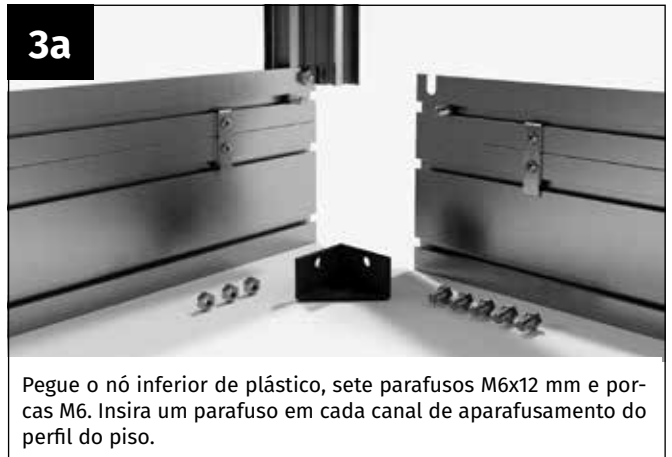
3a Pegue o nó inferior de plástico, sete parafusos M6x12 mm e porcas M6. Insira um parafuso em cada canal de aparafusamento do perfil do piso.
