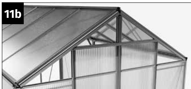
11b Insira as duas placas na parede traseira. Para isso, insira-a por baixo na ranhura do perfil transversal e, em seguida, pressione a placa contra os suportes da parede traseira. Em seguida, pressione as placas para baixo, de modo que fiquem firmemente apoiadas nos perfis em H.
