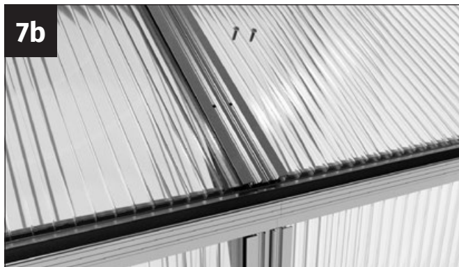
Placera klämlisten asymmetriskt på takets kopplingsstag. OBS: Kopplingsstaget och klämlisterna måste vara lika långa!
