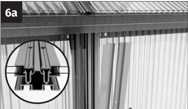
För sidoväggens kopplingsstag ska du använda två asymmetriska klämlister och en 3,9 x 13 mm plåtskruvmejsel.
