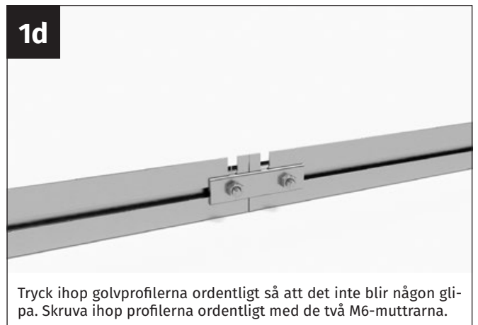
För in en M6x12 mm-skruv i golvprofilens skruvkanal.
