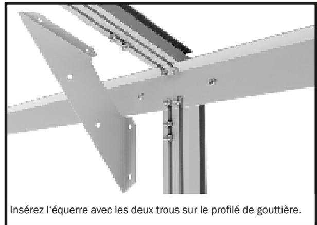
Insérez l'équerre avec les deux trous sur le profilé de gouttière.
