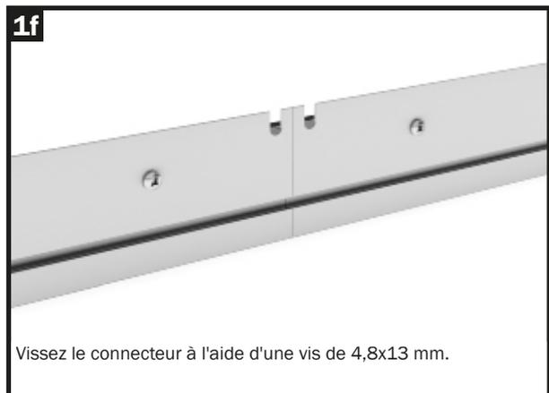
Vissez le connecteur à l'aide d'une vis de 4,8x13 mm.
