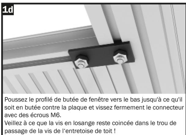
Poussez le profilé de butée de fenêtre vers le bas jusqu'à ce qu'il soit en butée contre la plaque et vissez fermement le connecteur avec des écrous M6.
