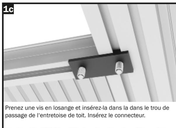
Prenez une vis en losange et insérez-la dans le trou de passage de l'entretoise de toit. Insérez le connecteur.
