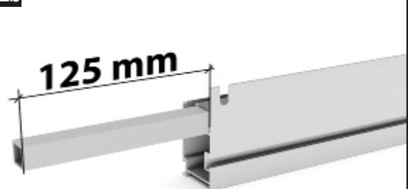
Insérez la moitié du connecteur dans le profilé de sol, de sorte qu'il dépasse de 125 mm du profilé.
