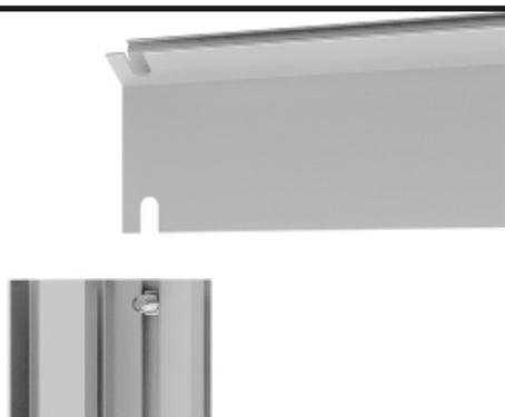
Introduisez la vis M6 x 12 dans le trou de passage du profilé d'angle latéral et placez le profilé de gouttière.
