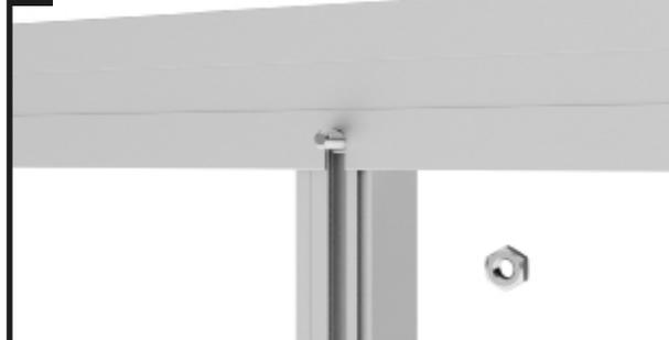
Introduisez une vis M6x12 dans le trou de passage du profilé de porte d'entrée et positionnez-la dans celui de l'entretoise transversale.
