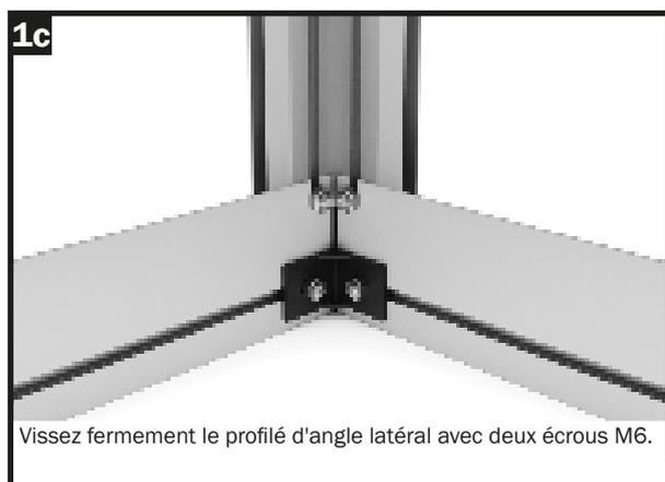
Vissez fermement le profilé d'angle latéral avec deux écrous M6.
