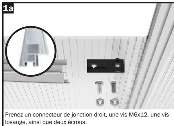
Prenez un connecteur de jonction droit, une vis M6x12, une vis losange, ainsi que deux écrous.
