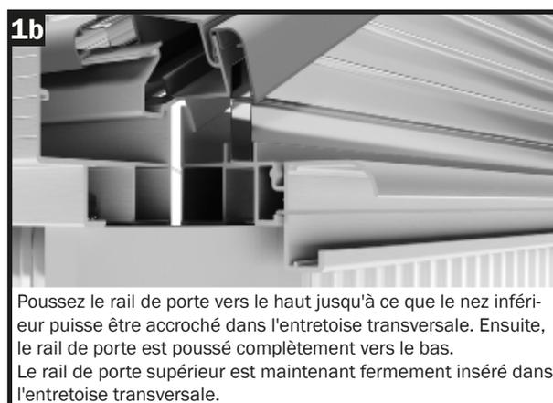
Poussez le rail de porte vers le haut jusqu'à ce que le nez inférieur puisse être accroché dans l'entretoise transversale. Ensuite, le rail de porte est poussé complètement vers le bas. Le rail de porte supérieur est maintenant fermement inséré dans l'entretoise transversale.
