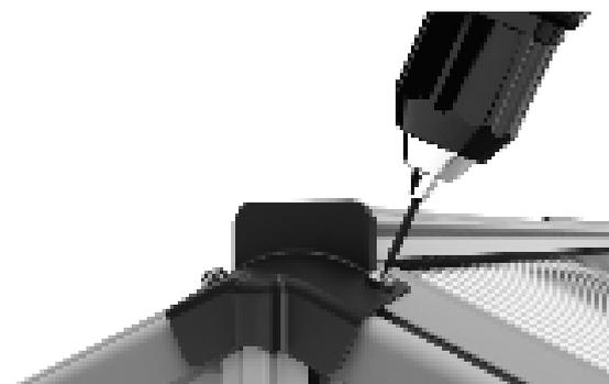
Fixez l'embout de protection avec les vis de 4,8x13 mm sur le faîte.
