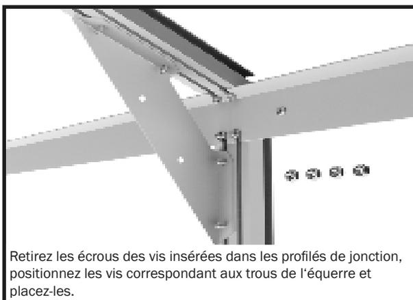
Retirez les écrous des vis insérées dans les profilés de jonction, positionnez les vis correspondant aux trous de l'équerre et placez-les.
