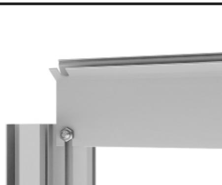
Placez le profilé de gouttière et vissez-le fermement au profilé d'angle latéral avec un écrou M6.
