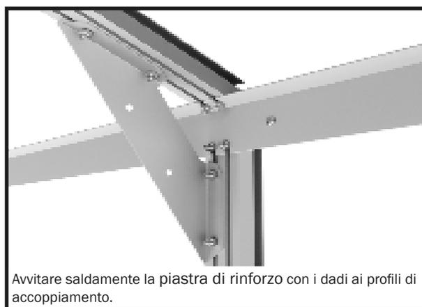
Avvitare saldamente la piastra di rinforzo con i dadi ai profili di accoppiamento.
