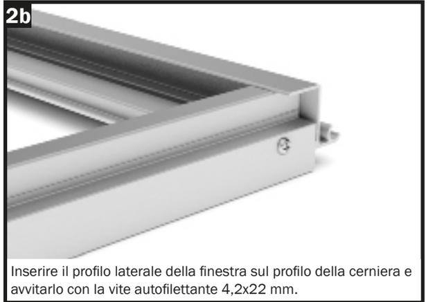
Inserire il profilo laterale della finestra sul profilo della cerniera e avvitare con la vite autofilettante 4,2x22 mm.
