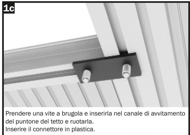
Prendere una vite a brugola e inserirla nel canale di avvitemento del puntone del tetto e ruotarla. Inserire il connettore in plastica.
