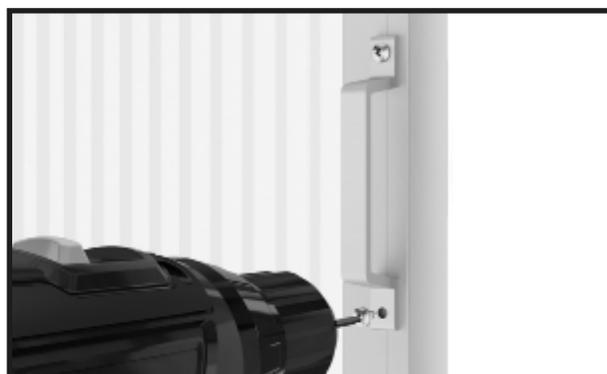
Fissare le maniglie delle porte con le viti perforanti da 4,8x13 mm
