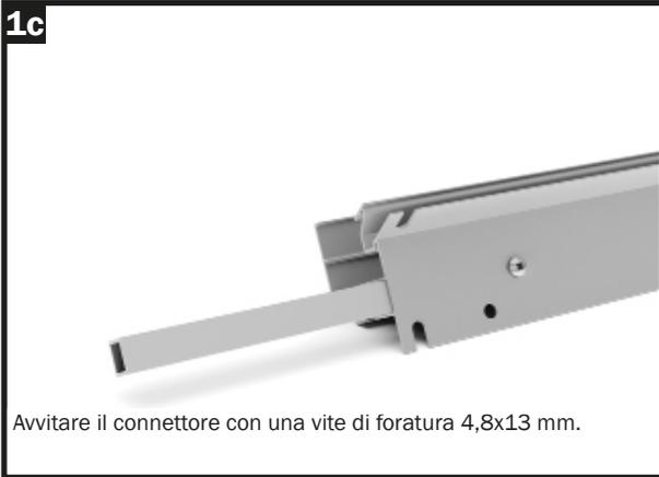
Avvitare il connettore con una vite di foratura 4,8x13 mm.
