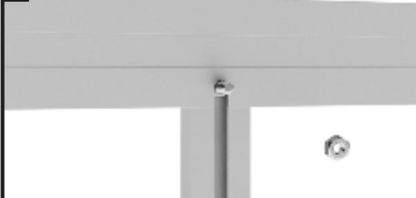
Inserire la vite M6x12 nel canale di avvitamento del puntone. Per avvitare, posizionare il puntone sul puntone trasversale e inserire la vite nel foro del puntone trasversale punzonato.
