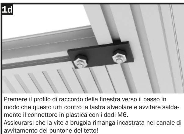
Premere il profilo di raccordo della finestra verso il basso in modo che questo urti contro la lastra alveolare e avvitare saldamente il connettore in plastica con i dadi M6. Assicurarsi che la vite a brugola rimanga incastrata nel canale di avvitemento del puntone del tetto!
