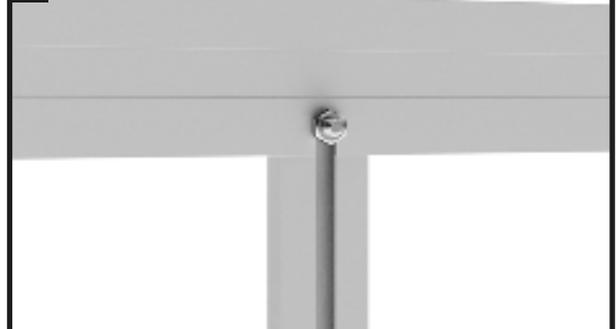
Avvitare saldamente il puntone al puntone trasversale con un dado M6.
