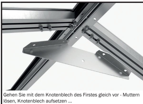
Nehmen Sie die Muttern von den in den Koppelprofilen eingesetzten Schrauben ab, positionieren Sie die Schrauben entsprechend der Löcher im Knotenblech und setzen Sie dieses auf.
