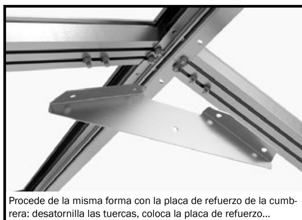
Retira las tuercas de los tornillos insertados en los perfiles de acoplamiento, posiciona los tornillos correspondientes a los orificios en la placa de refuerzo y colócalos.
