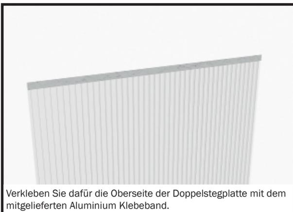
Verkleben Sie dafür die Oberseite der Doppelstegplatte mit dem mitgelieferten Aluminium Klebeband.
