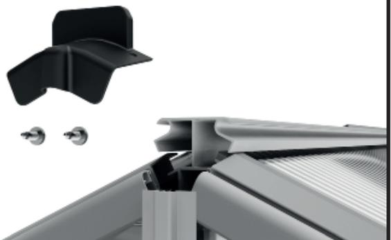
Bereiten Sie die Abdeckkappe des Firstes und selbstbohrende Schrauben 4,8 x 13 mm für die Montage vor.
