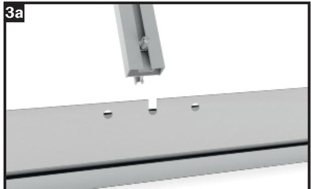
Zur Montage der Strebe führen Sie eine Schraube M6x12 in deren Schraubkanal.
