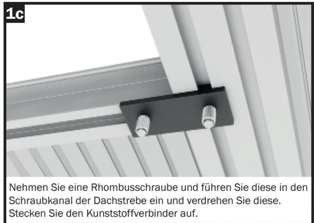
Nehmen Sie eine Rhobusschraube und führen Sie diese in den Schraubenkanal der Dachstrebe ein und verdrehen Sie diese. Stecken Sie den Kunststoffverbinder auf.
