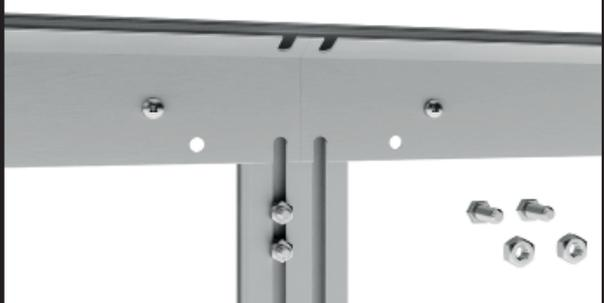
Führen Sie zwei Schrauben M6x12 in den linken Schraubkanal und sichern Sie diese mit Muttern M6 vor dem Verrutschen
