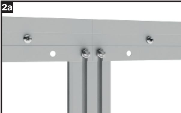
Verfahren Sie an der Oberseite des Koppelprofils gleich, wie an der Unterseite.
