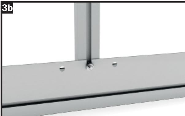
Verschrauben Sie die Strebe mit einer Mutter M6 fest mit dem Bodenprofil.
