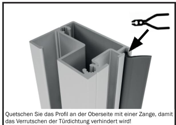
Quetschen Sie das Profil an der Oberseite mit einer Zange, damit das Verrutschen der Türdichtung verhindert wird!
