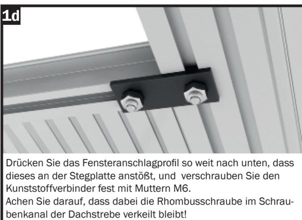
Drücken Sie das Fensteranschlagprofil so weit nach unten, dass dieses an der Stegplatte anstößt, und verschrauben Sie den Kunststoffverbinder fest mit Muttern M6. Achten Sie darauf, dass dabei die Rhobusschraube im Schraubenkanal der Dachstrebe verkeilt bleibt!
