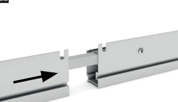
Stecken Sie das zweite Bodenprofil auf den Verbinder.
