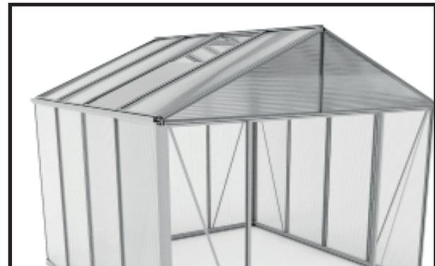
Beginnen Sie beim Verglasen der Front- bzw. Rückwand am Besten mit dem Einsetzen der Giebelplatten.
