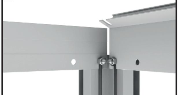
Setzen Sie die Querstrebe auf und verschrauben Sie diese mit einer Mutter M6 fest mit dem Seiteneckprofil.
