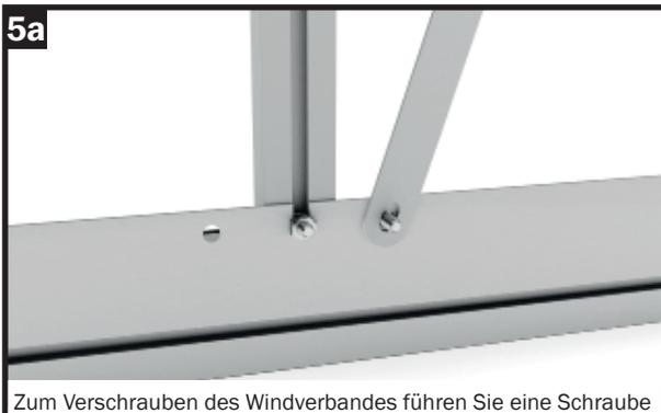
Zum Verschrauben des Windverbandes führen Sie eine Schraube M6x12 von der Außenseite durch das dafür ausgestanzte Loch des Bodenprofils und setzen danach den Windverband auf.
