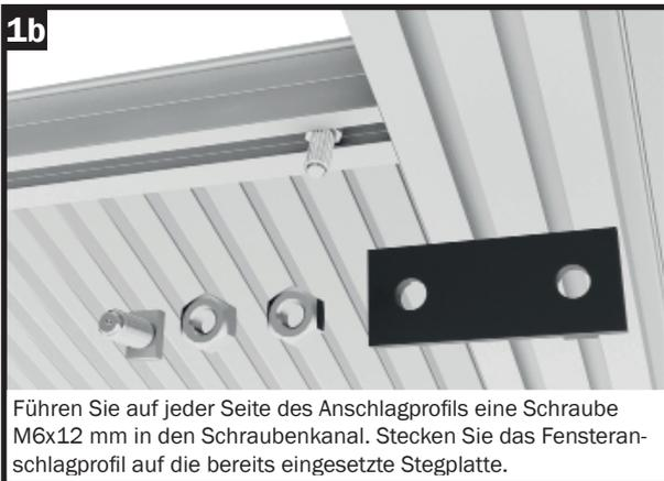
Führen Sie auf jeder Seite des Anschlagprofils eine Schraube M6x12 mm in den Schraubenkanal. Stecken Sie das Fensteranschlagprofil auf die bereits eingesetzte Stegplatte.
