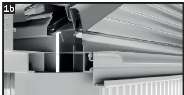
Drücken Sie die Türschiene so weit nach oben, bis die untere Nase in der Querstrebe eingehängt werden kann. Anschließend wird die Türschiene ganz nach unten gedrückt. Die obere Türschiene steckt nun fest in der Querstrebe.
