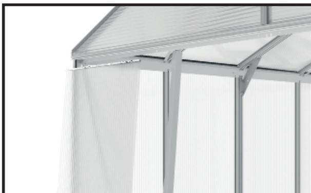
Nehmen Sie das Türeingangsprofil der Frontwand ab und setzen Sie die Stegplatte ein.
