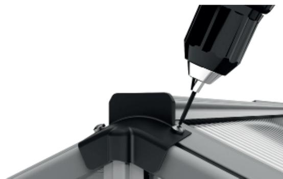
Befestigen Sie die Abdeckkappe mit den Bohrschrauben 4,8x13 mm am First.
