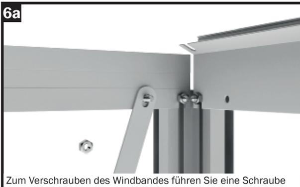
Zum Verschrauben des Windverbandes führen Sie eine Schraube M6x12 von der Außenseite durch das dafür ausgestanzte Loch der Querstrebe und setzen danach den Windverband auf.
