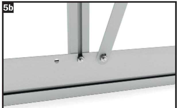
Verschrauben Sie den Windverband mit einer Mutter M6 fest mit dem Bodenprofil.
