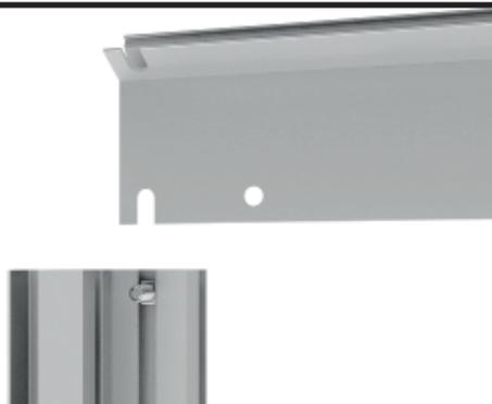
Führen Sie die Schraube M6x12 in den Schraubenkanal des Seiteneckprofils und setzen Sie die Regenrinne auf.
