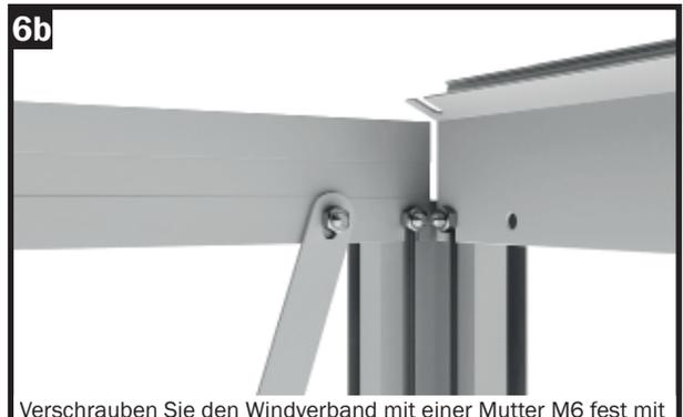
Verschrauben Sie den Windverband mit einer Mutter M6 fest mit der Querstrebe.
