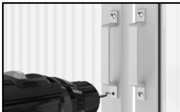
Fastgør dørhåndtagene med de selvboende 4,8x13 mm skruer
