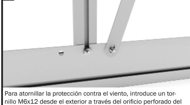
Para atornillar la protección contra el viento, introduce un tornillo M6x12 desde el exterior a través del orificio perforado del perfil de suelo y, a continuación, coloca la protección contra el viento.
