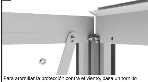
Para atornillar la protección contra el viento, pasa un tornillo M6x12 desde el exterior a través del orificio perforado en el refuerzo transversal, y después coloca la protección contra el viento.
