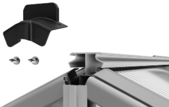
Prepara la tapa y los tornillos auto-perforantes de 4,8 x 13 mm para el montaje.
