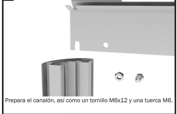
Prepara el canalón, así como un tornillo M6x12 y una tuerca M6.
