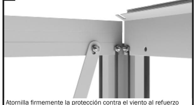
Atornilla firmemente la protección contra el viento al refuerzo transversal con una tuerca M6.
