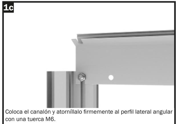
Coloca el canalón y atorníllalo firmemente al perfil lateral angular con una tuerca M6.
