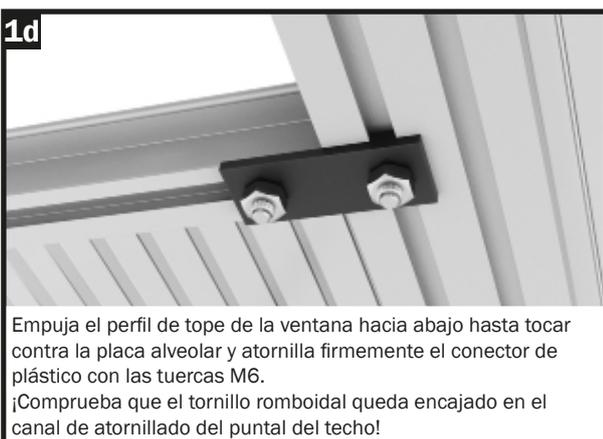
Empuja el perfil de tope de la ventana hacia abajo hasta tocar contra la placa alveolar y atornilla firmemente el conector de plástico con las tuercas M6.
