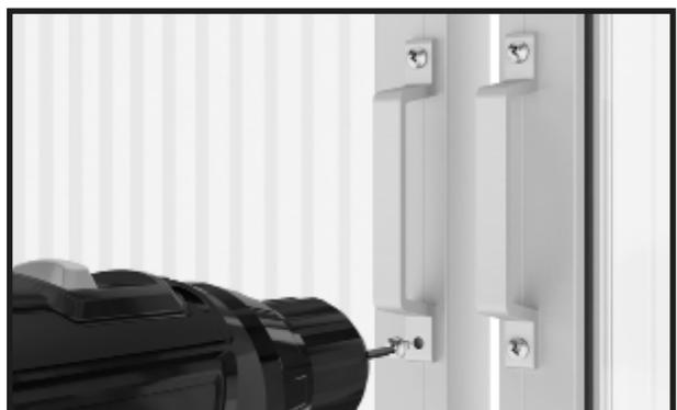
Fija los tiradores de las puertas con los tornillos perforantes de 4,8x13 mm
