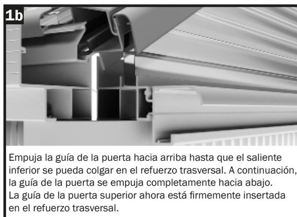
Empuja la guía de la puerta hacia arriba hasta que el saliente inferior se pueda colgar en el refuerzo transversal. A continuación, la guía de la puerta se empuja completamente hacia abajo. La guía de la puerta superior ahora está firmemente insertada en el refuerzo transversal.
