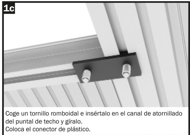
Coge un tornillo romboidal e insértalo en el canal de atornillado del puntal de techo y gíralo. Coloca el conector de plástico.
