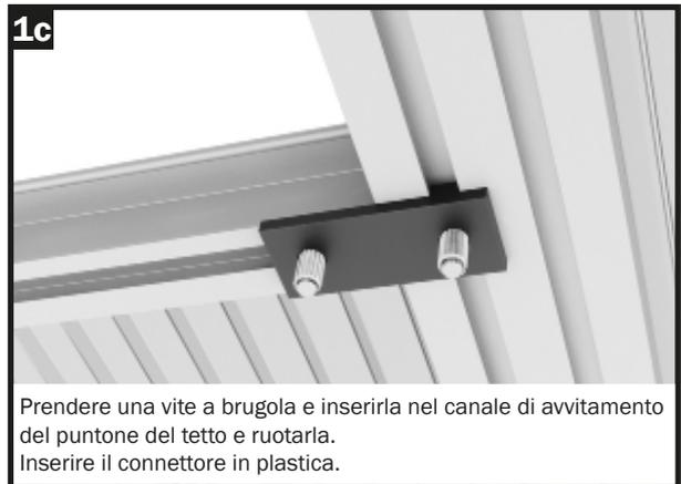
Prendere una vite a brugola e inserirla nel canale di avvitamento del puntone del tetto e ruotarla. Inserire il connettore in plastica.
