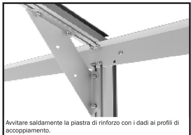
Avvitare saldamente la piastra di rinforzo con i dadi ai profili di accoppiamento.
