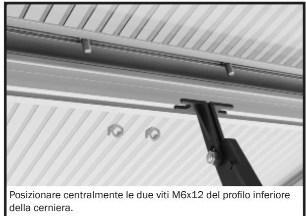
Posizionare centralmente le due viti M6x12 del profilo inferiore della cerniera.
