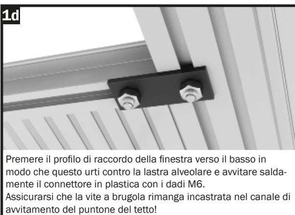
Premere il profilo di raccordo della finestra verso il basso in modo che questo urti contro la lastra alveolare e avvitare saldamente il connettore in plastica con i dadi M6. Assicurarsi che la vite a brugola rimanga incastrata nel canale di avvitamento del puntone del tetto!
