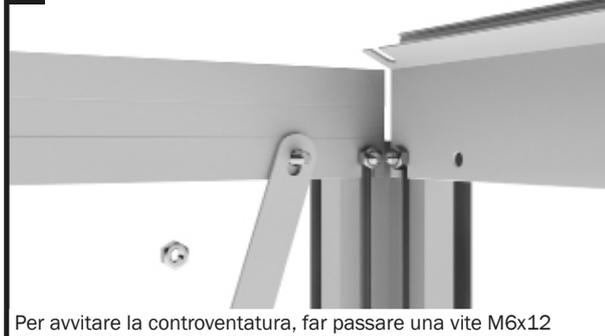
Per avvitare la controventatura, far passare una vite M6x12 dall'esterno attraverso il foro del puntone trasversale punzonato e quindi applicare la controventatura.
