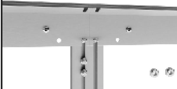
Inserire una vite M6x12 nel canale di avvitamento del profilo del profilo di accoppiamento.
