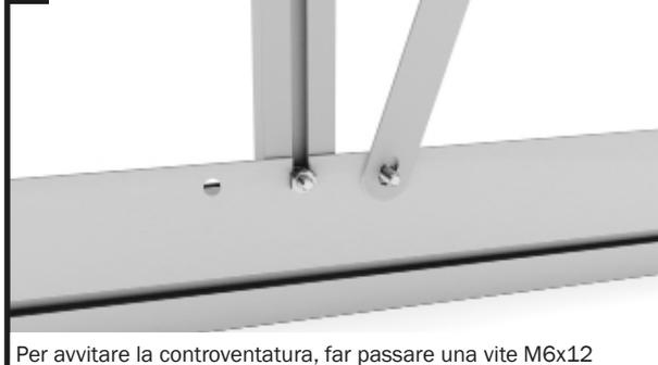
Per avvitare la controventatura, far passare una vite M6x12 dall'esterno attraverso il foro del profilo del pavimento punzonato e quindi applicare la controventatura.
