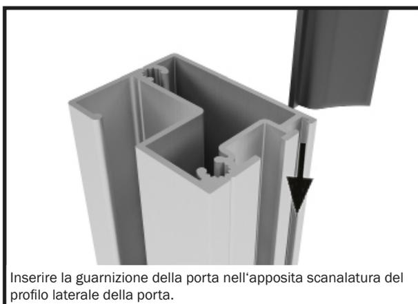
Inserire la guarnizione della porta nell'apposita scanalatura del profilo laterale della porta.
