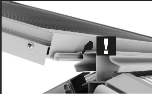
Assicurarsi che il cono della cerniera dell'anta della finestra sia inserito nella parte della cerniera del profilo del colmo.
