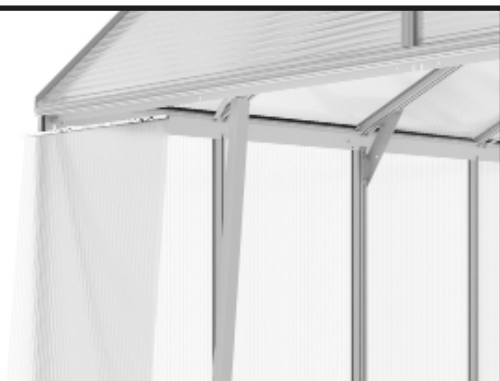
Ta bort dörrprofil från frontväggen och sätt in panelen.
