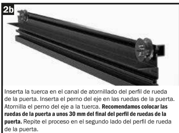
Inserta la tuerca en el canal de atornillado del perfil de rueda de la puerta. Inserta el perno del eje en las ruedas de la puerta. Atornilla el perno del eje a la tuerca. **Recomendamos colocar las ruedas de la puerta a unos 30 mm del final del perfil de ruedas de la puerta.** Repite el proceso en el segundo lado del perfil de rueda de la puerta.
