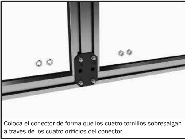
Coloca el conector de forma que los cuatro tornillos sobresalgan a través de los cuatro orificios del conector.
