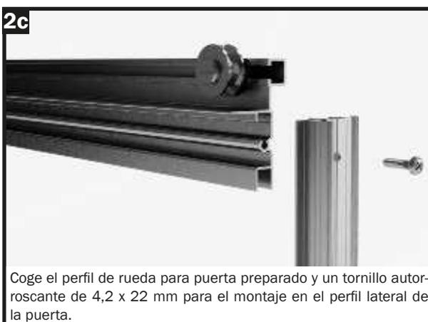
Coge el perfil de rueda para puerta preparado y un tornillo autorroscante de 4,2 x 22 mm para el montaje en el perfil lateral de la puerta.
