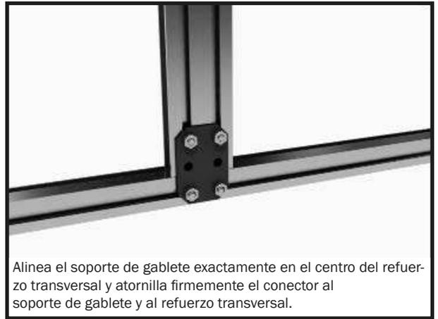
Alinea el soporte de gablete exactamente en el centro del refuerzo transversal y atornilla firmemente el conector al soporte de gablete y al refuerzo transversal.
