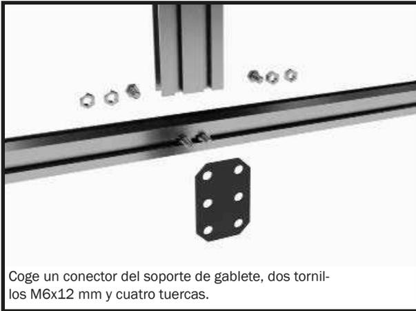
Coge un conector del soporte de gablete, dos tornillos M6x12 mm y cuatro tuercas.
