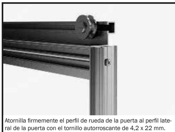
Atornilla firmemente el perfil de rueda de la puerta al perfil lateral de la puerta con el tornillo autorroscante de 4,2 x 22 mm.
