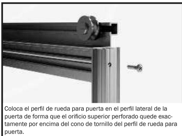
Coloca el perfil de rueda para puerta en el perfil lateral de la puerta de forma que el orificio superior perforado quede exactamente por encima del cono de tornillo del perfil de rueda para puerta.
