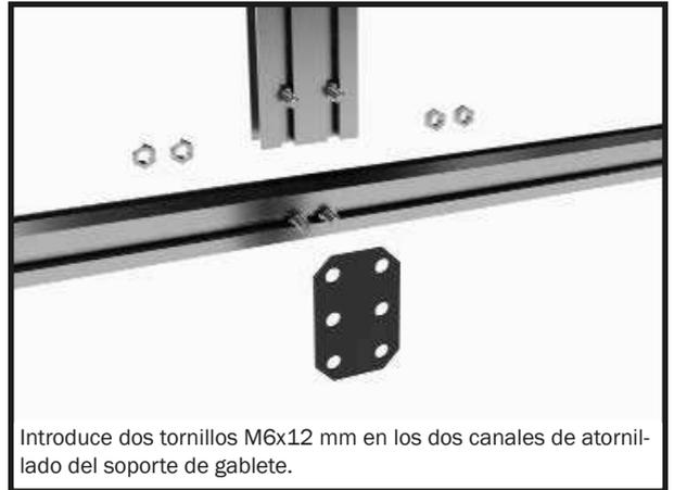
Introduce dos tornillos M6x12 mm en los dos canales de atornillado del soporte de gablete.
