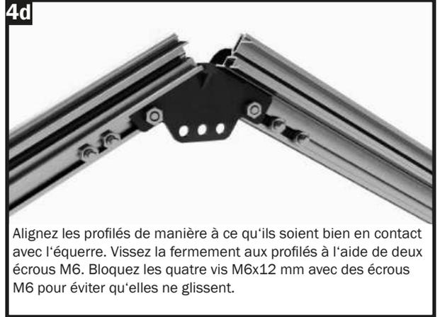
Alignez les profilés de manière à ce qu'ils soient bien en contact avec l'équerre. Vissez la fermement aux profilés à l'aide de deux écrous M6. Bloquez les quatre vis M6x12 mm avec des écrous M6 pour éviter qu'elles ne glissent.
