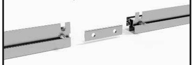
Introduisez une vis M6x12 mm dans le trou de passage du profilé de sol.
