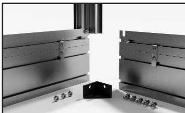
Prenez le connecteur de sol, sept vis M6 x 12 mm, ainsi que des écrous M6. Introduisez chaque fois une vis dans le trou de passage du profilé de sol.
