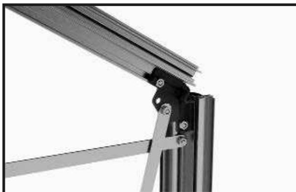
Vissez la barre avec l'équerre de fixation avec un écrou M6.
