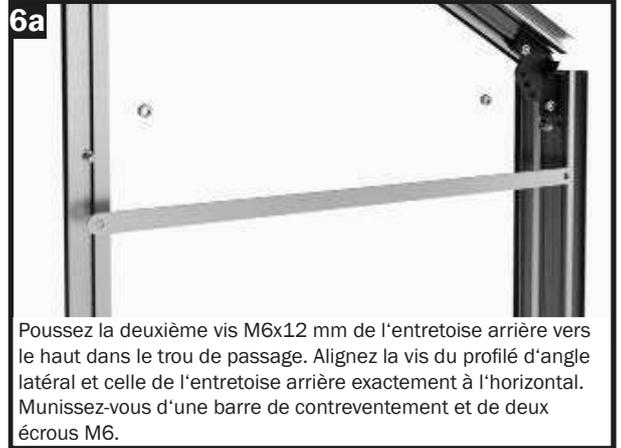
Poussez la deuxième vis M6x12 mm de l'entretoise arrière vers le haut dans le trou de passage. Alignez la vis du profilé d'angle latéral et celle de l'entretoise arrière exactement à l'horizontal. Munissez-vous d'une barre de contreventement et de deux écrous M6.
