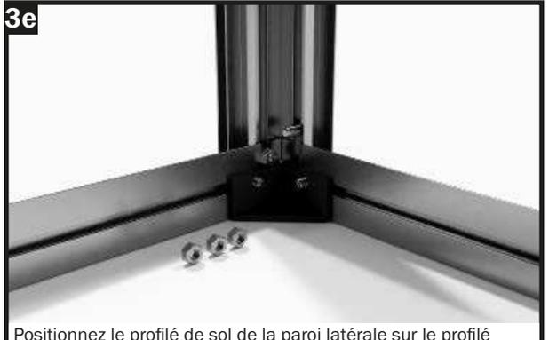
Positionnez le profilé de sol de la paroi latérale sur le profilé d'angle latéral. Alignez les vis M6x12 mm de manière à ce qu'elles dépassent à travers le trou du connecteur d'angle.
