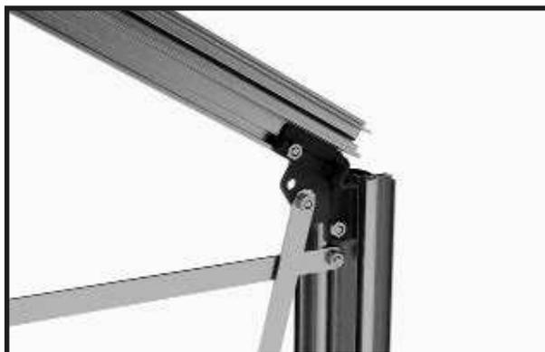
Vissez la barre avec un écrou M6 avec l'équerre de fixation en zinc.
