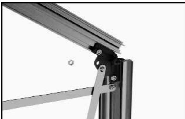
Posizionare la controventatura sulla vite M6x12 mm in modo che la vite sporga attraverso il foro della controventatura.
