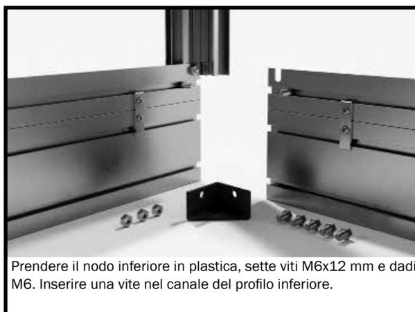
Prendere il nodo inferiore in plastica, sette viti M6x12 mm e dadi M6. Inserire una vite nel canale del profilo inferiore.
