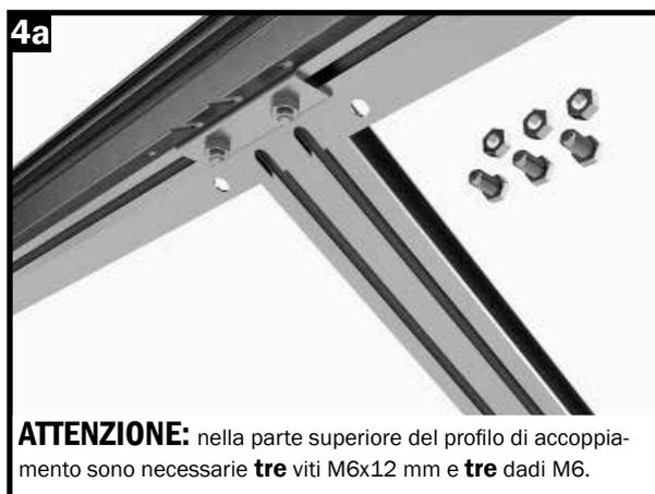
**ATTENZIONE:** nella parte superiore del profilo di accoppiamento sono necessarie **tre** viti M6x12 mm e **tre** dadi M6.
