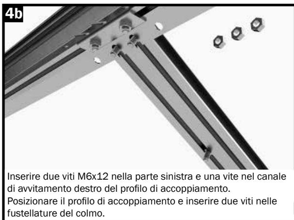
Inserire due viti M6x12 nella parte sinistra e una vite nel canale di avvitamento destro del profilo di accoppiamento. Posizionare il profilo di accoppiamento e inserire due viti nelle fustellature del colmo.
