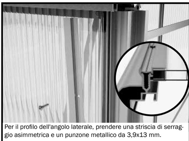
Per il profilo dell'angolo laterale, prendere una striscia di serraggio asimmetrica e un punzone metallico da 3,9x13 mm.
