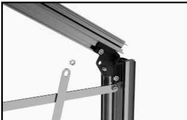
Far passare la vite M6x12 mm dall'esterno attraverso il foro centrale del connettore angolare pressofuso di zinco.
