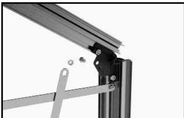
Prendere una controventatura e una vite M6x12 mm e un dado M6.
