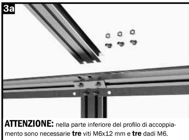
**ATTENZIONE:** nella parte inferiore del profilo di accoppiamento sono necessarie **tre** viti M6x12 mm e **tre** dadi M6.
