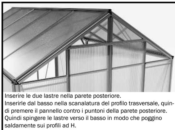
Inserire le due lastre nella parete posteriore. Inserirle dal basso nella scanalatura del profilo trasversale, quindi premere il pannello contro i puntoni della parete posteriore. Quindi spingere le lastre verso il basso in modo che poggino saldamente sui profili ad H.
