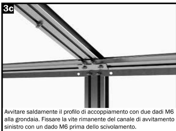
Avvitare saldamente il profilo di accoppiamento con due dadi M6 alla grondaia. Fissare la vite rimanente del canale di avvitamento sinistro con un dado M6 prima dello scivolamento.
