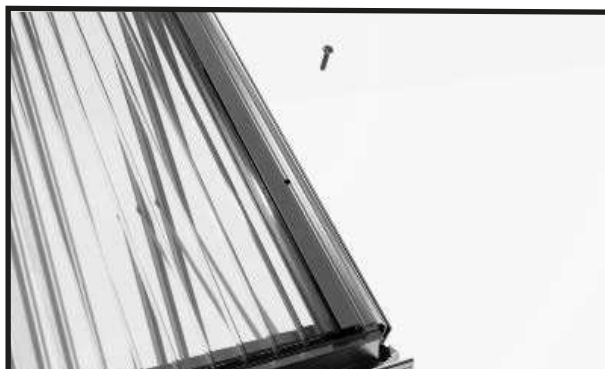
Plaats de klemmenstrook asymmetrisch op het dakhoekprofiel. OPMERKING: Dakhoekprofiel en klemmenstrook moeten dezelfde lengte hebben!
