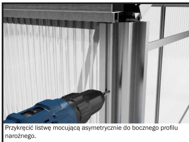
Do boczego profilu narożnego należy zastosować asymetryczną listwę zaciskową i blachowkręt 3,9x13 mm.
