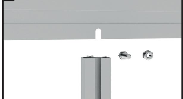
Nehmen Sie eine Strebe sowie eine Schraube M6x12 mm und eine Mutter M6 zur Hand.
