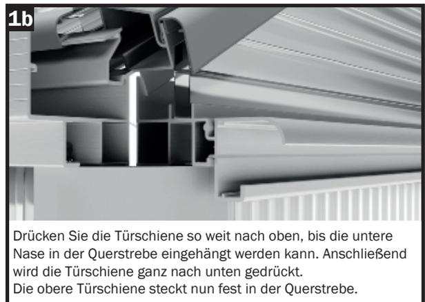
Drücken Sie die Türschiene so weit nach oben, bis die untere Nase in der Querstrebe eingehängt werden kann. Anschließend wird die Türschiene ganz nach unten gedrückt. Die obere Türschiene steckt nun fest in der Querstrebe.
