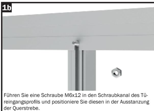
Führen Sie eine Schraube M6x12 in den Schraubkanal des Türeingangsprofils und positioniere Sie diesen in der Auszanzung der Querstrebe.
