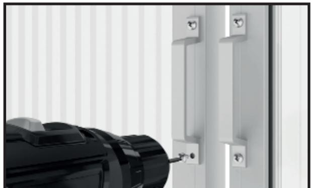
Befestigen Sie die Türgriffe mit den Bohrschrauben 4,8x13 mm
