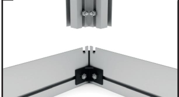
Setzen Sie das Giebeleckprofil mit den beiden eingeführten Schrauben M6x12 auf die Bodenprofile auf.
