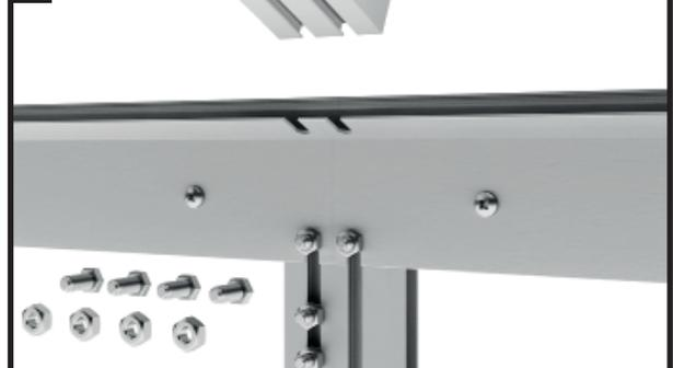
Bereiten Sie das Koppelprofil des Daches, sowie 4 Schrauben M6x12 und 4 Muttern M6 für die Montage vor.
