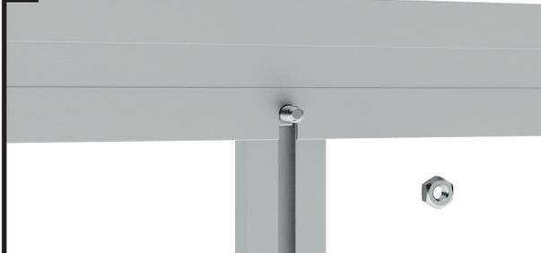
Führen Sie die Schraube M6x12 in den Schraubenkanal der Strebe. Positionieren Sie die Strebe an der Querstrebe und führen Sie die Schraube in das zur Verschraubung ausgestanzte Loch in der Querstrebe.
