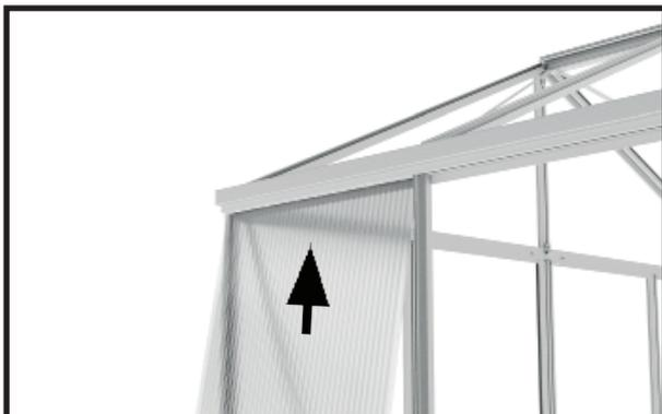
Setzen Sie die Seitenwandplatten in den Rahmen ein, indem Sie diese von unten in die Regenrinne drücken.
