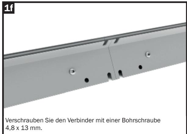
Verschrauben Sie den Verbinder mit einer Bohrschraube 4,8 x 13 mm.
