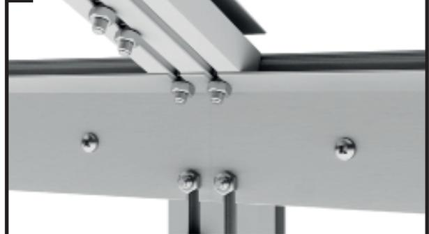
Führen Sie jeweils eine Schraube M6x12 in den Schraubkanal und verschrauben Sie das Koppelprofil fest mit der Regenrinne.
