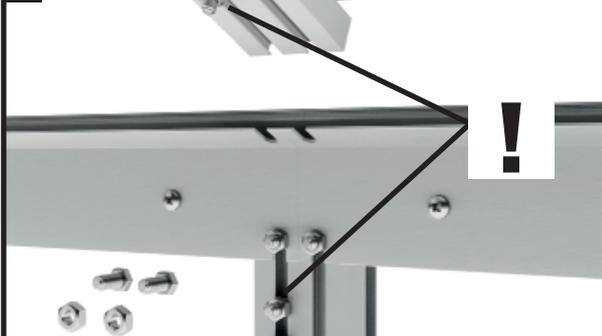
Führen Sie zwei Schrauben M6x12 in den linken Schraubkanal und sichern Sie diese mit Muttern M6 vor dem Verrutschen.
