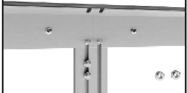
Introduce un tornillo M6x12 en cada uno de los canales de atornillado en el perfil de acoplamiento.
