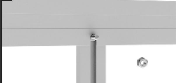
Introduce el tornillo M6x12 en el canal de atornillado del puntal. Coloca el puntal en el refuerzo transversal y guía el tornillo en el orificio perforado en el refuerzo transversal para atornillar.
