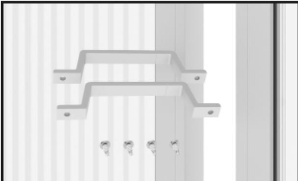
Prepara los tiradores y los tornillos autoperforantes de 4,8 x 13 mm.
