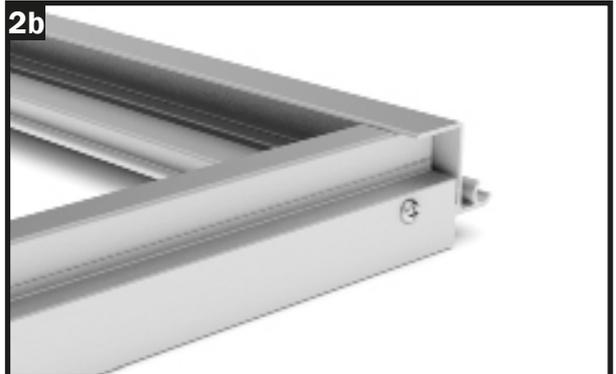
Inserta el perfil lateral de la ventana en el perfil de la bisagra y atorníllalo con el tornillo de cabeza plana de 4,2 x 22 mm.
