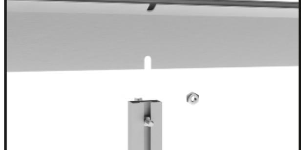
Introduce un tornillo M6x12 en el canal de atornillado del puntal.
