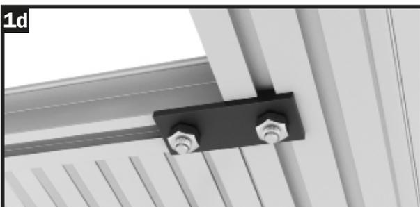
Empuja el perfil de tope de la ventana hacia abajo hasta tocar contra la placa alveolar y atornilla firmemente el conector de plástico con las tuercas M6.
