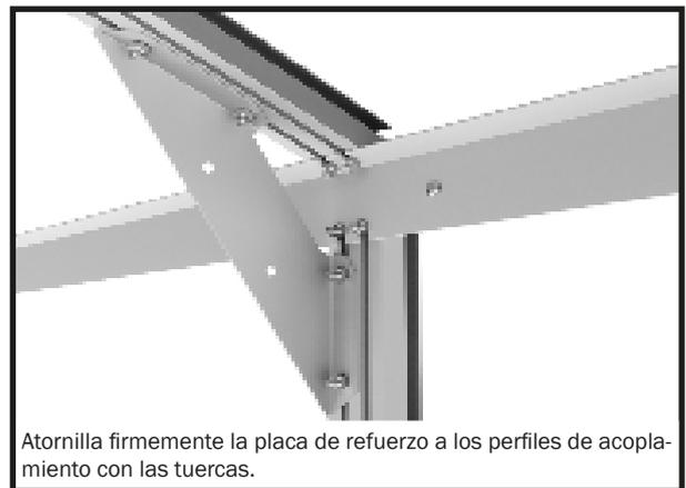
Atornilla firmemente la placa de refuerzo a los perfiles de acoplamiento con las tuercas.
