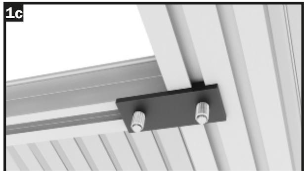
Coge un tornillo romboidal e insértalo en el canal de atornillado del puntal de techo y gíralo. Coloca el conector de plástico.
