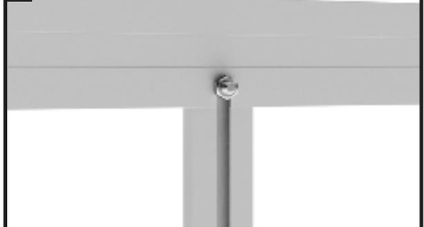
Atornilla firmemente el puntal con una tuerca M6 con el refuerzo transversal.
