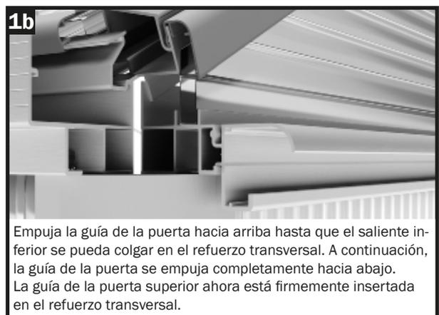
Empuja la guía de la puerta hacia arriba hasta que el saliente inferior se pueda colgar en el refuerzo transversal. A continuación, la guía de la puerta se empuja completamente hacia abajo. La guía de la puerta superior ahora está firmemente insertada en el refuerzo transversal.
