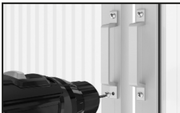
Przymocować klamki za pomocą wkrętów samowierzących 4,8x13 mm
