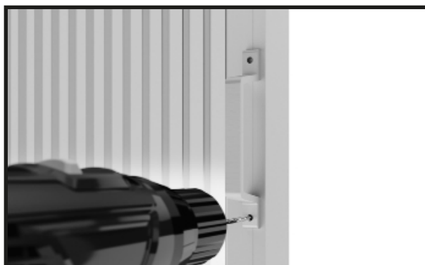
Wywiercić otwory wiertłem 4 mm.
