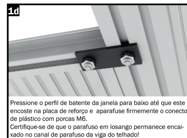
Insira um parafuso M6x12 mm no canal de aparafusamento de cada lado do perfil de batente. Encaixe o perfil de batente da janela na placa alveolar já colocada.
