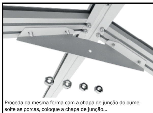
Retire as porcas dos parafusos inseridos nos perfis de ligação, posicione os parafusos de acordo com os orifícios na chapa de ligação e coloque-a no lugar.
