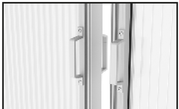
Att fästa de inre och yttre dörrhandtagen slutför monteringen av dörren.
