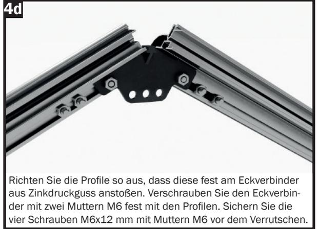
Richten Sie die Profile so aus, dass diese fest am Eckverbinder aus Zinkdruckguss anstoßen. Verschrauben Sie den Eckverbinder mit zwei Muttern M6 fest mit den Profilen. Sichern Sie die vier Schrauben M6x12 mm mit Muttern M6 vor dem Verrutschen.
