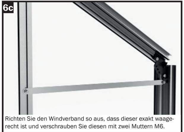
Richten Sie den Windverband so aus, dass dieser exakt waagrecht ist und verschrauben Sie diesen mit zwei Muttern M6.
