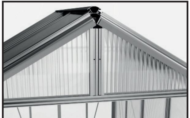
Setzen Sie die beiden Klemmleisten auf die Dachstütze auf.
