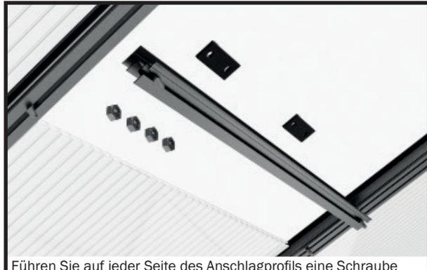
Führen Sie auf jeder Seite des Anschlagprofils eine Schraube M6x12 mm in den Schraubkanal ein. Setzen Sie je eine Rhombusschraube in den Schraubkanal der Dachstrebe ein.
