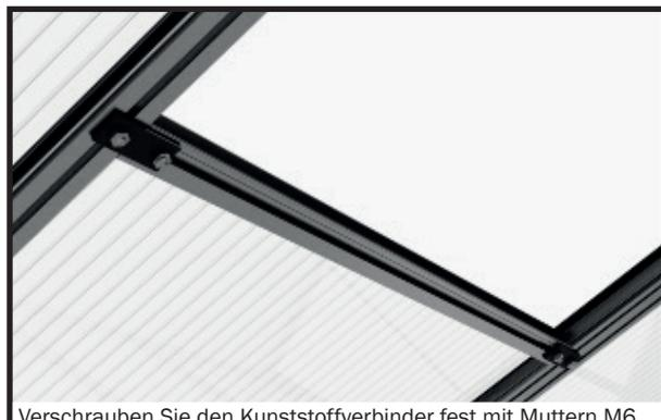
Verschrauben Sie den Kunststoffverbinder fest mit Muttern M6. Achten Sie darauf, dass sich dabei die Rhombusschraube im Schraubkanal der Dachstrebe verkeilt!
