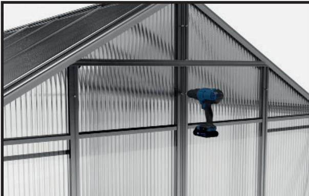
Verschrauben Sie die Leisten fest mit Schrauben 3,9x13 mm mit den Streben der Rückwand.
