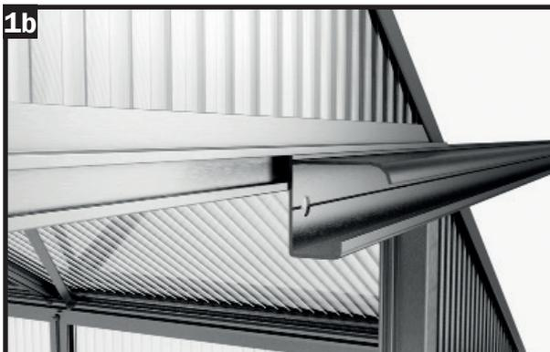
Führen Sie die Türlaufschiene bis zur Mitte der Türöffnung in das Querprofil ein.
