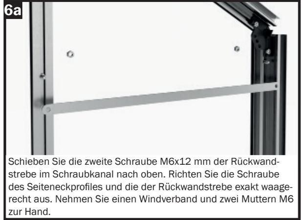
Schieben Sie die zweite Schraube M6x12 mm der Rückwandstrebe im Schraubkanal nach oben. Richten Sie die Schraube des Seiteneckprofils und die der Rückwandstrebe exakt waagrecht aus. Nehmen Sie einen Windverband und zwei Muttern M6 zur Hand.
