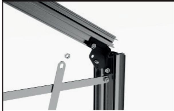
Führen Sie die Schraube M6x12 mm von außen durch das mittlere Loch des Eckverbinders aus Zinkdruckguss.
