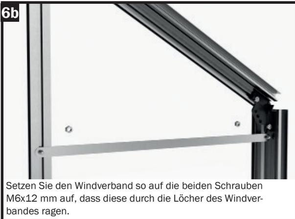
Setzen Sie den Windverband so auf die beiden Schrauben M6x12 mm auf, dass diese durch die Löcher des Windverbandes ragen.
