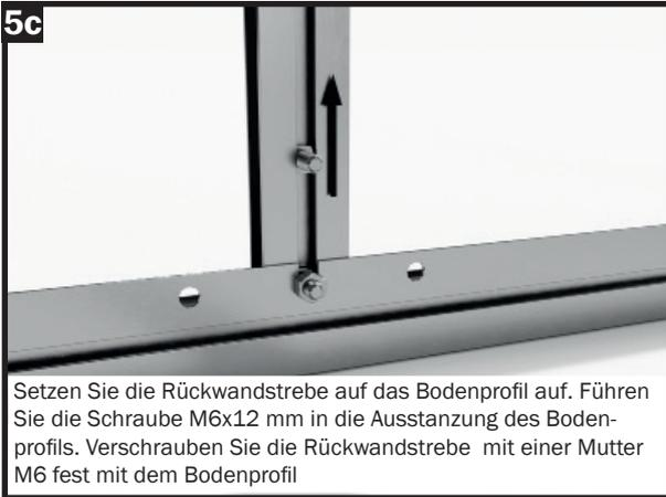
Setzen Sie die Rückwandstrebe auf das Bodenprofil auf. Führen Sie die Schraube M6x12 mm in die Ausstanzung des Bodenprofils. Verschrauben Sie die Rückwandstrebe mit einer Mutter M6 fest mit dem Bodenprofil
