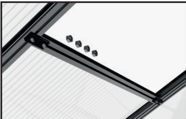
Setzen Sie das Fensteranschlagprofil ein und drücken Sie dieses so weit nach unten, dass es fest gegen die Stegplatte anstößt.
