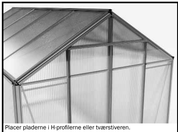
Indsæt de to plader i midten af gavltrekanen. For at gøre dette skal du føre pladen nedfra ind i tværstiverens rille foroven, og derefter trykkes pladen mod stiverne i bagvæggen. Herefter presser pladerne nedad, så de sider fast i H-profilerne.
