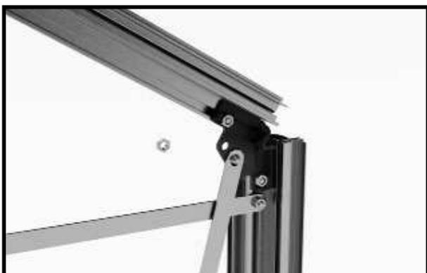
Placez la barre sur la vis M6x12 mm de manière à ce que la vis dépasse par le trou de passage.
