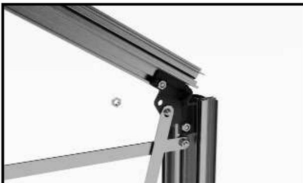
Placez la barre sur la vis M6x12 mm de manière à ce que la vis dépasse par le trou de passage.
