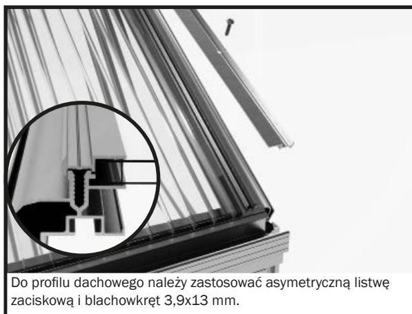
Umieścić listwę dociskową asymetrycznie na bocznym profilu narożnym. UWAGA: profil narożny boczny i listwa zaciskowa muszą mieć tę samą długość.
