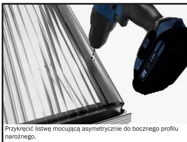
Do profilu dachowego należy zastosować asymetryczną listwę zaciskową i blachowkręt 3,9x13 mm.
