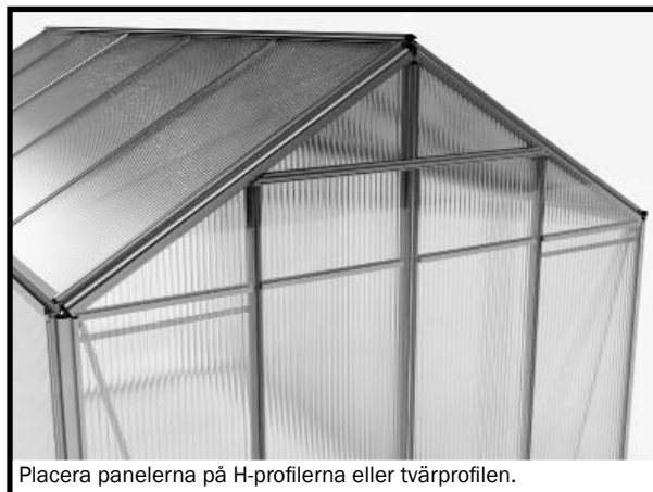
Sätt in de två panelerna i bakpanelen. För att göra detta, styr denna underifrån in i skåran på tvärprofilen och tryck sedan panelen mot den bakre väggens stag. Sedan trycker de ner panelerna så att de vilar stadigt på H-profilerna.
