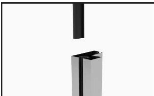
Inserire la guarnizione della porta nell'apposita scanalatura del profilo laterale.
