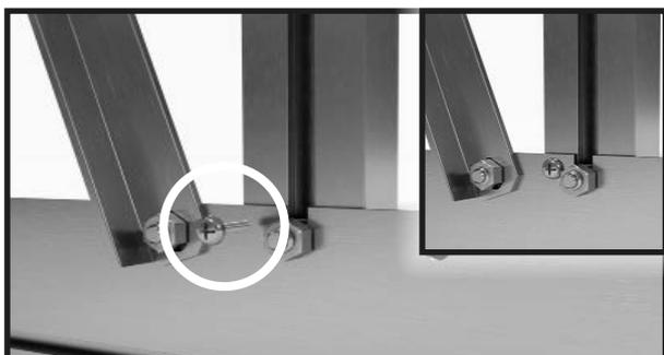
Continuare con il profilo di ingresso della porta e il profilo del pavimento. Avvitare il profilo di ingresso della porta e il profilo del pavimento con la vite perforante da 4,8x13 mm.
