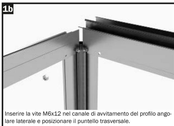
Inserire la vite M6x12 nel canale di avvitamento del profilo angolare laterale e posizionare il puntello trasversale.
