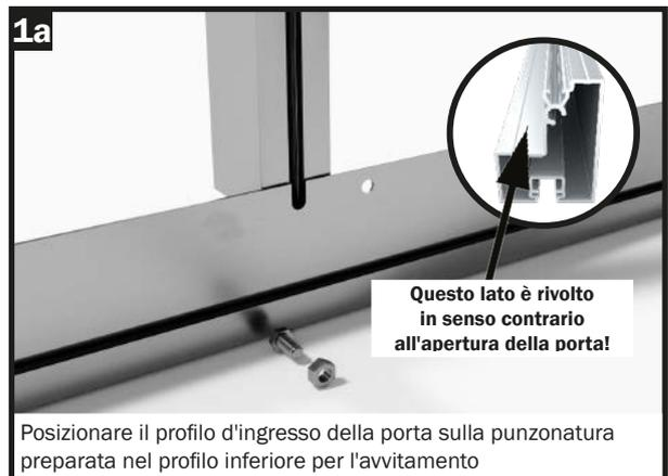
Posizionare il profilo d'ingresso della porta sulla punzonatura preparata nel profilo inferiore per l'avvitamento
