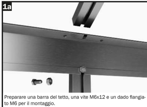
Preparare una barra del tetto, una vite M6x12 e un dado flangiato M6 per il montaggio.
