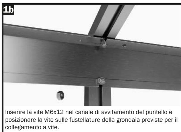
Inserire la vite M6x12 nel canale di avvitamento del puntello e posizionare la vite sulle fustellature della grondaia previste per il collegamento a vite.
