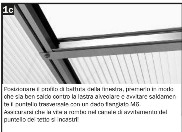
Posizionare il profilo di battuta della finestra, premerlo in modo che sia ben saldo contro la lastra alveolare e avvitare saldamente il puntello trasversale con un dado flangiato M6. Assicurarsi che la vite a rombo nel canale di avvitamento del puntello del tetto si incastrì!
