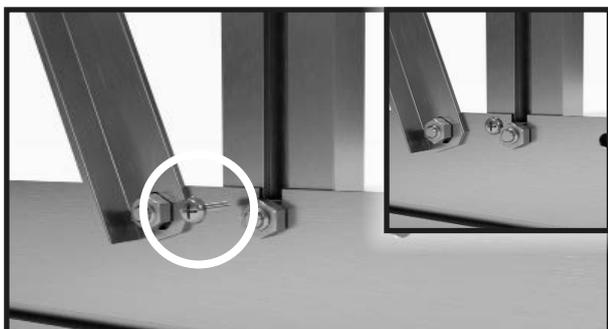
Continuare con il profilo del pavimento e i puntelli della parete. Avvitare il profilo del pavimento e i puntelli della parete con la vite perforante da 4,8x13 mm.
