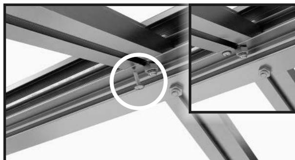
Continuare con il colmo e i puntelli del tetto. Avvitare il colmo e i puntelli del tetto con la vite perforante da 4,8x13 mm.
