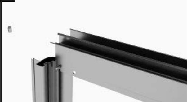
Inserire la vite M6x12 nel canale di avvitamento del profilo angolare laterale e applicare la grondaia.
