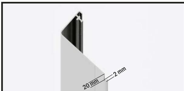
Prima di poter inserire il profilo del labbro di tenuta, nella parte superiore viene limata con una lima una nervatura dell'altezza di 20 mm. Rimuovere 2 mm di materiale dal profilo del labbro di tenuta, in modo da garantire che il profilo non si scontri con il puntone trasversale.
