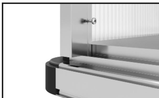
Prendere una vite perforante 4,8x13 mm.
