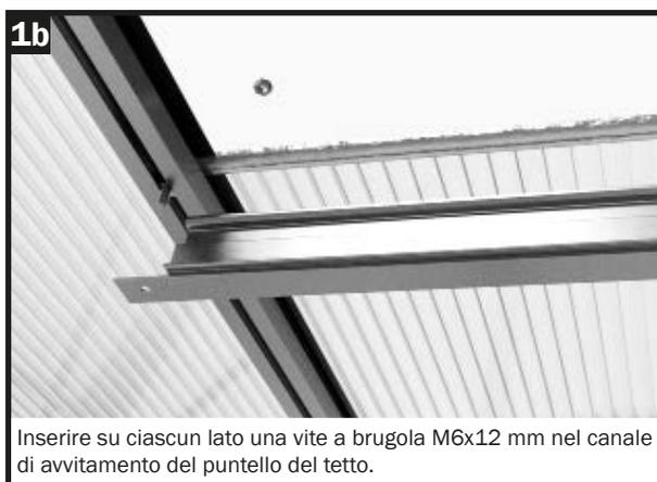
Inserire su ciascun lato una vite a brugola M6x12 mm nel canale di avvitamento del puntello del tetto.
