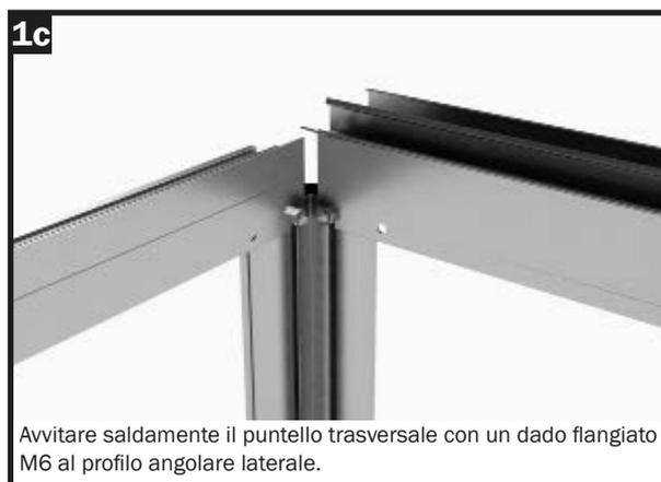
Avvitare saldamente il puntello trasversale con un dado flangiato M6 al profilo angolare laterale.
