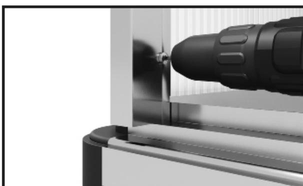
Avvitare il profilo del labbro di tenuta al profilo d'angolo laterale.
