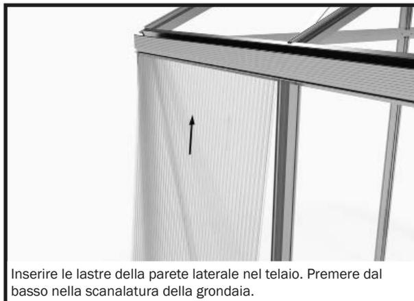
Inserire le lastre della parete laterale nel telaio. Premere dal basso nella scanalatura della grondaia.
