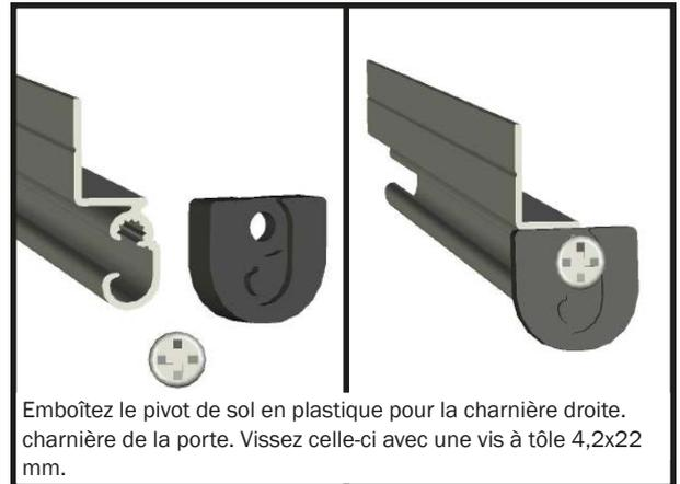
Emboîtez le pivot de sol en plastique pour la charnière droite. Vissez celle-ci avec une vis à tôle 4,2x22 mm.
