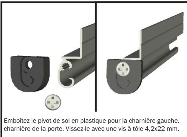
Emboîtez le pivot de sol en plastique pour la charnière gauche. Vissez-le avec une vis à tôle 4,2x22 mm.
