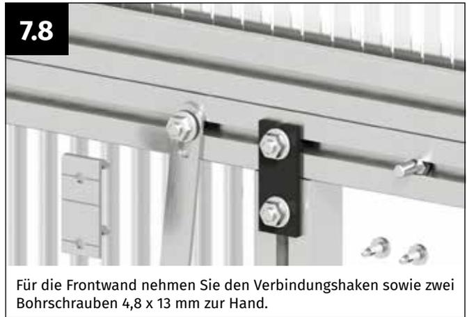
**7.8** Für die Frontwand nehmen Sie den Verbindungshaken sowie zwei Bohrschrauben 4,8 x 13 mm zur Hand.
