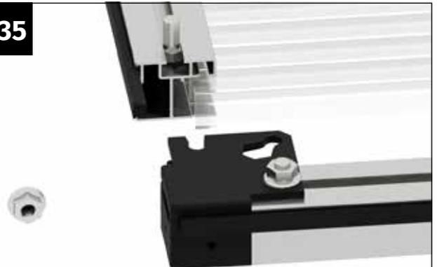
Führen Sie an jeder Seite die Schraube M6x12 in den Schraubenkanal der Türprofile ein.
