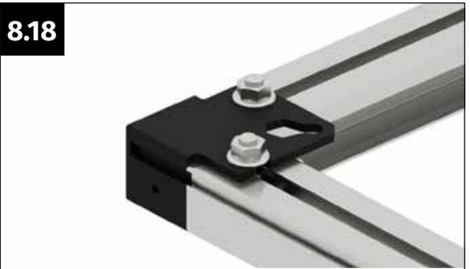
Drücken Sie das Türprofil fest gegen den Eckverbinder und verschrauben Sie es fest mit der Flanschmutter M6.
