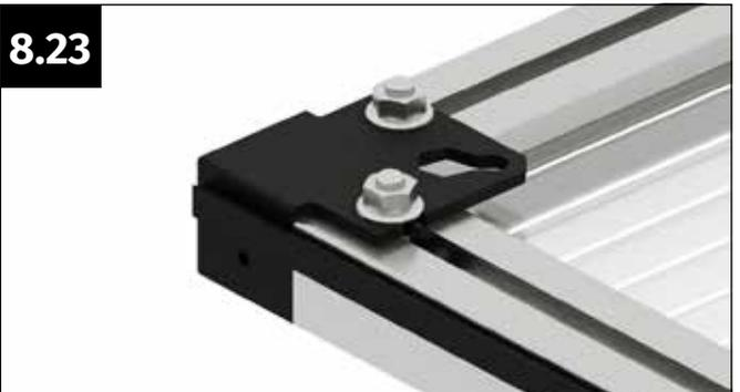
Schieben Sie die Bürstendichtung so weit ein, bis sie in der Ausformung des Eckverbinders an der anderen Seite des Türprofils anstößt.
