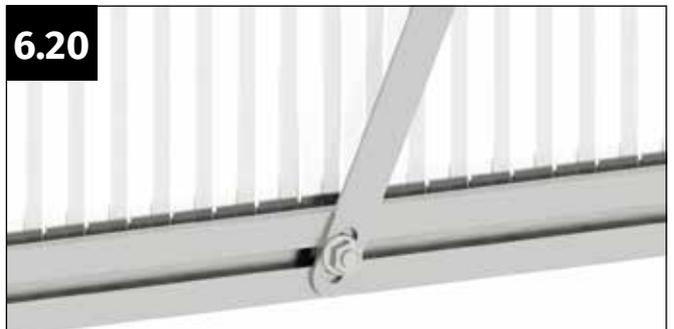
Setzen Sie den Windverband so auf die Schraube M6x12 mm auf, dass diese durch das ausgestanzte Loch des Windverbandes ragt. Verschrauben Sie den Windverband locker mit einer Flanschnutter M6.
