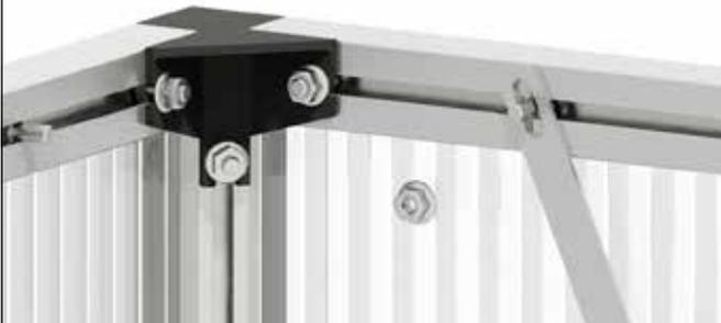
Setzen Sie den Windverband so auf die Schraube M6x12 mm auf, dass diese durch das ausgestanzte Loch des Windverbandes ragt.
