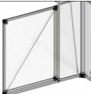
Im nächsten Schritt wird am Türflügel eine Diagonalversteifung montiert, die verhindert, dass der Türflügel im laufenden Gebrauch zu hängen beginnt und die Tür damit nicht mehr ordentlich geschlossen werden kann.
