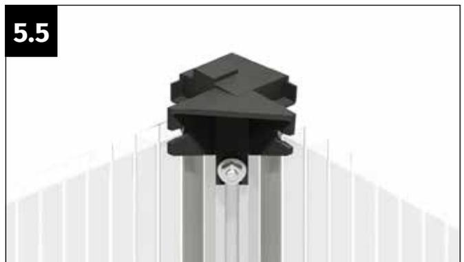
Setzen Sie den Eckwinkel auf das Eckprofil auf und positionieren Sie die Schraube M6x12 in dessen Ausnehmung.
