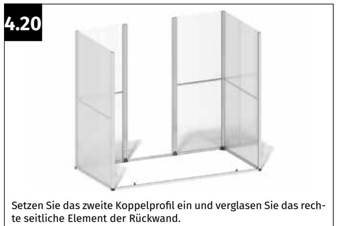
Setzen Sie das zweite Koppelprofil ein und verglasen Sie das rechte seitliche Element der Rückwand.
