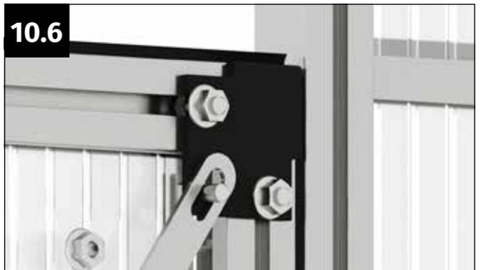
Setzen Sie den Diagonalverbinder so auf, dass die Schraube M6x12 mm durch das Langloch des Verbinders ragt.
