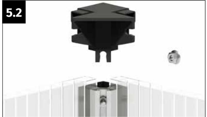
Führen Sie die Schraube M6x12 mm in den Schraubkanal des Eckprofils ein.
