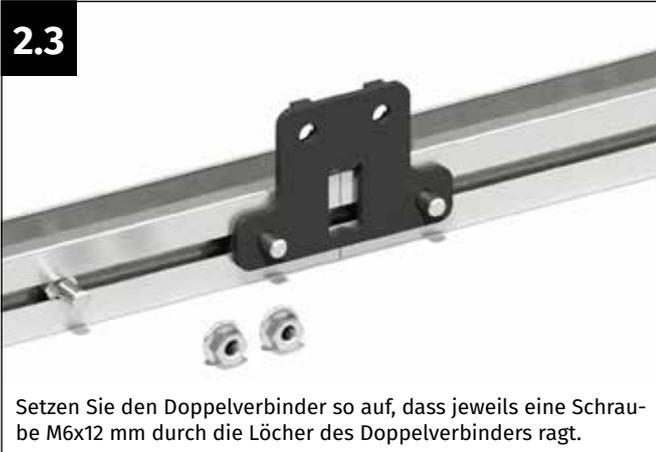
Setzen Sie den Doppelverbinder so auf, dass jeweils eine Schraube M6x12 mm durch die Löcher des Doppelverbinders ragt.
