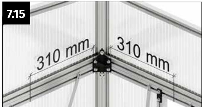
Messen Sie in der Ecke jeweils am oberen Profil der Front- und der Seitenwand vom Ende des Eckknotens 310 mm nach innen und setzen Sie hier eine Markierung.
