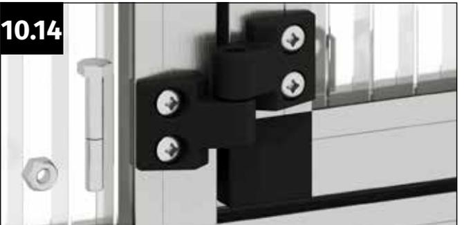
Nehmen Sie eine Schraube M6x40 mm und eine selbstsichernde Mutter M6 zur Hand. Setzen Sie den Türflügel so auf die Scharniere des Tomatenhauses auf, dass die Löcher exakt übereinander liegen.
