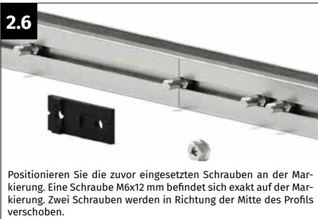
Positionieren Sie die zuvor eingesetzten Schrauben an der Markierung. Eine Schraube M6x12 mm befindet sich exakt auf der Markierung. Zwei Schrauben werden in Richtung der Mitte des Profils verschoben.
