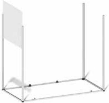
Nehmen Sie die Stegplatten zur Verglasung der Seitenwand (980x860 mm) zur Hand.
