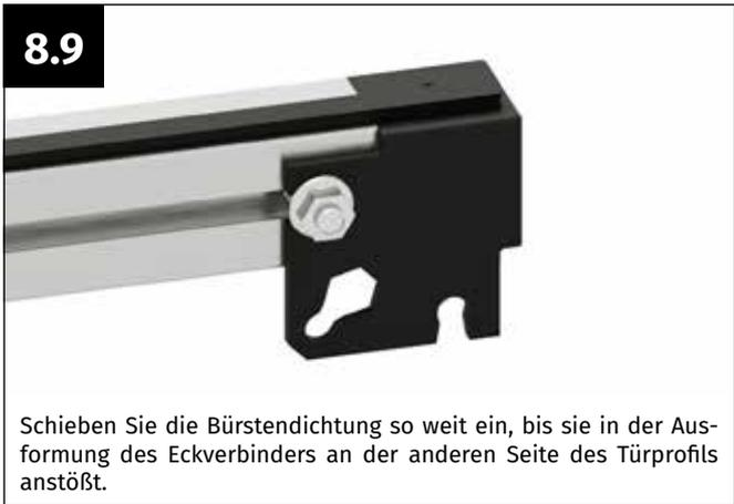
Schieben Sie die Bürstendichtung so weit ein, bis sie in der Ausformung des Eckverbinders an der anderen Seite des Türprofils anstößt.
