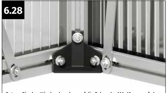
Setzen Sie den Windverband so auf die Schraube M6x12 mm auf, dass diese durch das ausgestanzte Loch des Windverbandes ragt. Verschrauben Sie den Windverband locker mit einer Flanschmutter M6.
