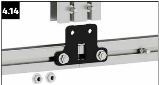
Führen Sie jeweils eine Schraube M6x12 mm in jeden der beiden Schraubkanäle des Mittelprofils ein.
