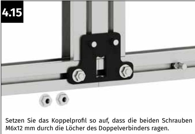
Setzen Sie das Koppelprofil so auf, dass die beiden Schrauben M6x12 mm durch die Löcher des Doppelverbinders ragen.
