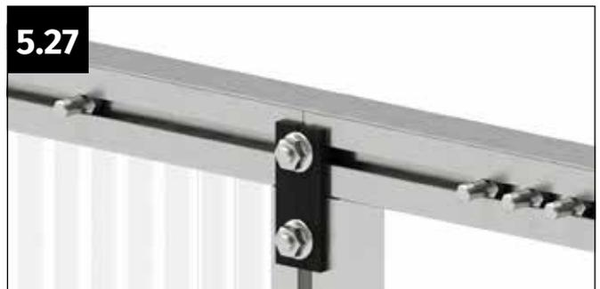
Richten Sie den Verbinder Gerade so aus, dass die V-Markierung in der Mitte des Verbinders exakt auf die angebrachte Markierung zeigt. Verschrauben Sie den Verbinder fest mit zwei Flanschmuttern M6.
