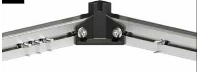
Kontrollieren Sie, dass die Bodenprofile fest gegen den unteren Eckwinkel stoßen, und verschrauben Sie die Bodenprofile fest mit den Flanschmuttern M6.
