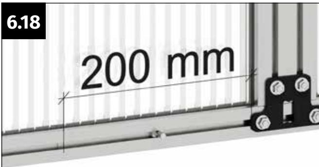
Messen Sie am unteren Profil 200 mm vom Doppelverbinder nach innen und setzen Sie hier eine Markierung.
