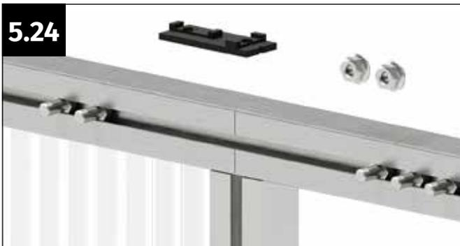
Als nächstes werden auch die Türeingangsprofile der Frontwand an der Oberseite verschraubt. Nehmen Sie dafür einen Verbinder Gerade (Teil-Nr. PQS38) und zwei Flanschmutter M6 zur Hand.
