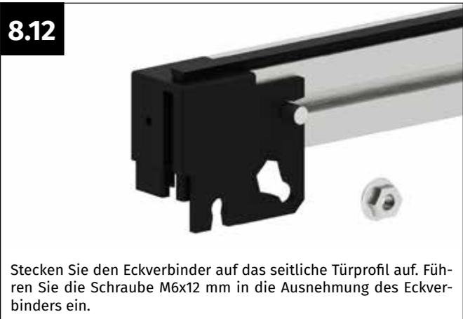
Stecken Sie den Eckverbinder auf das seitliche Türprofil auf. Führen Sie die Schraube M6x12 mm in die Ausnehmung des Eckverbinders ein.
