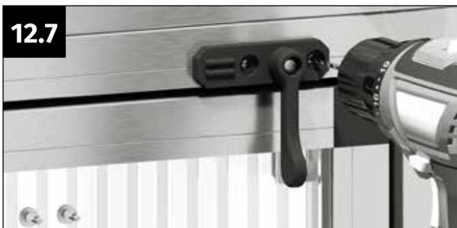
Positionieren Sie den Türriegel am oberen Profil des Tomatenhauses so, dass das Ende des Türriegels etwas neben dem Eckverbinder des Türflügels positioniert ist. Bohren Sie die Löcher mit einem Bohrer 4 mm vor.
