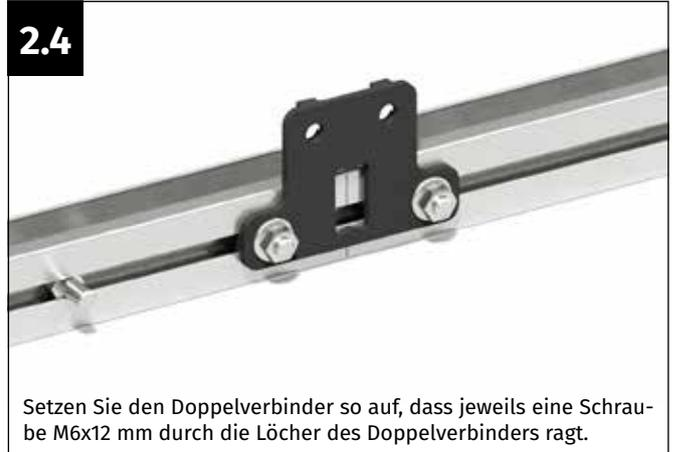
Setzen Sie den Doppelverbinder so auf, dass jeweils eine Schraube M6x12 mm durch die Löcher des Doppelverbinders ragt.
