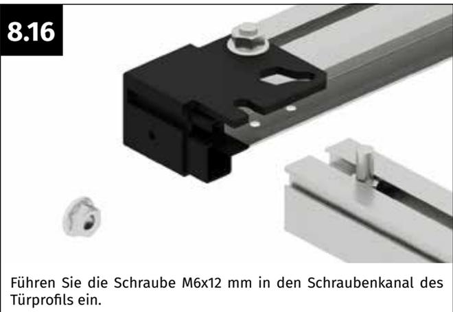
Führen Sie die Schraube M6x12 mm in den Schraubenkanal des Türprofils ein.
