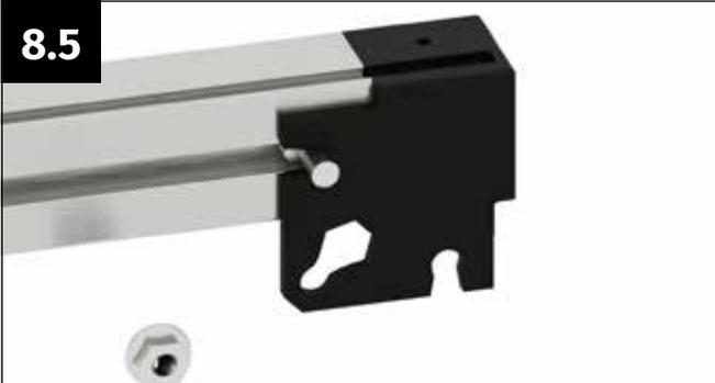
Stecken Sie den Eckverbinder auf das seitliche Türprofil auf. Führen Sie eine Schraube M6x12 mm in die Ausnehmung des Eckverbinders ein.
