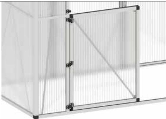
Im nächsten Schritt wird der Türflügel am Tomatenhaus montiert.
