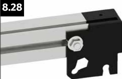
Drücken Sie den Eckverbinder fest gegen das seitliche Türprofil und verschrauben Sie ihn fest mit der Flanschmutter M6.
