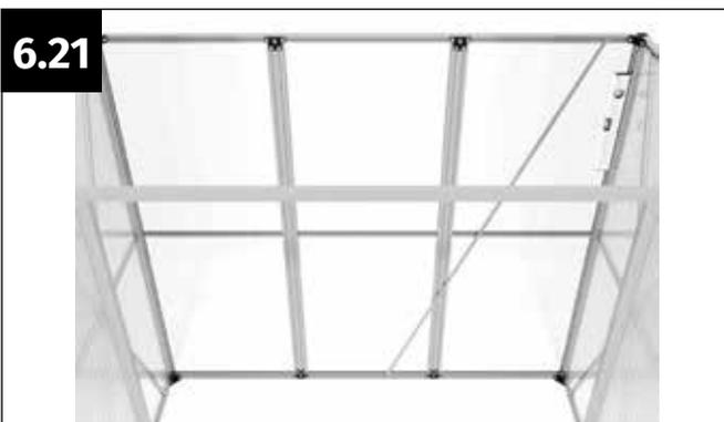
Richten Sie die Rückwand exakt im Lot aus und ziehen Sie anschließend die Flanschnutter M6 fest.
