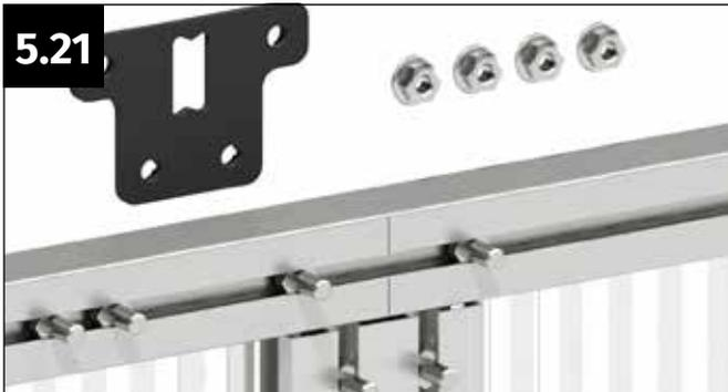
Positionieren Sie die zuvor eingeführten Schrauben an der Markierung am oberen Rahmenprofil. Achten Sie darauf, dass zwei Schrauben zwischen der Seitenwand und dem Koppelprofil frei bleiben.
