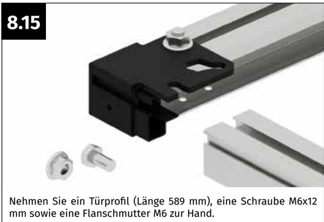
Nehmen Sie ein Türprofil (Länge 589 mm), eine Schraube M6x12 mm sowie eine Flanschmutter M6 zur Hand.
