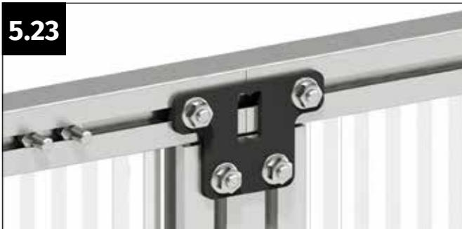
Richten Sie den Doppelverbinder so aus, dass die V-Markierung in der Mitte des Doppelverbinders exakt auf die angebrachte Markierung zeigt. Verschrauben Sie den Doppelverbinder fest mit vier Flanschmuttern M6.
