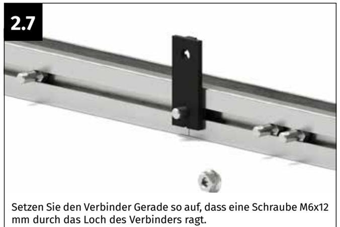
Setzen Sie den Verbinder Gerade so auf, dass eine Schraube M6x12 mm durch das Loch des Verbinders ragt.
