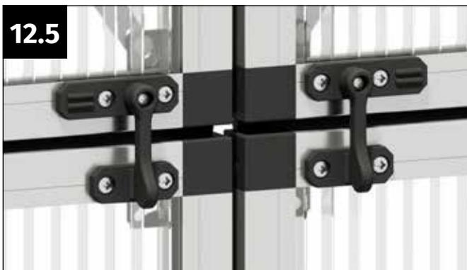
Als erstes werden die beiden Türriegel an der Oberseite der oberen Türflügel angebracht.
