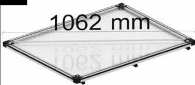
Richten Sie den Türflügel exakt im Winkel aus. Messen Sie dafür die Diagonalen - diese müssen jeweils exakt 1062 mm lang sein!
