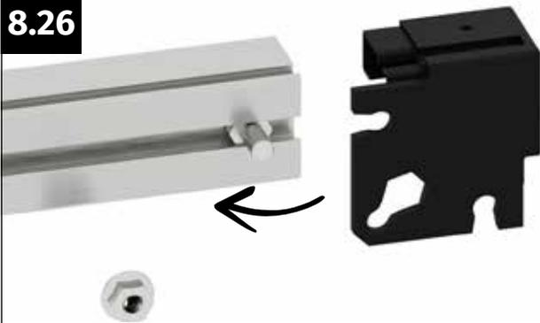
Führen Sie die Schraube M6x12 mm in den Schraubenkanal des seitlichen Türprofils ein.
