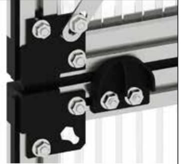
Setzen Sie den Türanschlag auf die Schrauben auf und richten Sie diesen so aus, dass er knapp neben dem Eckverbinder des Türflügels positioniert ist. Schrauben Sie den Türanschlag mit zwei Flanschnuttern M6 fest.
