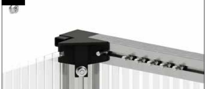
Stecken Sie das vordere Rahmenprofil auf den Eckwinkel auf und positionieren Sie eine Schraube M6x12 mm in dessen Ausnehmung.
