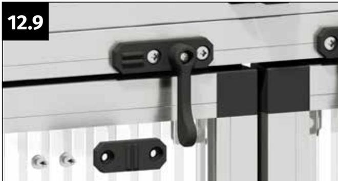
Unter dem Türriegel wird nun die Einrastplatte angebracht. Nehmen Sie die Türriegel-Einrastplatte (Teil Nr. 2320) sowie zwei Bohrschrauben 4,8x13 mm zur Hand.
