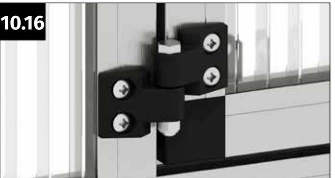
Sichern Sie die Schraube M6x40 mm mit einer selbstsichernden Mutter. Hinweis: Die Mutter wird nicht fest angezogen, da sich ansonsten der Türflügel nicht mehr drehen lässt.
