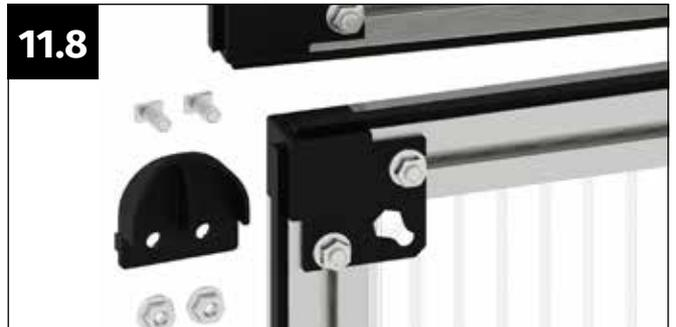
Zuletzt wird auch noch mittig bei den beiden Türflügeln am unteren Flügel ein Türanschlag montiert. Nehmen Sie dazu einen Türanschlag, zwei Rhombusschrauben und zwei Flanschmutter M6 zur Hand.
