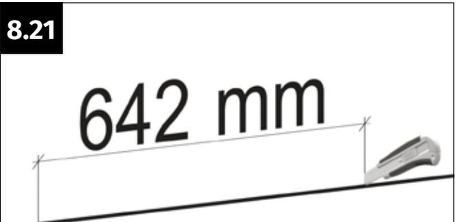
Schneiden Sie mit einem Teppichmesser zwei Stück Bürstendichtungen mit einer Länge von 642 mm zu.
