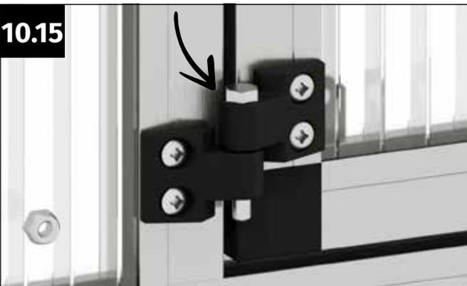
Stecken Sie die Schraube M6x40 mm durch die Löcher der Scharniere.
