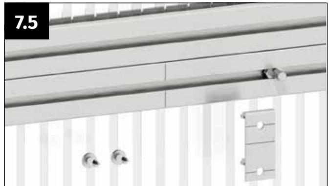
Nehmen Sie den Verbindungshaken sowie zwei Bohrschrauben 4,8 x 13 mm zur Hand.
