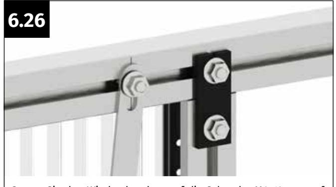
Setzen Sie den Windverband so auf die Schraube M6x12 mm auf, dass diese durch das ausgestanzte Loch des Windverbandes ragt. Verschrauben Sie den Windverband mit einer Flanschmutter M6.
