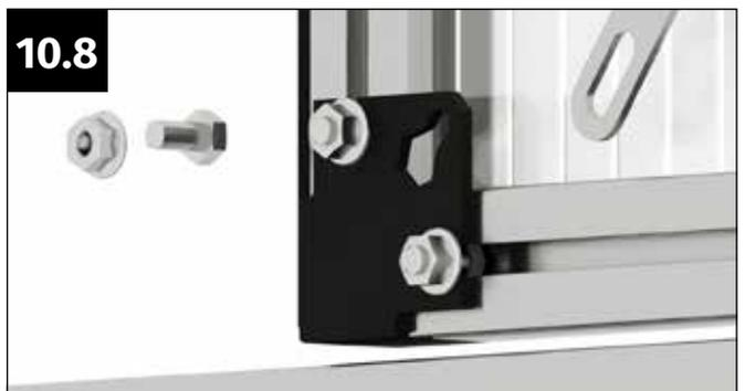
Für die Verschraubung des Querverbinders am Kunststoffverbinder diagonal gegenüber, nehmen Sie eine Schraube M6x12 mm und eine Flanschnutter M6 zur Hand.
