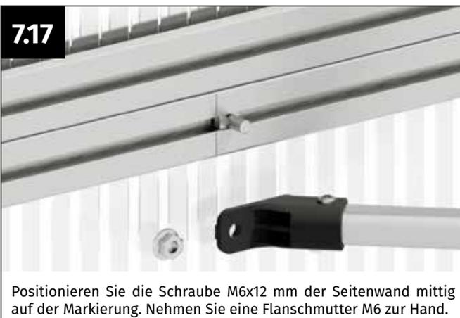
Positionieren Sie die Schraube M6x12 mm der Seitenwand mittig auf der Markierung. Nehmen Sie eine Flanschmutter M6 zur Hand.
