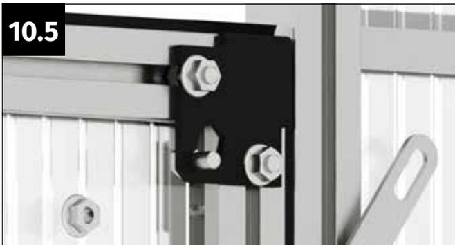
Führen Sie die Schraube M6x12 mm durch das Loch des Eckverbinders und drücken Sie die Schraube nach unten in ihre endgültige Position.
