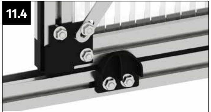
Richten Sie den Türanschlag so aus, dass dieser knapp neben dem Eckverbinder des Türflügels positioniert ist. Schrauben Sie den Türanschlag fest mit zwei Flanschmutter M6.
