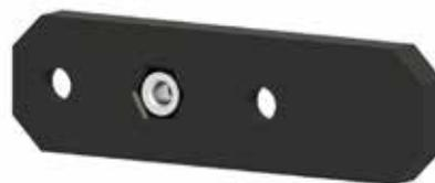
Stecken Sie die selbstsichernde Mutter M4 in die dafür vorgesehene Ausnehmung der Türriegel-Montageplatte. Der blaue Ring der Mutter zeigt dabei nach hinten.
