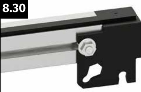
Führen Sie die Bürstendichtung an der Außenseite in das seitliche Türprofil ein. Schieben Sie die Bürstendichtung so weit ein, bis sie in der Ausformung des Eckverbinders an der anderen Seite des Türprofils anstößt.
