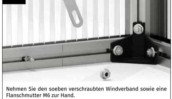
Nehmen Sie den soeben verschraubten Windverband sowie eine Flanschmutter M6 zur Hand.
