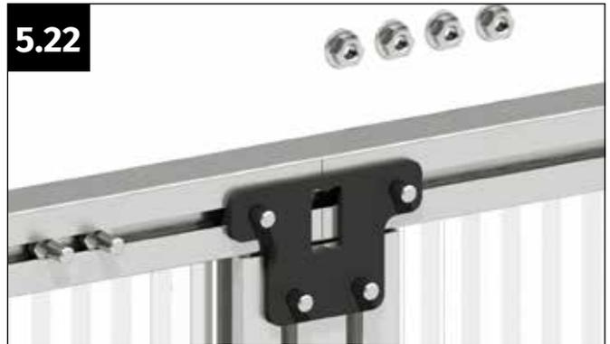
Setzen Sie den Doppelverbinder so auf, dass jeweils eine Schraube M6x12 mm durch die Löcher des Doppelverbinders ragt.
