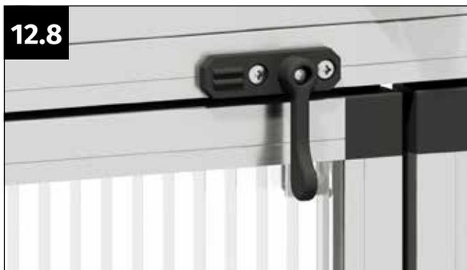
Verschrauben Sie den Türriegel mit den beiden selbstbohrenden Schrauben 4,8x13 mm.
