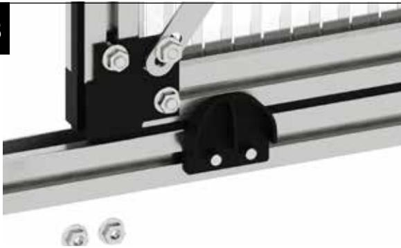
Setzen Sie den Türanschlag so auf das Bodenprofil auf, dass die beiden Schrauben M6x12 mm durch die Löcher des Türanschlages ragen.
