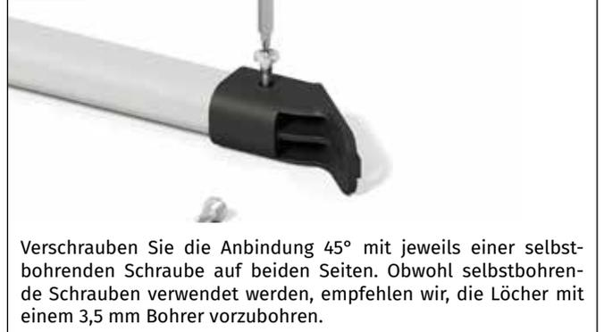
Verschrauben Sie die Anbindung 45° mit jeweils einer selbstbohrenden Schraube auf beiden Seiten. Obwohl selbstbohrende Schrauben verwendet werden, empfehlen wir, die Löcher mit einem 3,5 mm Bohrer vorzubohren.
