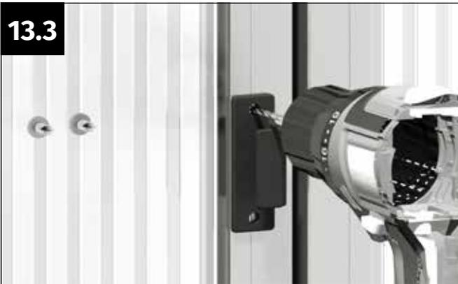
Bohren Sie die Löcher mit einem Bohrer 4 mm vor.
