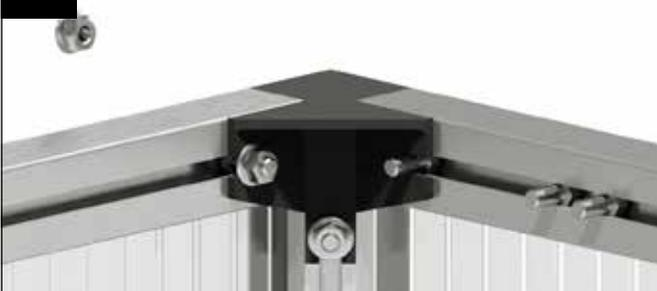
Stecken Sie das vordere Rahmenprofil auf den Eckwinkel auf und positionieren Sie eine Schraube M6x12 mm in dessen Ausnehmung.
