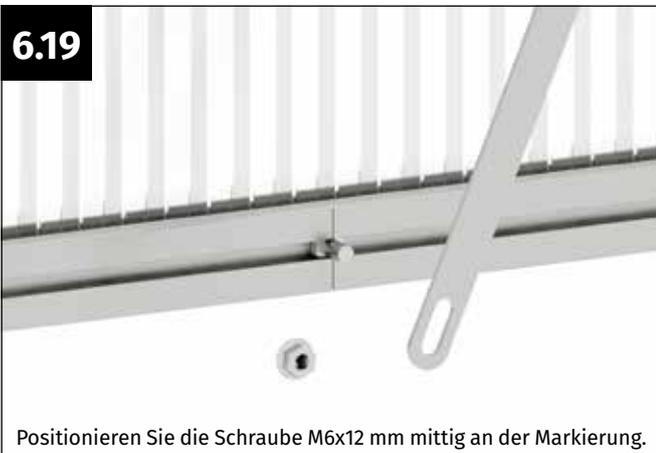
Positionieren Sie die Schraube M6x12 mm mittig an der Markierung.
