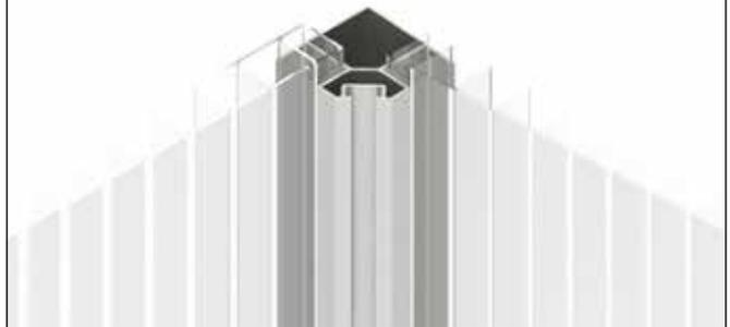
Kontrollieren Sie, dass die Stegplatte nur noch wenige Millimeter aus dem Eckprofil herausragt.
