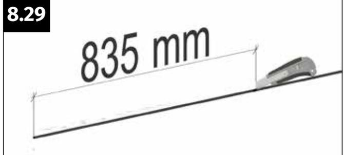
Schneiden Sie mit einem Teppichmesser ein Stück Bürstendichtung mit einer Länge von 835 mm zu.
