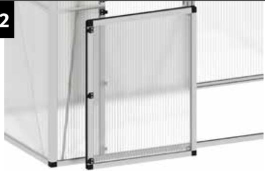
Stellen Sie den Türflügel an die richtige Position und achten Sie darauf, dass die Scharniere in Richtung des Türingangsprofils zeigen.
