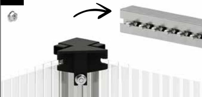
Führen Sie die sechs Schrauben M6x12 mm in den Schraubkanal des vorderen Auflageprofils ein.
