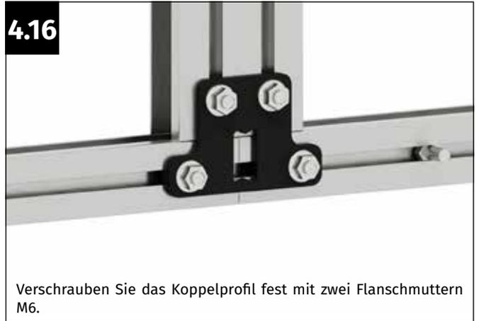
Verschrauben Sie das Koppelprofil fest mit zwei Flanschnuttern M6.
