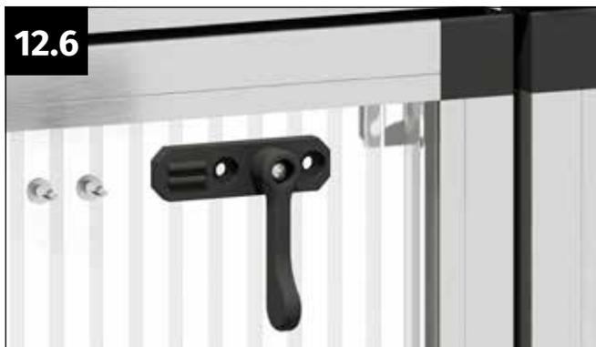
Nehmen Sie den vorbereiteten Türriegel sowie zwei selbstbohrende Blechschrauben 4,8x13 mm zur Hand.
