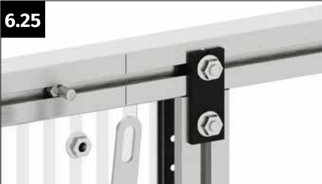
Nehmen Sie einen Windverband der Frontwand (Länge 1765 mm) sowie eine Flanschmutter M6 zur Hand.
