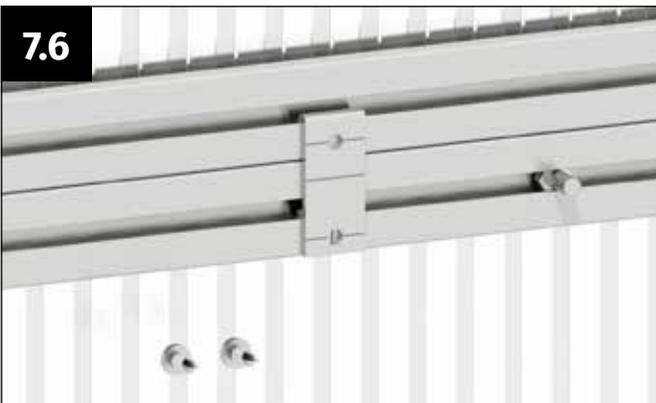
Positionieren Sie den Verbindungshaken mittig auf der Markierung.
