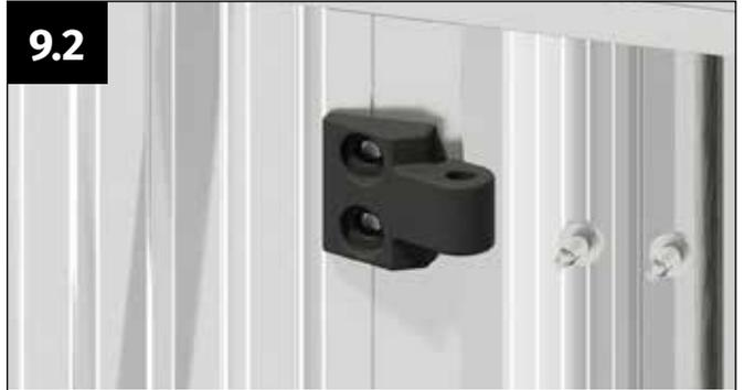
Setzen Sie das Scharnier auf das Türeingangsprofil so auf, dass die Löcher des Scharniers über den Löchern des Türeingangsprofils liegen.
