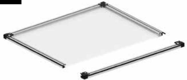
Im nächsten Schritt wird das seitliche Türprofil auf das obere und untere Türprofil aufgesteckt. Die folgenden Schritte erfolgen an beiden Seiten parallel.
