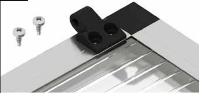
Setzen Sie das Scharnier auf das Türprofil so auf, dass die Löcher des Scharniers über den Löchern des Türprofils liegen.
