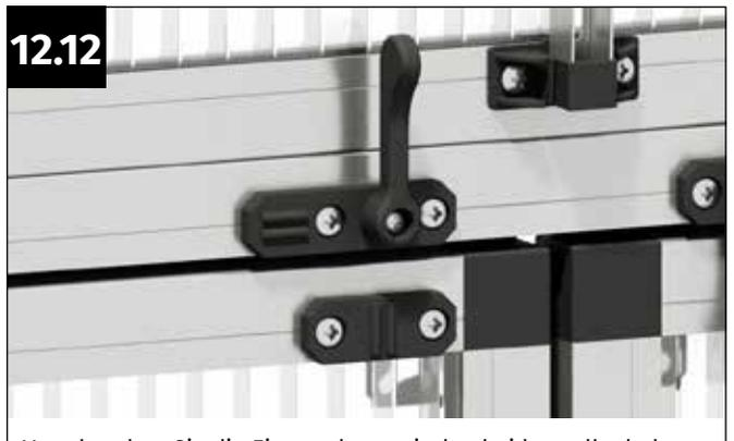
Verschrauben Sie die Einrastplatte mit den beiden selbstbohrenden Schrauben 4,8x13 mm.
