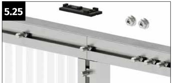
Positionieren Sie die Schrauben des oberen Rahmenprofils. Achten Sie darauf, dass dabei eine Schraube M6x12 mm zwischen der Seitenwand und dem Verbinder frei bleibt. An der Seite der Türöffnung bleiben zwei Schrauben M6x12 mm frei.
