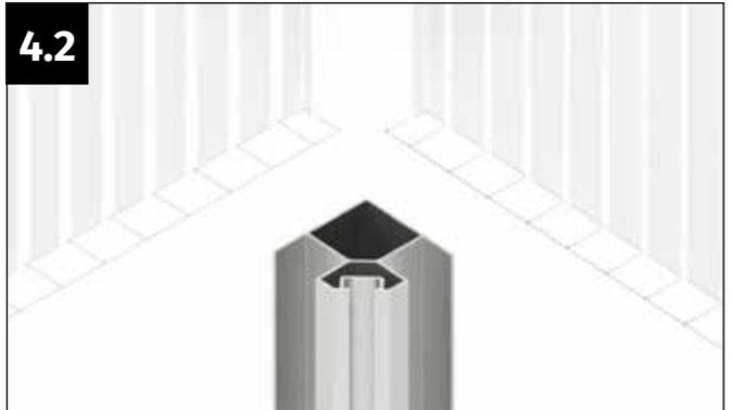
Führen Sie diese von oben in die dafür ausgeformten U-Nuten der Eckprofile ein.
