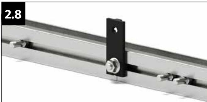
Richten Sie den Verbinder Gerade so aus, dass die V-Markierung in der Mitte des Verbinders exakt auf die angebrachte Markierung zeigt. Verschrauben Sie den Verbinder fest mit einer Flanschmutter M6.
