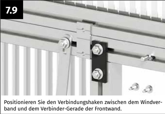
**7.9** Positionieren Sie den Verbindungshaken zwischen dem Windverband und dem Verbinder-Gerade der Frontwand.
