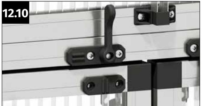
Drehen Sie den Rasthebel nach oben. Positionieren Sie die Einrastplatte so, dass die beiden Einrastkerben exakt unterhalb der Verschraubung des Rasthakens ist.
