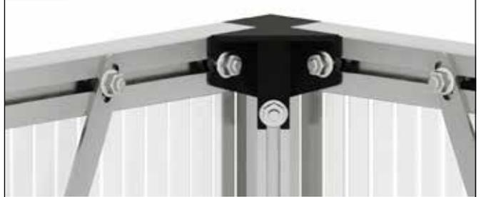
Setzen Sie den Windverband so auf die Schraube M6x12 mm auf, dass diese durch das ausgestanzte Loch des Windverbandes ragt. Verschrauben Sie den Windverband fest mit einer Flanschnutter M6.
