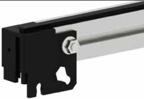
Führen Sie die Schraube M6x12 mm in den Schraubenkanal ein. Stecken Sie den Eckverbinder auf das Türprofil. Drücken Sie den Eckverbinder fest gegen das Türprofil und verschrauben Sie ihn mit einer Flanschmutter M6.
