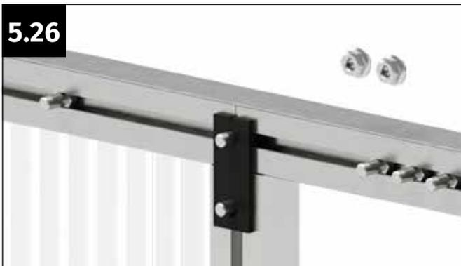
Setzen Sie den Verbinder Gerade so auf, dass jeweils eine Schraube M6x12 mm durch die Löcher des Verbinders ragt.
