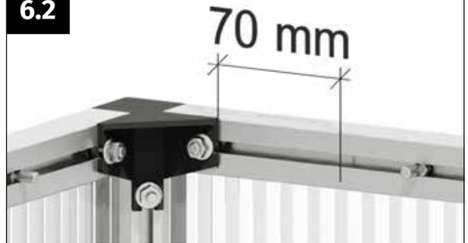
Messen Sie am oberen Profil 70 mm vom Eckverbinder nach innen und setzen Sie hier eine Markierung.
