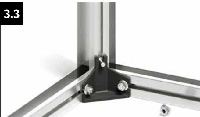
Setzen Sie das Eckprofil auf den unteren Eckwinkel auf und positionieren Sie die Schraube M6x12 mm in dessen Ausnehmung.
