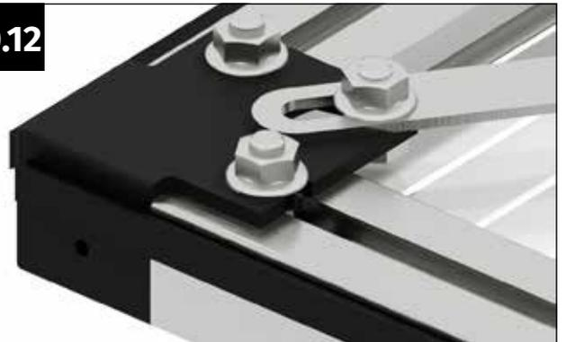
Ist der Türflügel exakt im Winkel ausgerichtet, ziehen Sie bitte die Flanschmuttern M6 an beiden Seiten fest an.
