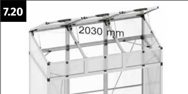
Richten Sie das Tomatenhaus aus, indem Sie die Diagonalen kontrollieren. Beide Diagonalen müssen exakt die gleiche Länge haben, dann steht die Konstruktion im Winkel. Die Diagonale muss 2030 mm betragen.
