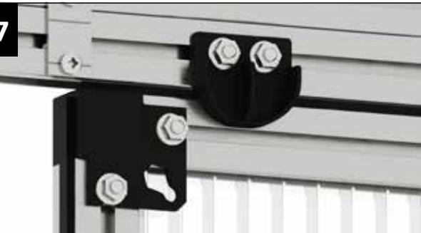
Setzen Sie den Türanschlag auf die Schrauben auf und richten Sie diesen so aus, dass er knapp neben dem Eckverbinder des Türflügels positioniert ist. Schrauben Sie den Türanschlag mit zwei Flanschmutter M6 fest.
