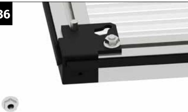
Stecken Sie das seitliche Türprofil mit den Kunststoffecken auf die Türprofile auf. Führen Sie jeweils eine Schraube M6x12 mm in die Ausnehmung der Kunststoffecke ein.
