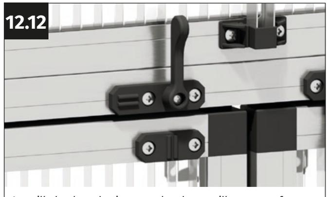
Atornilla la placa de cierre con los dos tornillos autoperforantes de 4,8x13 mm.
