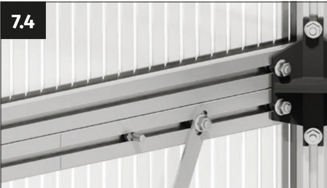
Coloca los tornillos restantes en la pared trasera, entre la protección contra el viento y la marca.
