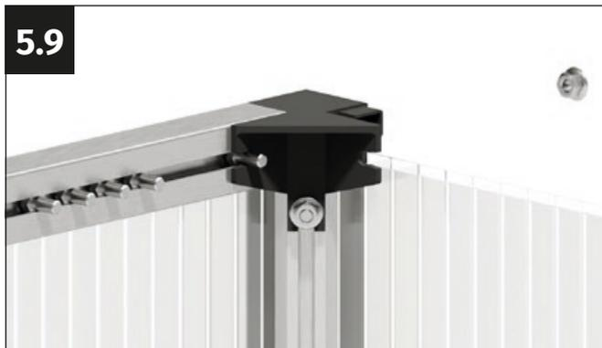
Empuja el perfil del marco sobre el soporte angular y coloca un tornillo M6x12 mm en su alojamiento
