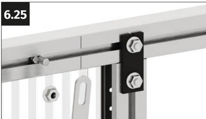
Coge una protección contra el viento de la pared frontal (longitud 1765 mm) y una tuerca con brida M6.
