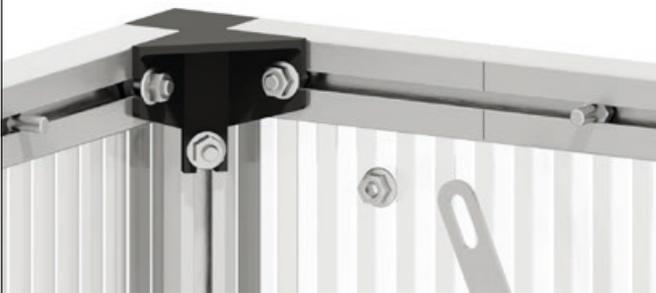
Coge una protección contra el viento de la pared lateral (longitud 1915 mm) y una tuerca con brida M6.
