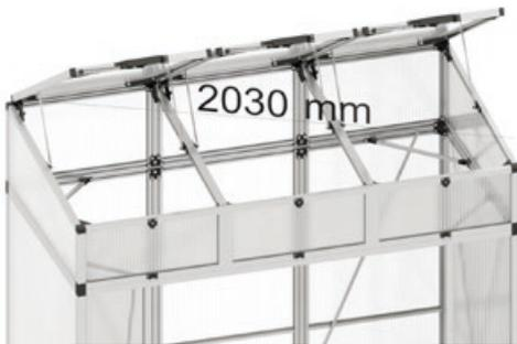
Alinea el invernadero comprobando las diagonales. Ambas diagonales deben tener exactamente la misma longitud. Sólo entonces la construcción estará en el ángulo correcto. La diagonal debe medir 2030 mm.
