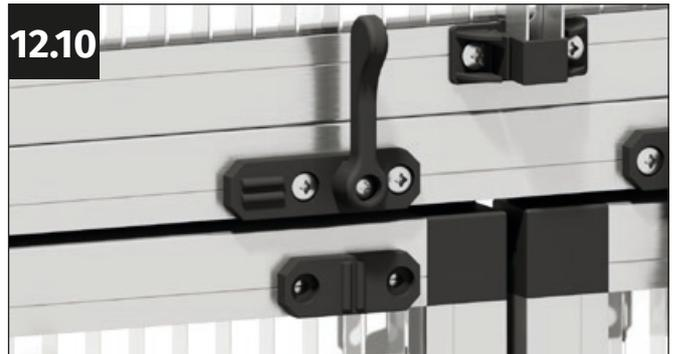
Gira la palanca del pestillo hacia arriba. Coloca la placa de cierre de modo que las dos muescas de cierre queden exactamente debajo de la unión atornillada del gancho de cierre.
