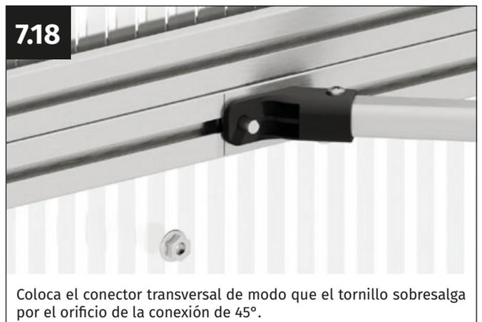
Coloca el conector transversal de modo que el tornillo sobresalga por el orificio de la conexión de 45°.
