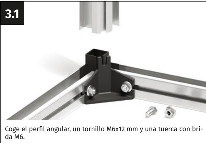
Coge el perfil angular, un tornillo M6x12 mm y una tuerca con brida M6.
