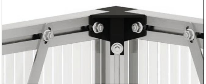
Coloca la protección sobre el tornillo M6x12 mm de modo que sobresalga por el agujero perforado en la protección. Atornilla firmemente la protección contra el viento con una tuerca con brida M6.
