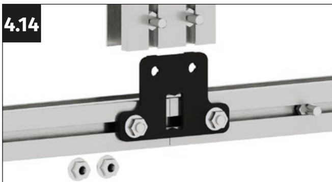
Introduce un tornillo M6x12 mm en cada uno de los dos canales para tornillos del perfil central.
