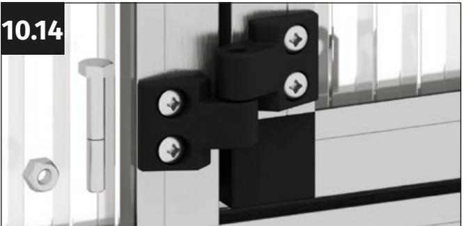
Utiliza un tornillo M6x40 mm y una tuerca autoblocante M6. Coloca la hoja de la puerta en las bisagras del invernadero, de modo que los agujeros queden exactamente alineados.
