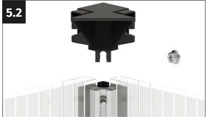
Introduce el tornillo M6x12 mm en el canal para tornillos del perfil angular.
