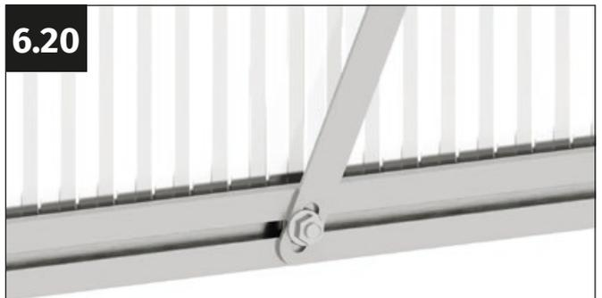
Coloca la protección sobre el tornillo M6x12 mm de modo que sobresalga por el agujero perforado en la protección. Atornilla sin apretar la protección contra el viento con una tuerca con brida M6.
