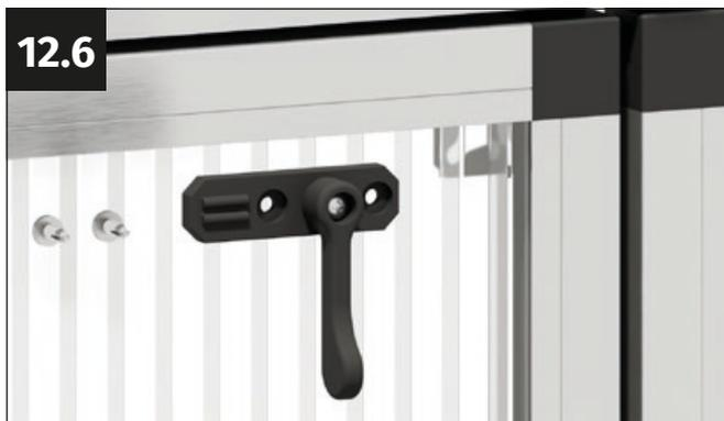
Coge el pestillo de la puerta preparado y dos tornillos autopercorante de 4,8x13 mm.
