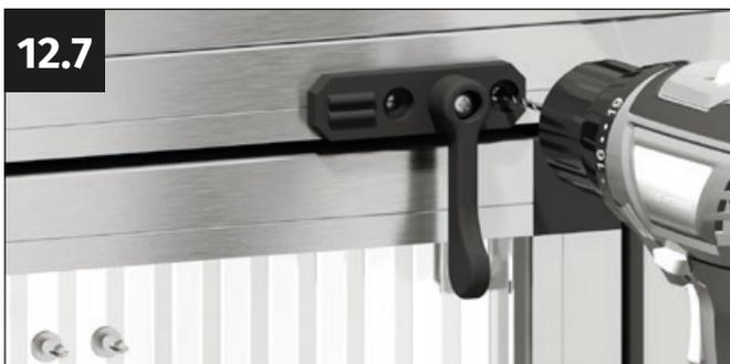
Coloca el pestillo de la puerta en el perfil superior del invernadero, de modo que el extremo del pestillo quede ligeramente junto al conector angular de la hoja de la puerta. Pretaladra los agujeros con una broca de 4 mm.
