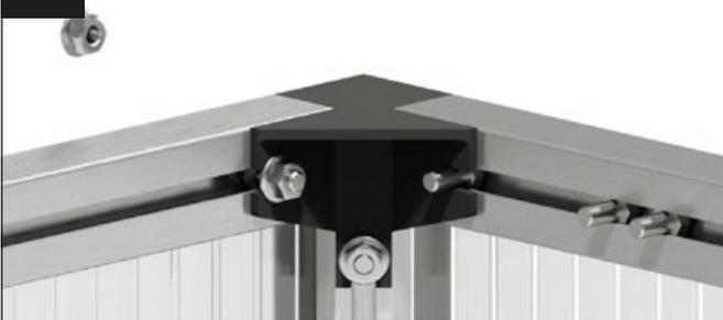
Coloca el perfil del marco frontal en el soporte angular y coloca un tornillo M6x12 mm en su hueco.
