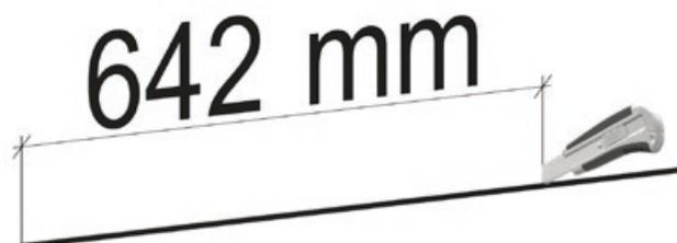
Utiliza una cuchilla para alfombras para cortar dos trozos de junta de cepillo con una longitud de 642 mm.
