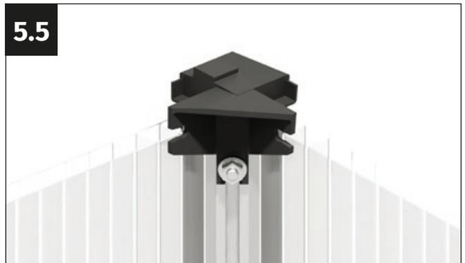
Coloca el soporte de esquina en el perfil angular y coloca el tornillo M6x12 en el hueco.
