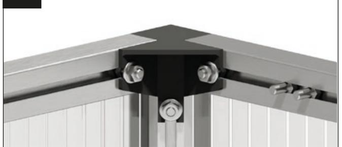
Presiona firmemente el soporte de esquina contra el perfil superior del marco y atornilla firmemente el perfil superior del marco con una tuerca con brida M6.
