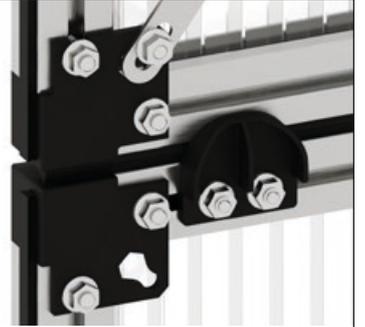
Coloca el tope de la puerta sobre los tornillos y alinéalo de modo que quede justo al lado del conector angular de la hoja de la puerta. Atornilla el tope de la puerta con dos tuercas con brida M6.
