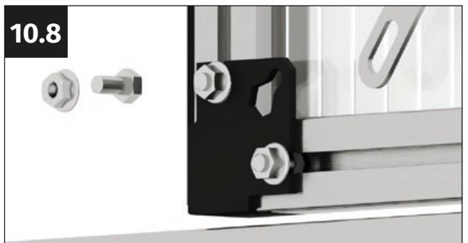
Para atornillar el conector transversal al conector de plástico diagonalmente opuesto, utiliza un tornillo M6x12 mm y una tuerca con brida M6.
