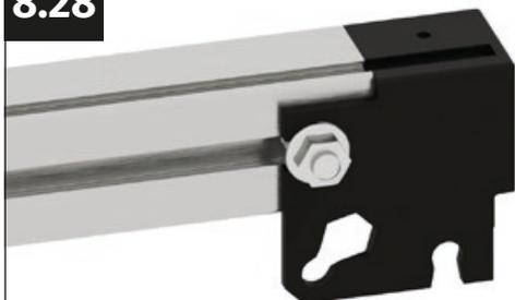
Presiona firmemente el conector angular contra el perfil lateral de la puerta y atorníllalo firmemente con la tuerca con brida M6.
