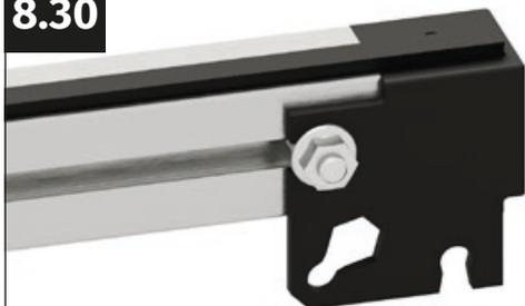
Inserta la junta de cepillo en el perfil de la puerta lateral por el exterior. Empuja la junta de cepillo hacia dentro hasta que toque la moldura del conector angular del otro lado del perfil de la puerta.
