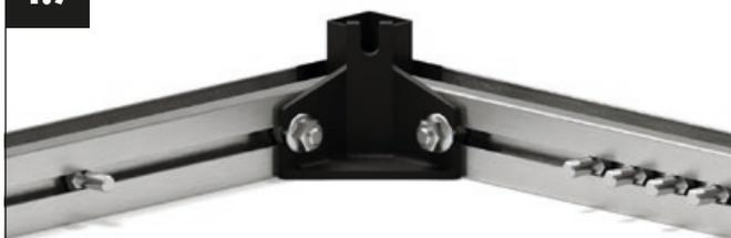
Comprueba que los perfiles de suelo se tocan firmemente contra las esquinas inferiores y atorníllalas firmemente con las tuercas con brida M6.
