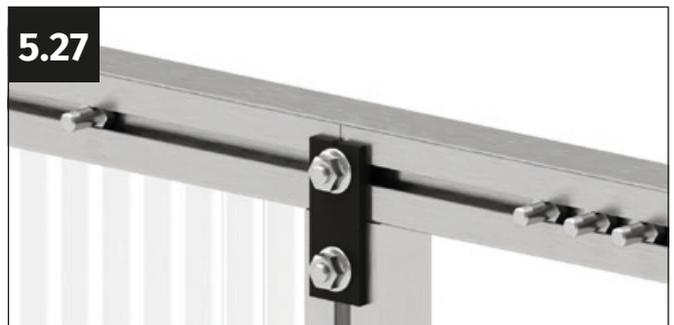
Alinea el conector recto de modo que la marca en V del centro del conector apunte exactamente a la marca del conector. Atornilla bien el conector con dos tuercas con brida M6.
