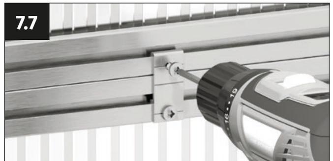
Atornilla el gancho de conexión con los dos tornillos autoperforantes de 4,8 x 13 mm. Aunque se utilicen tornillos autoperforantes, recomendamos pretaladrar los agujeros con una broca de 4 mm.
