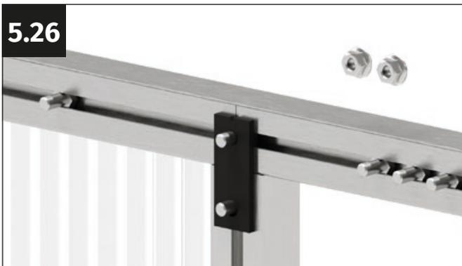
Coloca el conector recto de modo que sobresalga un tornillo M6x12 mm por cada uno de los orificios del conector.
