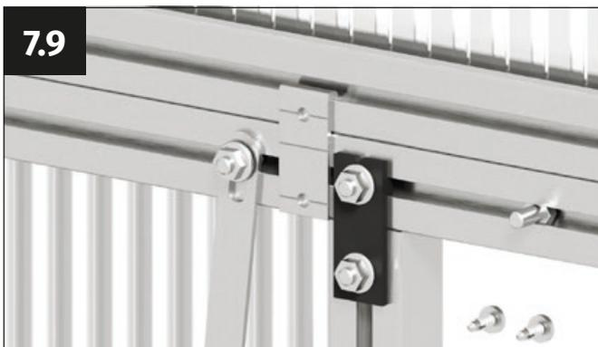
Coloca el gancho de conexión entre la protección contra el viento y el conector recto de la pared frontal.
