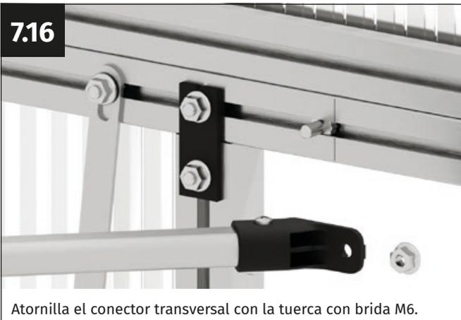
Atornilla el conector transversal con la tuerca con brida M6.
