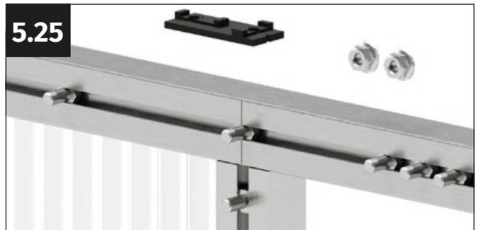
Coloca los tornillos del perfil del marco superior. Asegúrate de que quede libre un tornillo M6x12 mm entre el panel lateral y el conector. Dos tornillos M6x12 mm quedan libres en el lado del hueco de la puerta.
