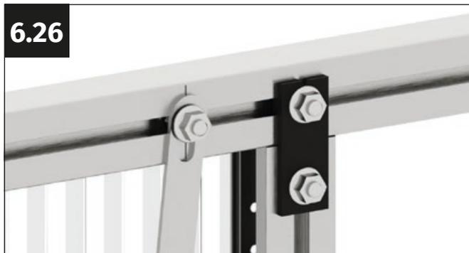
Coloca la protección sobre el tornillo M6x12 mm de modo que sobresalga por el agujero perforado en la protección. Atornilla la protección contra el viento con una tuerca con brida M6.
