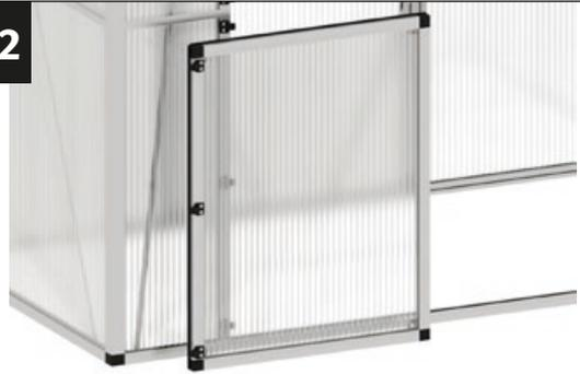
Coloca la hoja de la puerta en la posición correcta y asegúrate de que las bisagras apunten en la dirección del perfil de entrada de la puerta.
