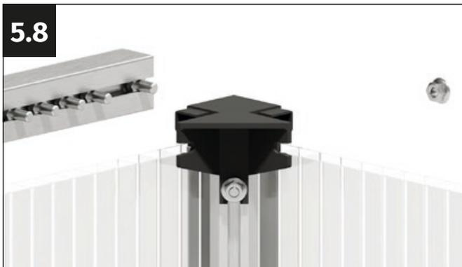
Introduce los cinco tornillos M6x12 mm en el canal para tornillos del perfil de soporte delantero.
