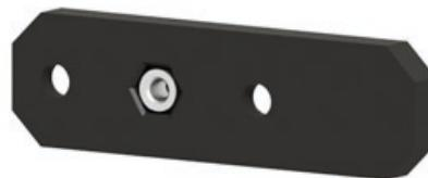
Inserta la tuerca autobloqueante M4 en el hueco de la placa de montaje del pestillo de la puerta. El anillo azul de la tuerca debe apuntar hacia atrás.
