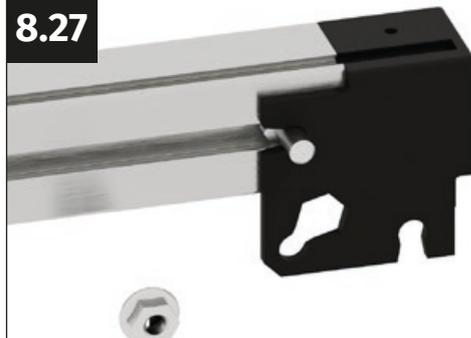
Fija el conector angular al perfil lateral de la puerta. Introduce un tornillo M6x12 mm en el hueco del conector angular.
