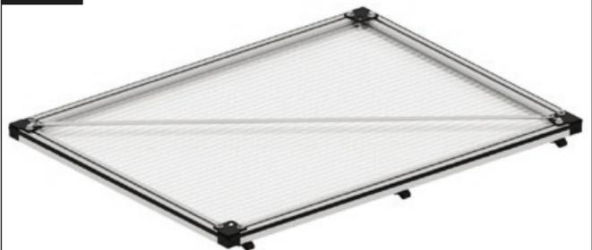
Coge la hoja de la puerta preparada y colócala plana sobre una superficie, de modo que el lado con el conector transversal quede hacia arriba.
