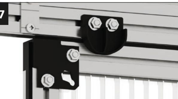
Coloca el tope de la puerta sobre los tornillos y alinéalo de modo que quede justo al lado del conector angular de la hoja de la puerta. Atornilla el tope de la puerta con dos tuercas con brida M6.
