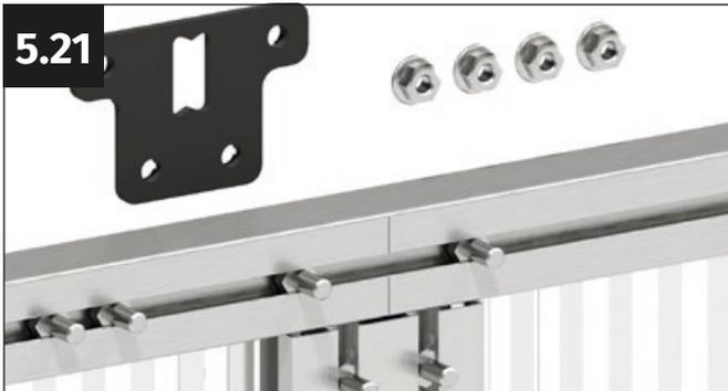
Coloca los tornillos introducidos anteriormente en la marca del perfil del marco superior. Asegúrate de que quedan dos tornillos libres entre el panel lateral y el perfil de acoplamiento.
