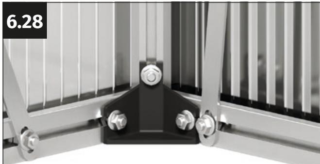
Coloca la protección sobre el tornillo M6x12 mm de modo que sobresalga por el agujero perforado en la protección. Atornilla sin apretar la protección contra el viento con una tuerca con brida M6.
