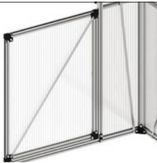
En el siguiente paso, coloca un refuerzo diagonal en la hoja de la puerta para evitar que ésta se hunda durante el uso e impida que la puerta se cierre correctamente.
