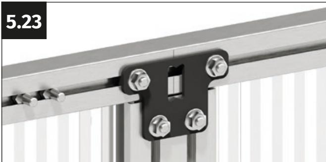
Alinea el conector doble de modo que la marca en V del centro del conector doble apunte exactamente a la marca. Atornilla firmemente el conector doble con cuatro tuercas de brida M6.
