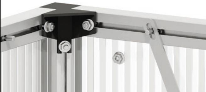
Coloca la protección contra el viento sobre el tornillo M6x12 mm de modo que sobresalga por el agujero perforado en la protección.
