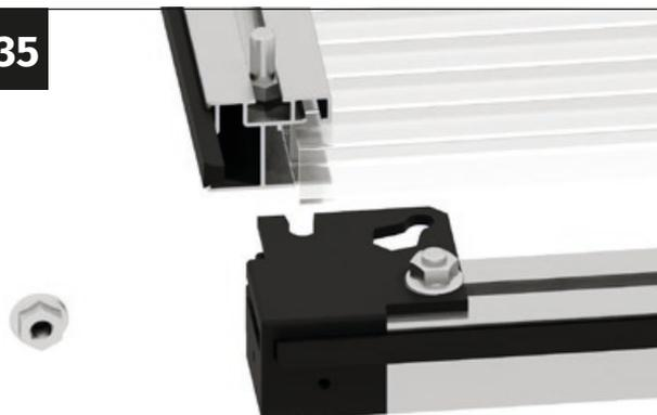
Introduce el tornillo M6x12 en cada lado en el canal para tornillos de los perfiles de puerta.
