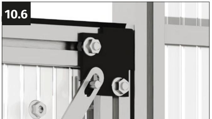
Coloca el conector diagonal de modo que el tornillo M6x12 mm sobresalga por el orificio ranurado del conector.
