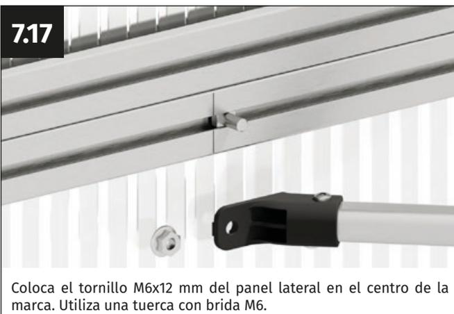
Coloca el tornillo M6x12 mm del panel lateral en el centro de la marca. Utiliza una tuerca con brida M6.
