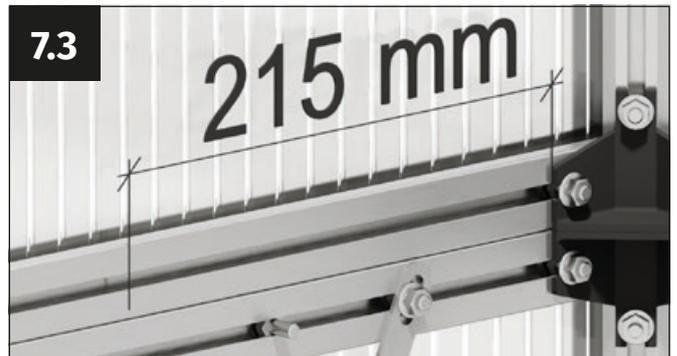
Para montar los ganchos de conexión laterales traseros, mide 215 mm hacia dentro desde el extremo del conector. Haz una marca.
