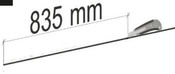
Corta un trozo de junta de cepillo de 835 mm de longitud con una cuchilla para moquetas.
