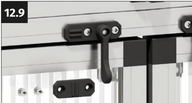
Ahora la placa del pestillo está colocada debajo del pestillo de la puerta. Coge la placa del pestillo de la puerta (ref. 2320) y dos tornillos autoperforantes de 4,8x13 mm.
