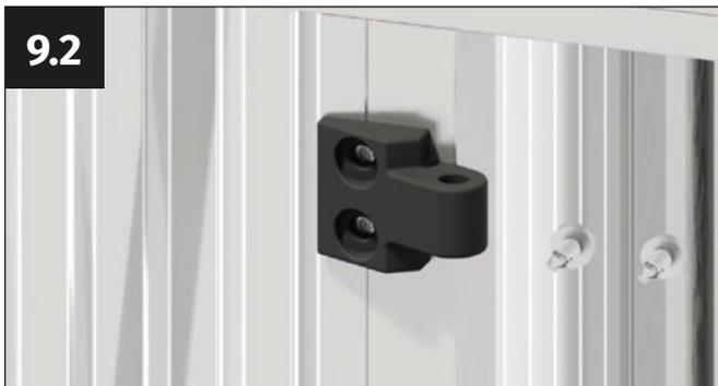
Coloca la bisagra en el perfil de entrada de la puerta de modo que los agujeros de la bisagra queden alineados con los agujeros del perfil de entrada de la puerta.
