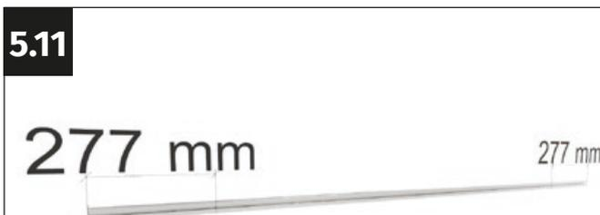
Coge el perfil del marco superior para la pared delantera. Mide 277 mm hacia el interior desde el borde de cortado del perfil y haz una marca.
