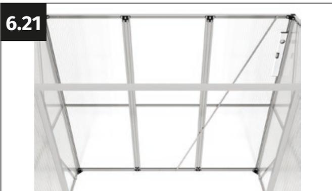
Alinea la pared trasera exactamente de manera vertical con un nivel de burbuja y luego aprieta la tuerca con brida M6.
