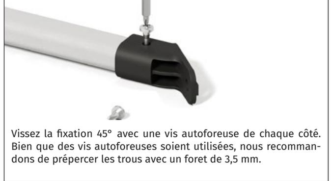
Vissez la fixation 45° avec une vis autoforeuse de chaque côté. Bien que des vis autoforeuses soient utilisées, nous recommandons de prépercer les trous avec un foret de 3,5 mm.
