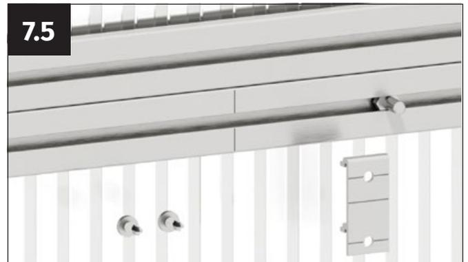
Prenez le crochet de connexion ainsi que deux vis autoforeuses 4,8 x 13 mm.
