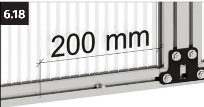
Sur le profilé inférieur, mesurez 200 mm à partir du double connecteur vers l'intérieur et placez un repère à cet endroit.
