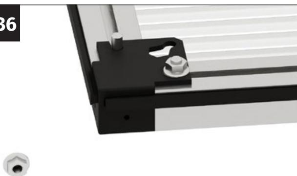
Emboîtez le profilé de porte latéral avec les équerres en plastique sur les profilés de porte. Introduisez une vis M6x12 mm dans le creux de chaque équerre d'angle en plastique.
