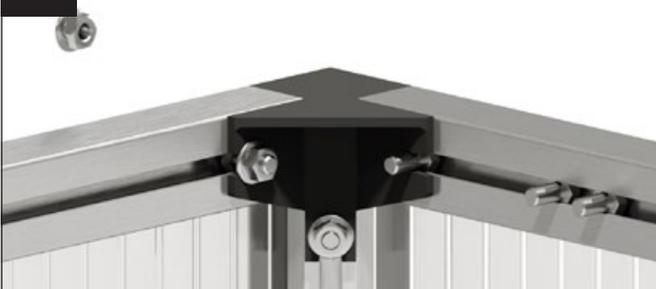
Emboîtez le profilé de cadre avant sur l'équerre d'angle et positionnez une vis M6x12 mm dans son évidement.
