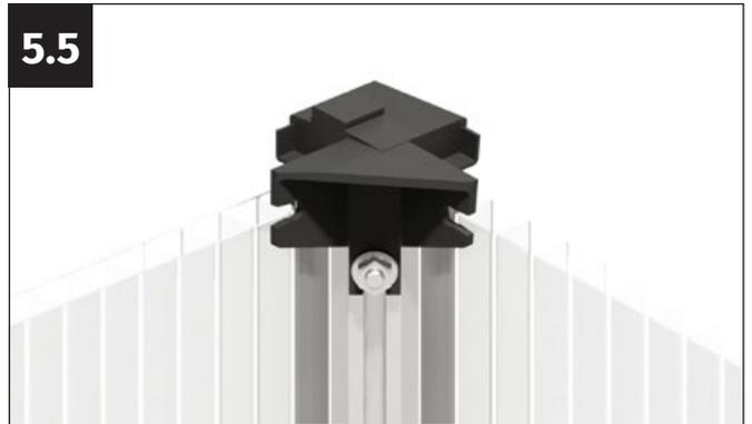
Placez l'équerre d'angle sur le profilé d'angle et positionnez la vis M6x12 dans son évidement.
