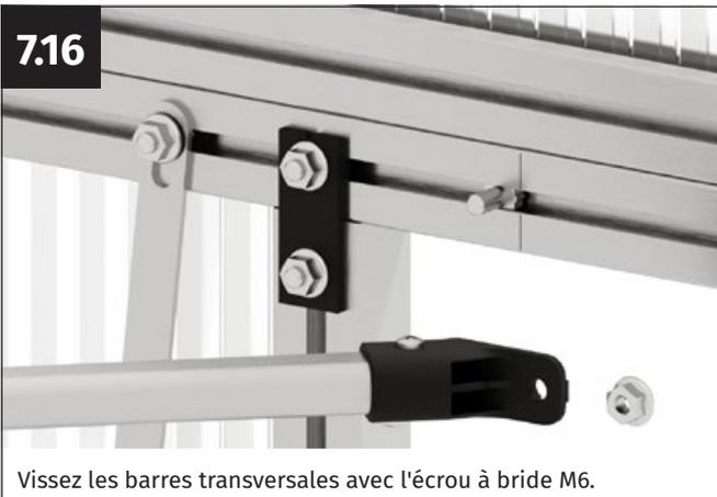
Vissez les barres transversales avec l'écrou à bride M6.
