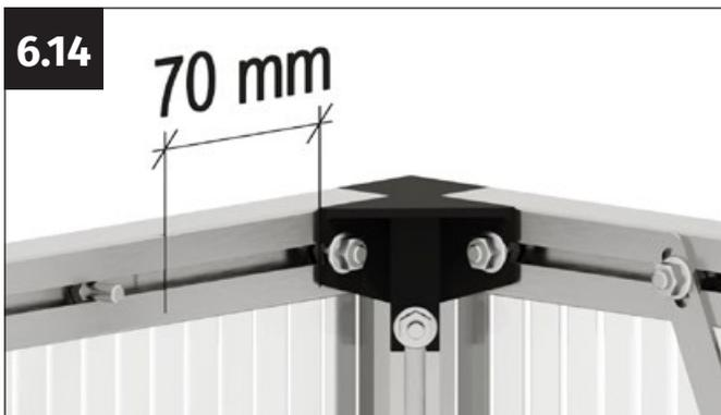
Mesurez sur le profilé supérieur 70 mm à partir du connecteur d'angle vers l'intérieur et placez un repère à cet endroit.
