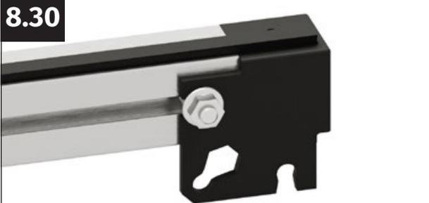
Introduisez le joint brosse du côté extérieur dans le profilé de porte latéral. Insérez le joint brosse jusqu'à ce qu'il se trouve dans la forme du raccord d'angle de l'autre côté du profilé de porte.
