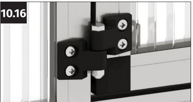
Fixez la vis M6x40 mm avec un écrou autobloquant. Remarque : l'écrou ne doit pas être serré à fond, sinon le vantail de porte ne pourra plus tourner.
