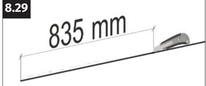
Découpez un morceau de joint-brosse d'une longueur de 835 mm à l'aide d'un cutter.
