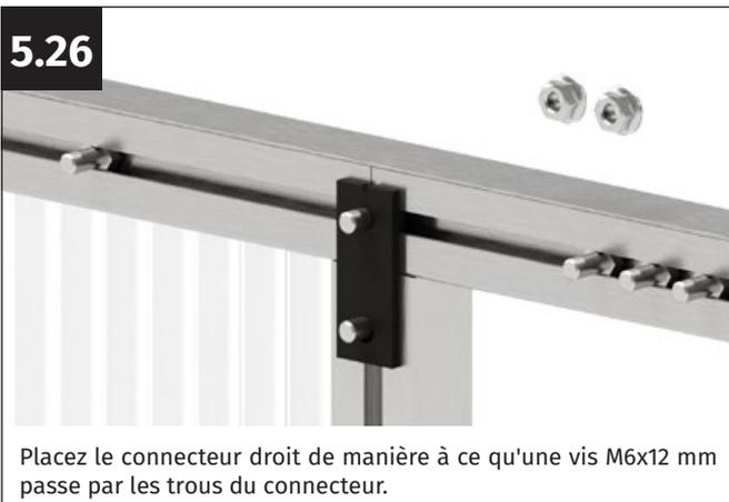
Placez le connecteur droit de manière à ce qu'une vis M6x12 mm passe par les trous du connecteur.
