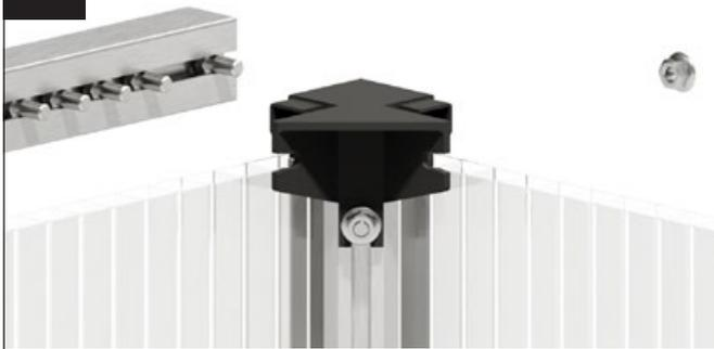
Introduisez les cinq vis M6x12 mm dans le canal de vissage du profilé d'appui avant.
