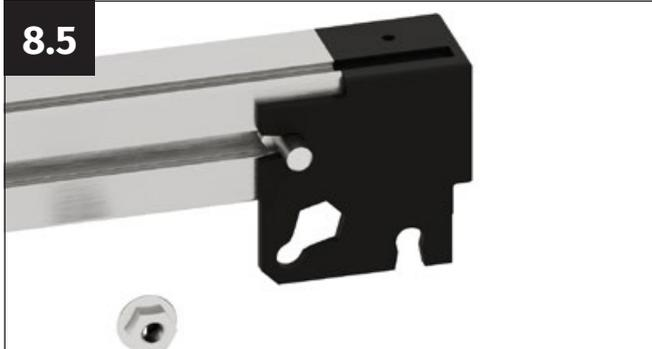
Emboîtez le connecteur d'angle sur le profilé latéral de la porte. Introduisez une vis M6x12 mm dans l'évidement du connecteur d'angle.
