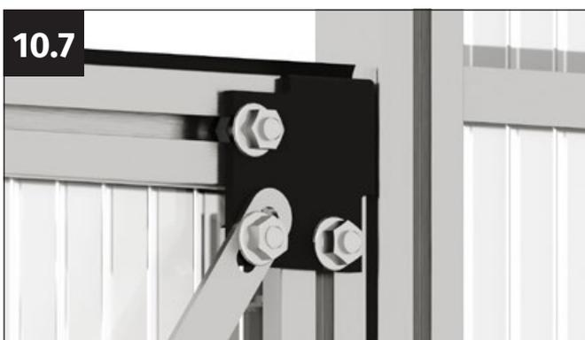
Vissez le connecteur diagonal avec un écrou à bride M6. Ne serrez pas l'écrou à fond !
