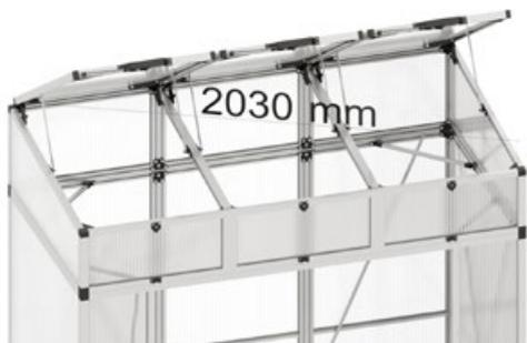
Alignez la cabane à tomates en contrôlant les diagonales. Les deux diagonales doivent avoir exactement la même longueur, la construction sera alors en inclinée. La diagonale doit être de 2 030 mm.
