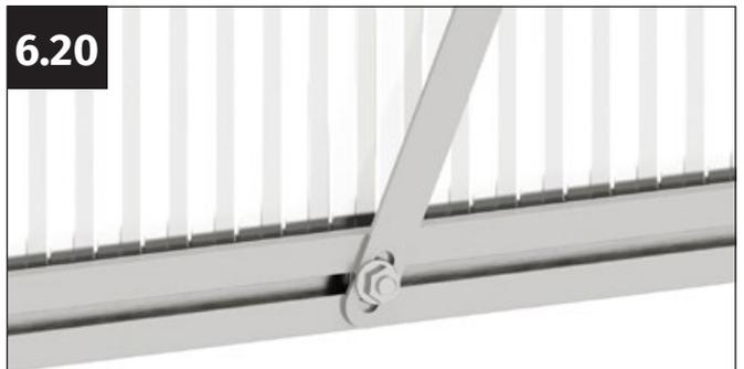
Placez le contreventement sur la vis M6x12 mm de manière à ce qu'il dépasse du trou perforé du contreventement. Vissez le contreventement sans serrer avec un écrou à bride M6.
