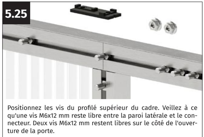
Positionnez les vis du profilé supérieur du cadre. Veillez à ce qu'une vis M6x12 mm reste libre entre la paroi latérale et le connecteur. Deux vis M6x12 mm restent libres sur le côté de l'ouverture de la porte.
