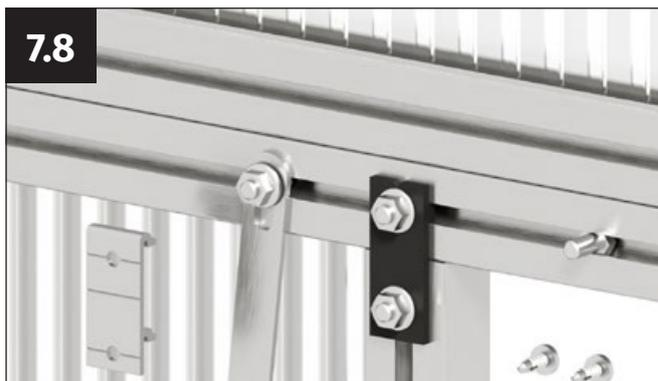
Pour la paroi avant, utilisez le crochet de connexion et deux vis autoforeuses 4,8 x 13 mm.
