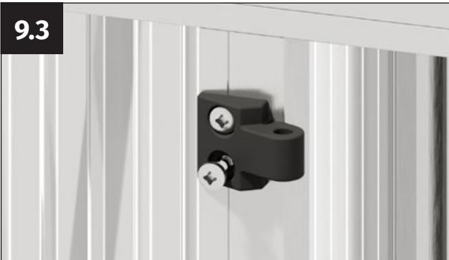
Vissez fermement la charnière avec les vis à tôle autoforeuses 4,8x13 mm.
