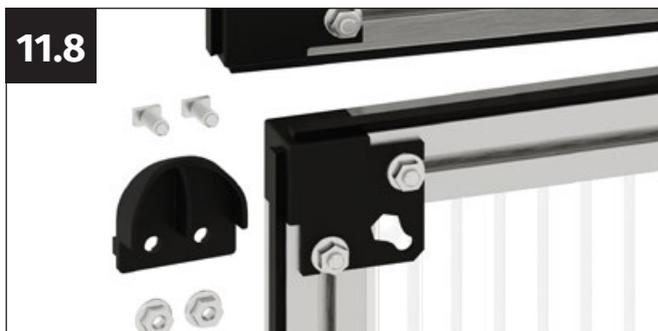
Pour finir, installez également une butée de porte au milieu des deux battants de porte sur le battant inférieur. Pour cela, munissez-vous d'une butée de porte, de deux vis en losange et de deux écrous à bride M6.
