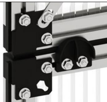
Placez la butée de porte sur les vis et orientez-la de manière à ce qu'elle soit positionnée juste à côté du raccord d'angle du vantail de porte. Vissez la butée de porte avec deux écrous à bride M6.
