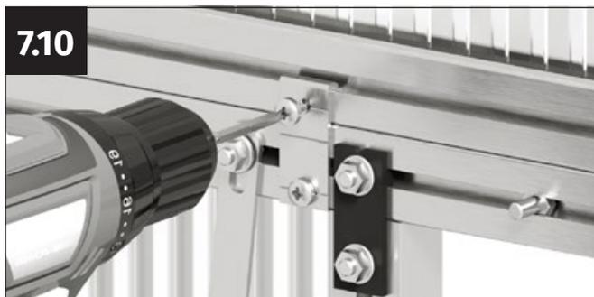
Vissez le crochet de liaison avec les deux vis autoforeuses 4,8 x 13 mm. Bien que des vis autoperceuses soient utilisées, nous recommandons de prépercer les trous avec un foret de 4 mm.
