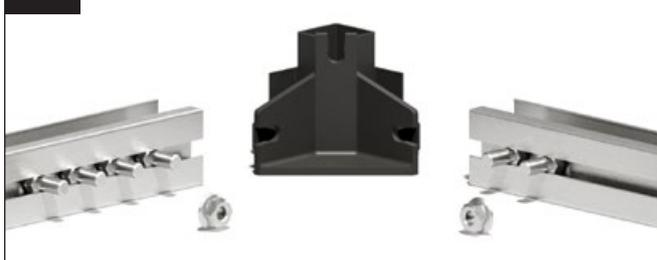
Introduisez deux vis M6x12 mm dans le canal de vissage du profilé de sol de la paroi latérale et quatre vis M6x12 mm dans le canal de vissage du profilé de sol de la paroi arrière.
