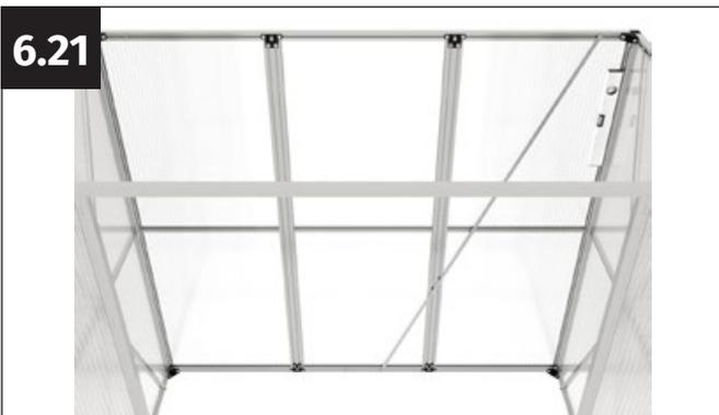
Alignez la paroi arrière exactement à l'aplomb et serrez ensuite l'écrou à bride M6.
