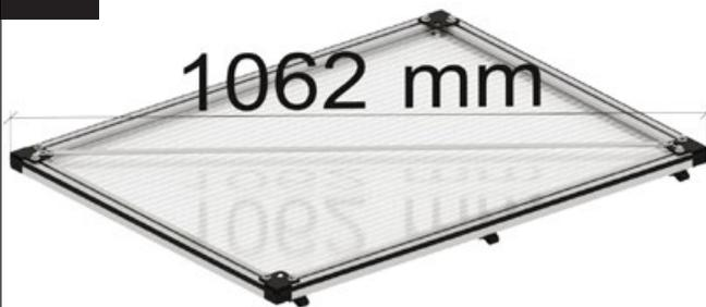
Alignez le vantail de la porte exactement selon l'angle. Pour cela, mesurez les diagonales : elles doivent mesurer exactement 1 062 mm chacune !
