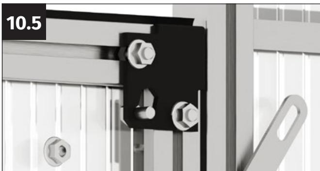
Introduisez la vis M6x12 mm dans le trou du connecteur d'angle et poussez la vis vers le bas, dans sa position finale.
