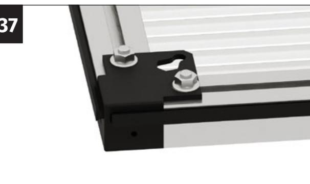
Appuyez fermement sur l'équerre d'angle en plastique contre le profilé de porte et vissez-la fermement avec l'écrou à bride M6.
