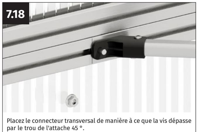
Placez le connecteur transversal de manière à ce que la vis dépasse par le trou de l'attache 45°.
