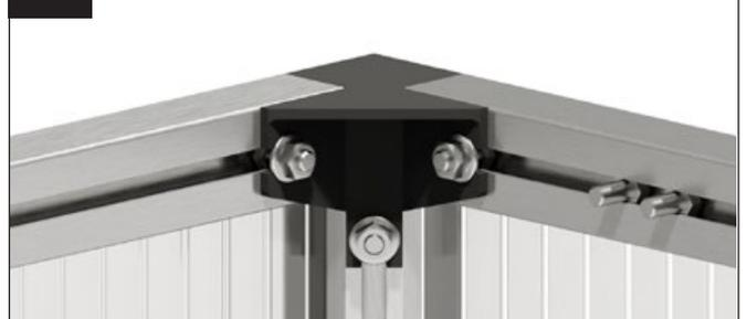
Appuyez fermement l'équerre d'angle contre le profilé supérieur du cadre et vissez fermement le profilé supérieur du cadre avec l'écrou à bride M6.
