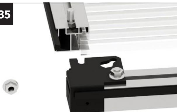
Introduisez de chaque côté la vis M6x12 dans le canal de vissage des profilés de porte.
