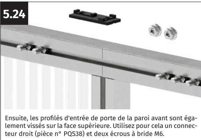
Ensuite, les profilés d'entrée de porte de la paroi avant sont également vissés sur la face supérieure. Utilisez pour cela un connecteur droit (pièce n° PQS38) et deux écrous à bride M6.
