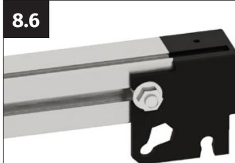
Appuyez fermement le connecteur d'angle contre le profilé latéral de la porte et vissez-le fermement avec l'écrou à bride M6.
