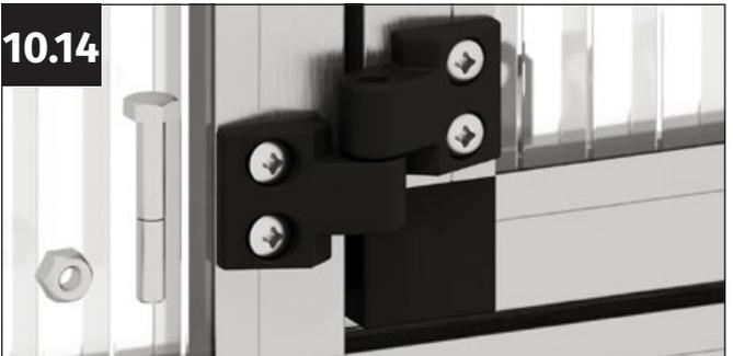
Munissez-vous d'une vis M6x40 mm et d'un écrou autobloquant M6. Placez le battant de la porte sur les charnières de la serre à tomates de manière à ce que les trous soient exactement superposés.
