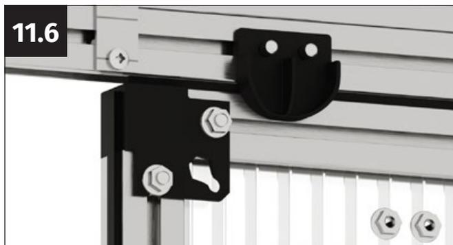
Déplacez les vis M6x12 mm vers l'extérieur du vantail de porte. Placez la butée de porte sur les deux vis.
