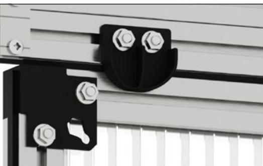
Placez la butée de porte sur les vis et orientez-la de manière à ce qu'elle soit positionnée juste à côté du raccord d'angle du vantail de porte. Vissez la butée de porte avec deux écrous à bride M6.
