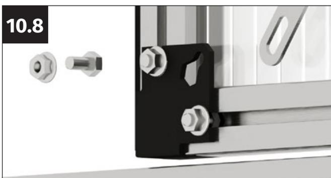
Pour visser le connecteur transversal sur le connecteur plastique en diagonale, munissez-vous d'une vis M6x12 mm et d'un écrou à bride M6.
