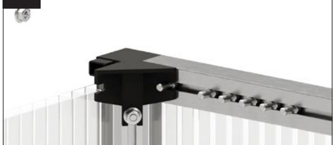
Emboîtez le profilé de cadre avant sur l'équerre d'angle et positionnez une vis M6x12 mm dans son évidement.
