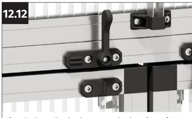
Vissez la plaque d'enclenchement avec les deux vis autoforeuses 4,8x13 mm.
