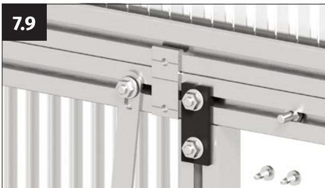
Positionnez le crochet de connexion entre le contreventement et le connecteur droit de la paroi avant.
