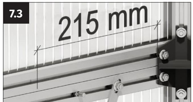
Pour le montage des crochets de liaison latéraux arrière, mesurez 215 mm à partir de l'extrémité du connecteur vers l'intérieur. Faites une marque ici.
