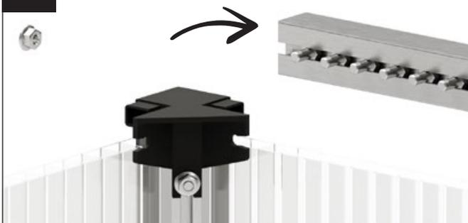
Introduisez les six vis M6x12 mm dans le canal de vissage du profilé d'appui avant.
