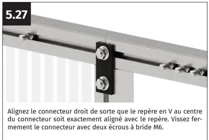
Alignez le connecteur droit de sorte que le repère en V au centre du connecteur soit exactement aligné avec le repère. Vissez fermement le connecteur avec deux écrous à bride M6.
