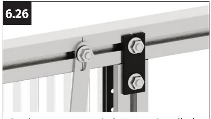
Placez le contreventement sur la vis M6x12 mm de manière à ce qu'il dépasse du trou perforé du contreventement. Vissez le contreventement avec un écrou à bride M6.
