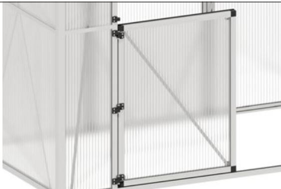
L'étape suivante consiste à monter le vantail de la porte sur la serre à tomates.
