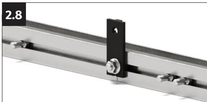
Alignez le connecteur droit de sorte que le repère en V au centre du connecteur soit exactement aligné avec le repère. Vissez fermement le connecteur avec un écrou à bride M6.
