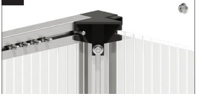
Emboîtez le profilé de cadre sur l'équerre d'angle et positionnez une vis M6x12 mm dans son évidement.
