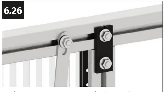
Posizionare la controventatura sulla vite M6x12 mm in modo che questa sporga dal foro della controventatura. Avvitare la controventatura con un dado flangiato M6.
