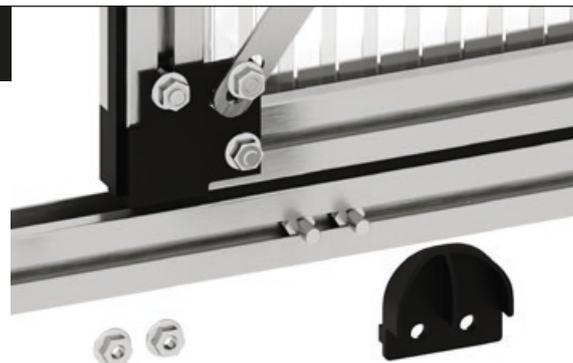
Spostare le viti M6x12 mm sul profilo del pavimento verso l'esterno del battente.
