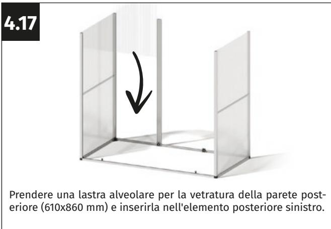
Prendere una lastra alveolare per la vetratura della parete posteriore (610x860 mm) e inserirla nell'elemento posteriore sinistro.
