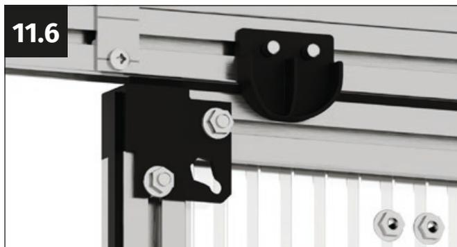
Spostare le viti M6x12 mm verso l'esterno dell'anta della porta. Posizionare il fermaporta sulle due viti.
