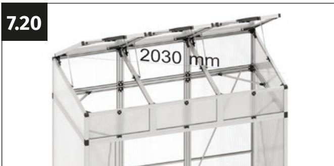
Allineare la serra per pomodori controllando le diagonali. Entrambe le diagonali devono essere della stessa lunghezza, altrimenti la costruzione pende. La diagonale deve essere di 2030 mm.
