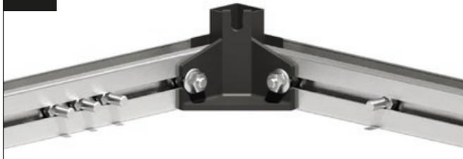
Controllare che i profili del pavimento siano ben saldi contro la staffa angolare inferiore e avvitare saldamente i profili del pavimento con i dadi flangiati M6.
