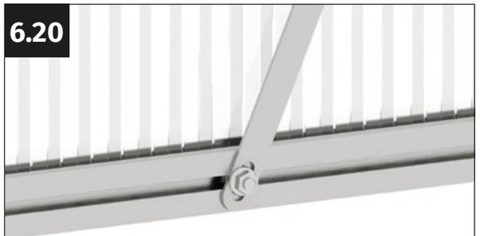
Posizionare la controventatura sulla vite M6x12 mm in modo che questa sporga dal foro della controventatura. Avvitare la controventatura con un dado flangiato M6.
