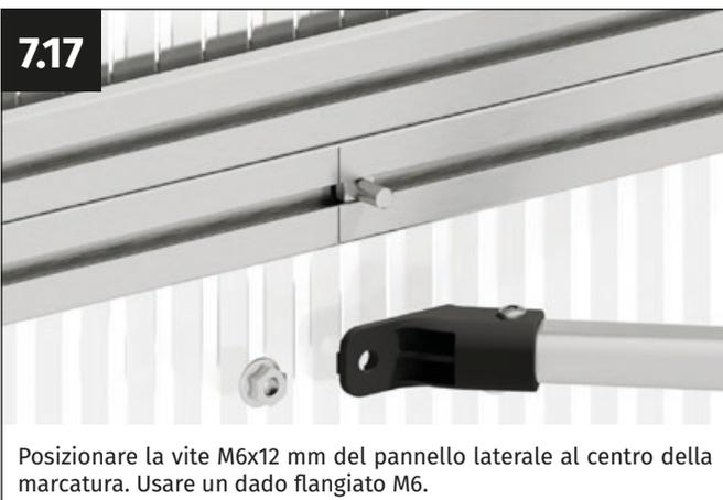
Posizionare la vite M6x12 mm del pannello laterale al centro della marcatura. Usare un dado flangiato M6.
