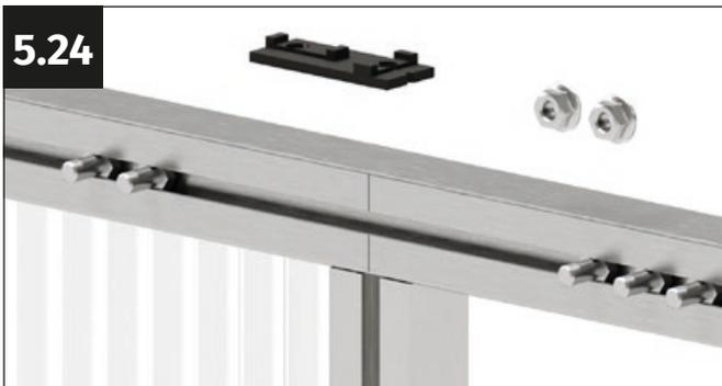
Ora i profili di ingresso della porta della parete anteriore vengono avvitati alla parte superiore. Utilizzare un connettore diritto (codice PQS38) e due dadi flangiati M6.
