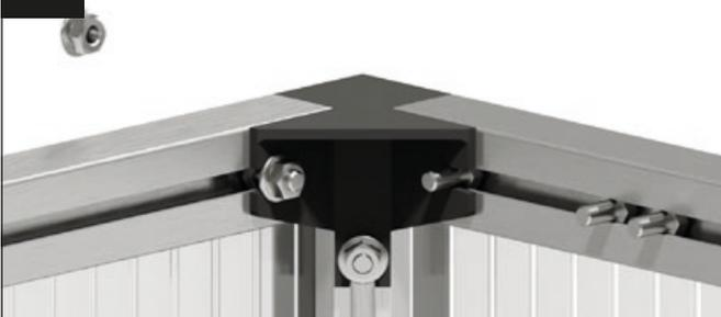
Posizionare il profilo del telaio anteriore sulla staffa d'angolo e inserire una vite M6x12 mm nell'incavo.
