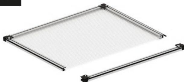
Fissare ora il profilo laterale della porta al profilo superiore e inferiore della porta. Le fasi seguenti vengono eseguite in parallelo su entrambi i lati.
