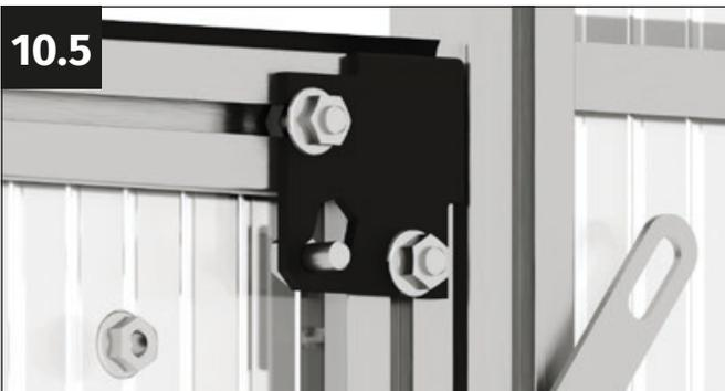
Inserire la vite M6x12 mm attraverso il foro del connettore angolare e premere la vite nella sua posizione finale.
