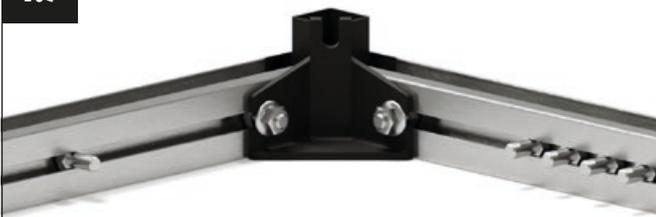
Controllare che i profili del pavimento siano ben saldi contro la staffa angolare inferiore e avvitare saldamente i profili del pavimento con i dadi flangiati M6.
