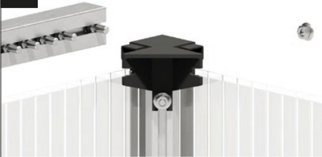
Inserire le cinque viti M6x12 mm nel canale del profilo di supporto anteriore.
