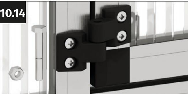
Usare una vite M6x40 mm e un dado autobloccante M6. Posizionare l'anta della porta sui cardini della serra in modo che i fori siano esattamente uno sopra l'altro.
