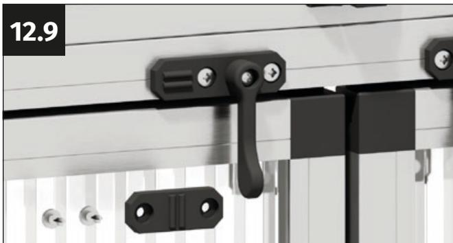
La piastra di chiusura è ora montata sotto la serratura della porta. Prendere la piastra di chiusura della porta (codice 2320) e 2 viti autopercoranti da 4,8x13 mm.
