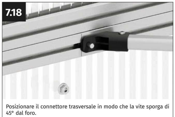
Posizionare il connettore trasversale in modo che la vite sporga di 45° dal foro.
