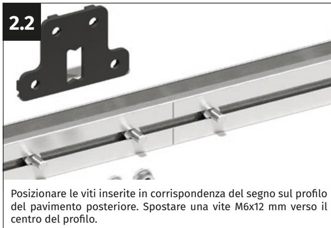
Posizionare le viti inserite in corrispondenza del segno sul profilo del pavimento posteriore. Spostare una vite M6x12 mm verso il centro del profilo.
