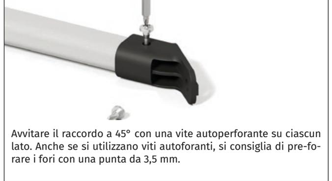
Avvitare il raccordo a 45° con una vite autoperforante su ciascun lato. Anche se si utilizzano viti autoforanti, si consiglia di preforare i fori con una punta da 3,5 mm.
