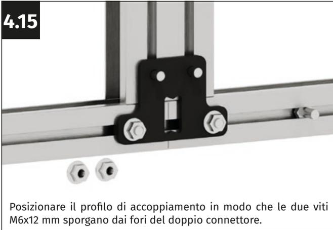
Posizionare il profilo di accoppiamento in modo che le due viti M6x12 mm sporgano dai fori del doppio connettore.
