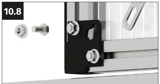
Avvitare il connettore a croce al connettore di plastica diagonale con una vite M6x12 mm e un dado flangiato M6.
