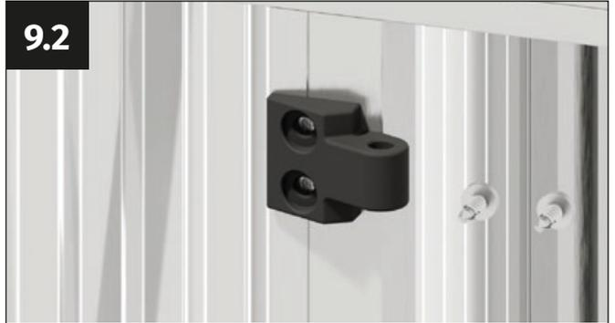
Posizionare la cerniera sul profilo d'ingresso della porta in modo che i fori della cerniera si trovino sopra i fori del profilo d'ingresso della porta.
