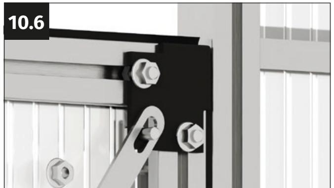
Posizionare il connettore diagonale in modo che la vite M6x12 mm sporga dal foro del connettore.
