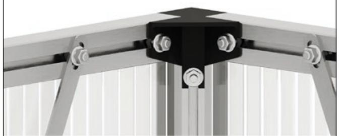
Posizionare la controventatura sulla vite M6x12 mm in modo che questa sporga dal foro della controventatura. Avvitare saldamente la controventatura con un dado flangiato M6.
