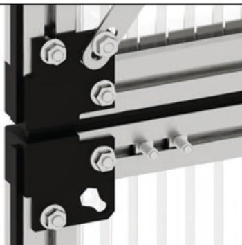
Inserire le viti a rombo nel canale delle viti dell'anta inferiore della porta. Girare le viti in modo che la testa si incastrino nel canale della vite.
