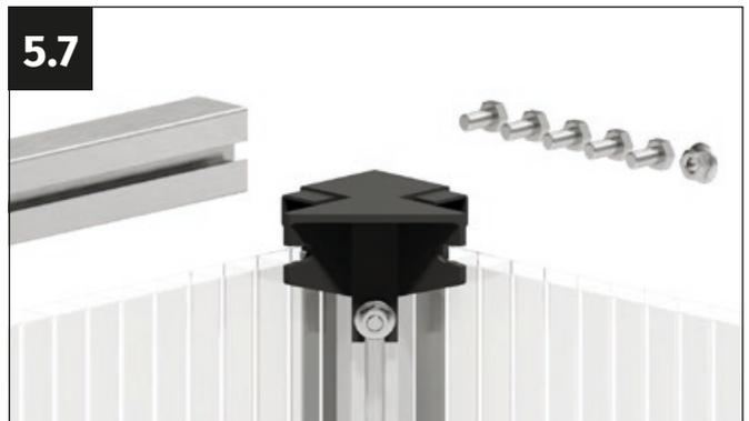
Prendere il profilo del telaio posteriore, cinque viti M6x12 mm e un dado flangiato M6.
