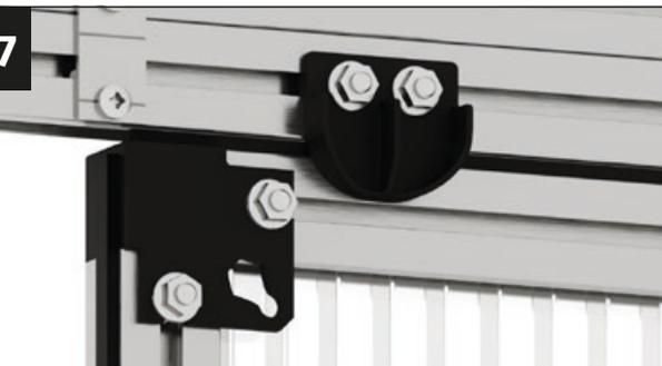
Posizionare il fermaporta sulle viti e allinearlo in modo che sia proprio accanto al connettore angolare dell'anta. Avvitare il fermaporta con due dadi flangiati M6.
