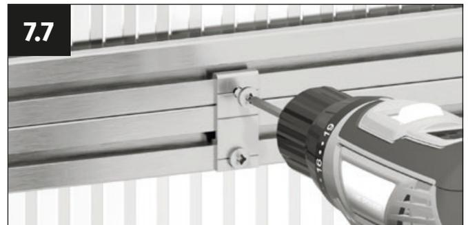
Avvitare il gancio di collegamento alle due viti autoperforanti da 4,8 x 13 mm. Anche se si utilizzano viti autoperforanti, consigliamo di pre-forare i fori con una punta da 4 mm.
