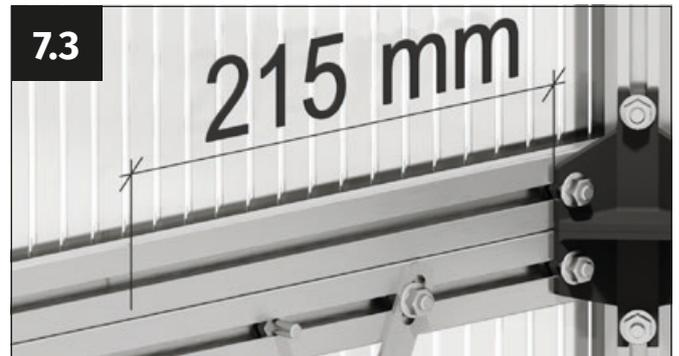
Per montare i ganci di collegamento del lato posteriore, misurare 215 mm verso l'interno dall'estremità del connettore. Fare un segno qui.
