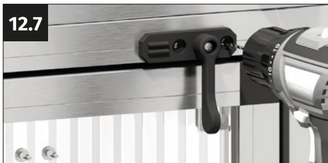
Posizionare la serratura sul profilo superiore della serra in modo che l'estremità della serratura sia vicina al raccordo d'angolo dell'anta. Pre-forare i fori con una punta da 4 mm.
