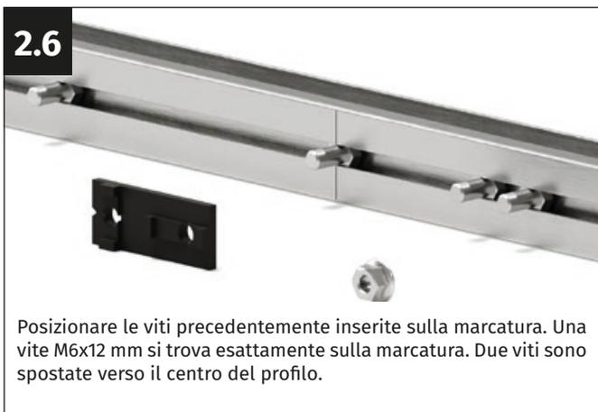
Posizionare le viti precedentemente inserite sulla marcatura. Una vite M6x12 mm si trova esattamente sulla marcatura. Due viti sono spostate verso il centro del profilo.
