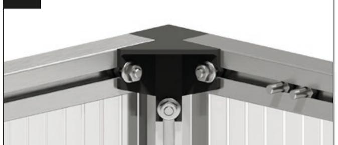
Premere la staffa angolare contro il profilo del telaio superiore e avvitare saldamente il profilo del telaio superiore al dado flangiato M6.
