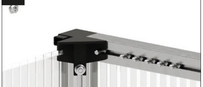
Posizionare il profilo del telaio anteriore sulla staffa d'angolo e inserire una vite M6x12 mm nell'incavo.
