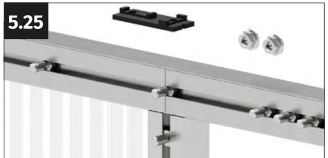
Posizionare le viti del profilo superiore del telaio. Assicurarsi che una vite M6x12 mm rimanga libera tra il pannello laterale e il connettore. Due viti M6x12 mm rimangono libere sul lato dell'apertura della porta.
