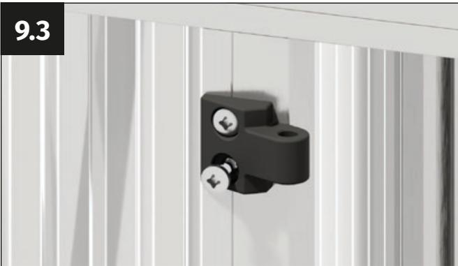
Avvitare saldamente la cerniera in posizione con le viti autofiletanti da 4,8x13 mm.
