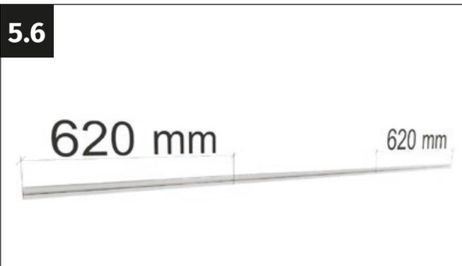
Prendere il profilo superiore del telaio per la parete posteriore. Misurare 620 mm verso l'interno dal bordo tagliato del profilo e fare un segno qui.
