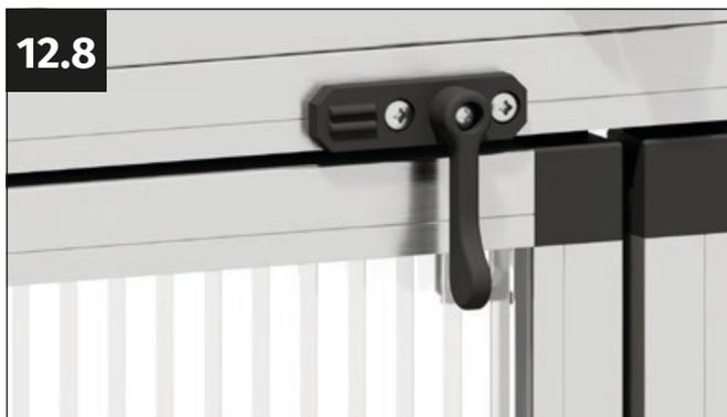
Avvitare la chiusura della porta al suo posto utilizzando le due viti autoforanti da 4,8x13 mm.
