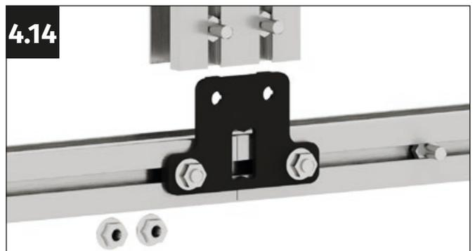
Inserire una vite M6x12 mm in ciascuno dei due canali del profilo centrale.
