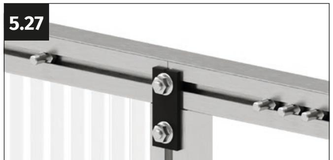
Allineare il connettore dritto in modo che il segno V al centro del connettore punti esattamente al segno sul connettore. Avvitare il connettore con due dadi flangiati M6.
