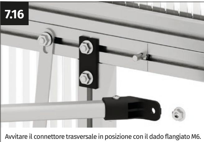
Avvitare il connettore trasversale in posizione con il dado flangiato M6.
