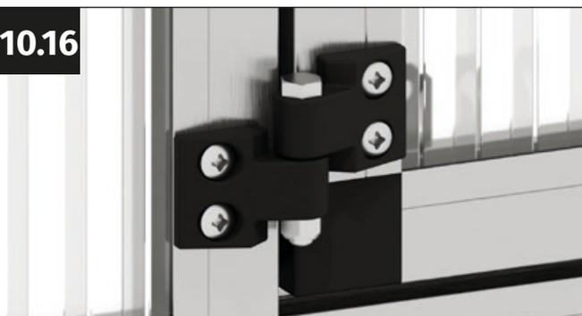
Fissare la vite M6x40 mm con un dado autobloccante. Nota: non stringere il dado, altrimenti il battente non sarà più in grado di girare.
