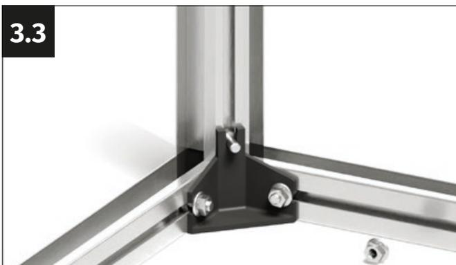
Posizionare il profilo angolare sul supporto angolare inferiore e inserire la vite M6x12 mm nel suo incavo.
