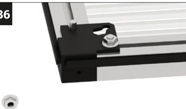
Spingere gli angoli in plastica del profilo laterale della porta sui profili della porta. Inserire una vite M6x12 mm nell'incavo di ciascun angolo in plastica.
