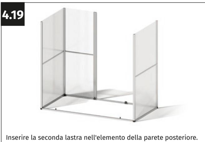
Inserire la seconda lastra nell'elemento della parete posteriore.
