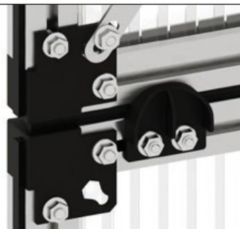
Posizionare il fermaporta sulle viti e allinearlo in modo che sia proprio accanto al connettore angolare dell'anta. Avvitare il fermaporta con due dadi flangiati M6.
