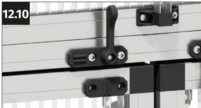
Ruotare la leva di bloccaggio verso l'alto. Posizionare la piastra di chiusura in modo che le due tacche di chiusura si trovino esattamente sotto l'attacco a vite del gancio a scatto.
