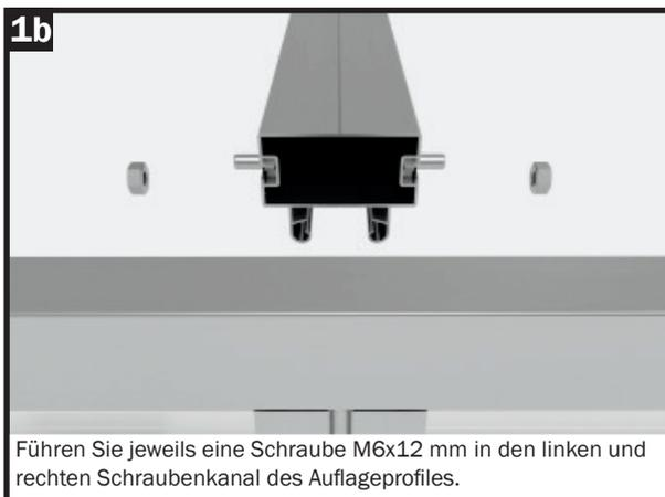
Führen Sie jeweils eine Schraube M6x12 mm in den linken und rechten Schraubenkanal des Auflageprofils.
