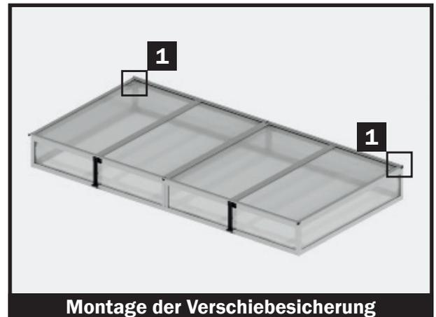
**Die Verschiebesicherung verhindert, dass der Fensterflügel beim laufenden Gebrauch des Frühbeetkastens unkontrolliert nach außen rutscht.**
