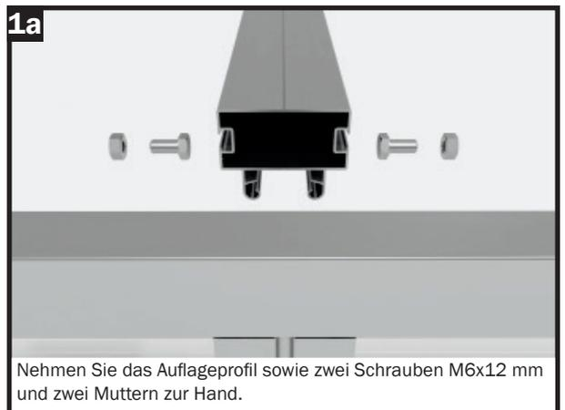
Nehmen Sie das Auflageprofil sowie zwei Schrauben M6x12 mm und zwei Muttern zur Hand.
