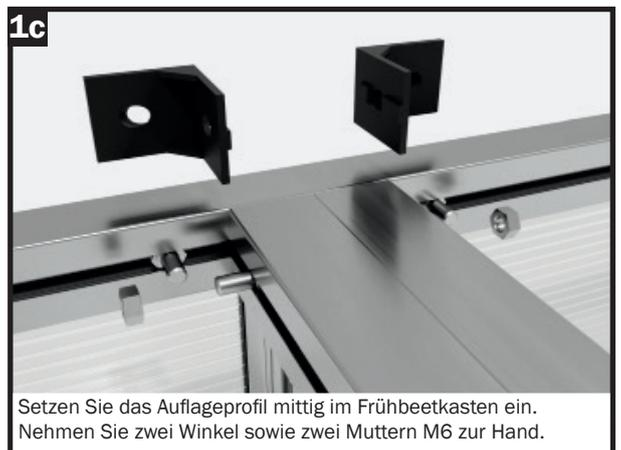
Setzen Sie das Auflageprofil mittig im Frühbeetkasten ein. Nehmen Sie zwei Winkel sowie zwei Muttern M6 zur Hand.
