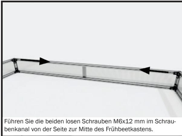
Führen Sie die beiden losen Schrauben M6x12 mm im Schraubenkanal von der Seite zur Mitte des Frühbeetkastens.
