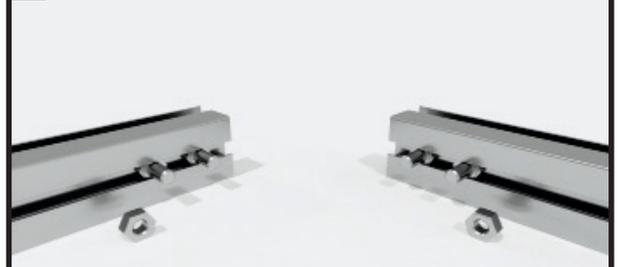
Führen Sie jeweils zwei Schrauben M6x12 mm in den Schraubenkanal der Profile ein.
